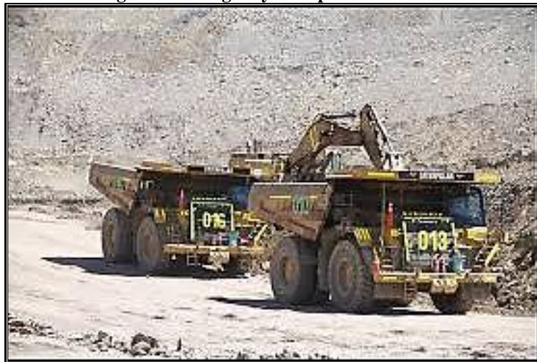
Fotografía 6: Carguío y transporte de desmorte
