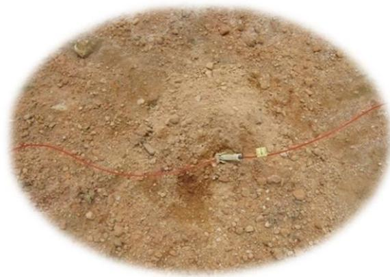
Los amarres pueden ser de diferentes tipos como filas o en V, y para darle la secuencia optima se colocan los retardos entre fila y fila, además dependiendo del proyecto se utiliza un CTD “cero” que inicia la secuencia de salida, también se puede usar el cordón detonante para iniciar varios proyectos, por otro lado, para el chispeo se utiliza la mecha de seguridad.
