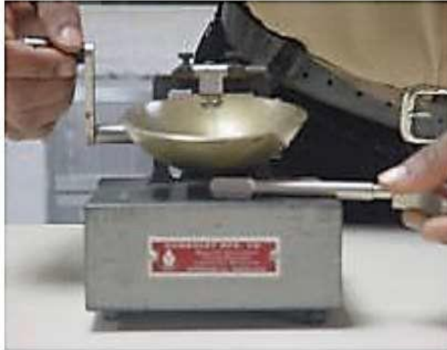
Aparato Casagrande Acondicionado
