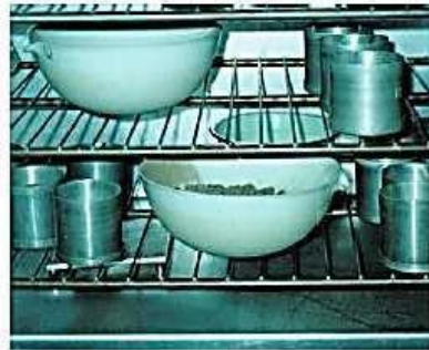
Figura 4. Secado de la muestra en el horno.
