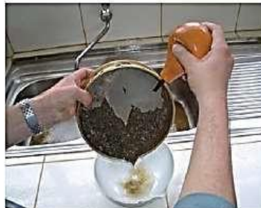
Figura 3. Vertido del material después del lavado.
