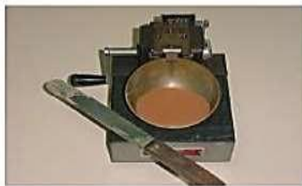
Material colocado uniformemente
