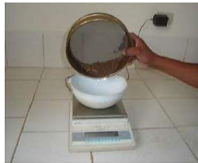
Figura 7. Determinación de la masa retenida en cada tamiz.
