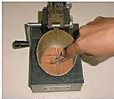
Corte y Retiro del Material
