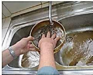
Figura 2. Lavado de la muestra de suelo.
