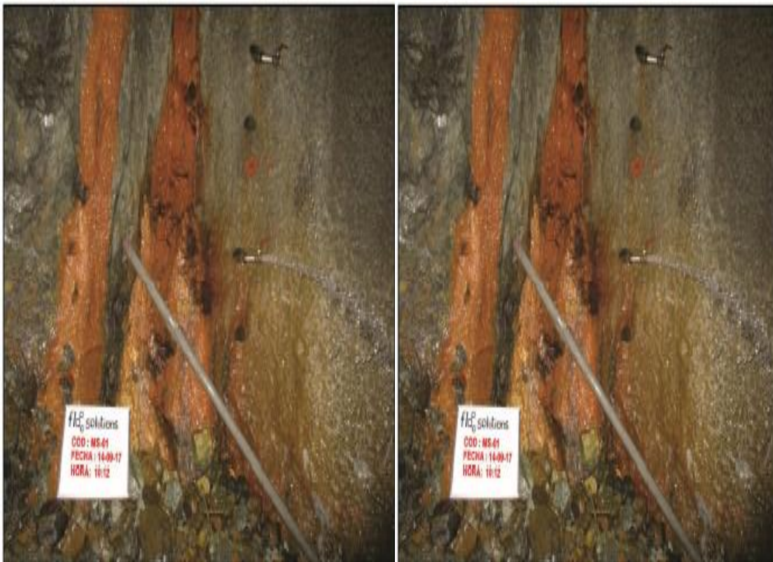
Figura 3 Puntos de filtraciones interior mina-Magistral sur.
