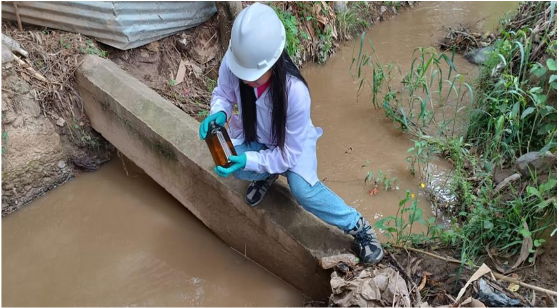
Fig. 1 Toma de muestra para determinar los indicadores microbiológicos
