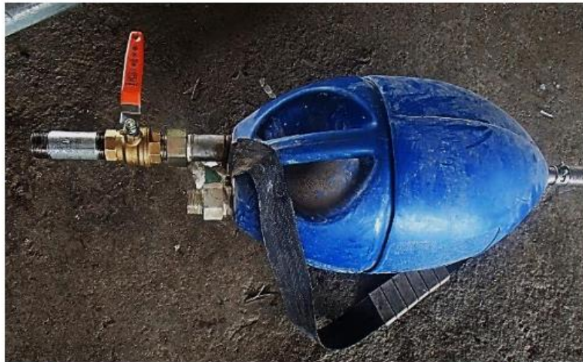
Válvula de paso – entrada de aire en la bomba hydrabolt.
