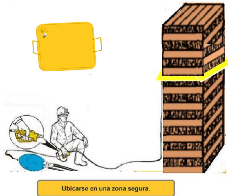
Figura 28 Instalación del Jack pack
