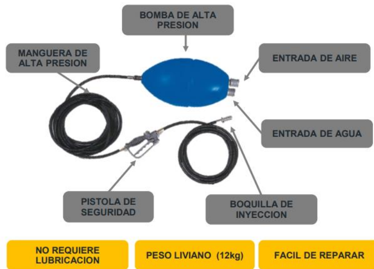
Partes de bomba de alta presión
