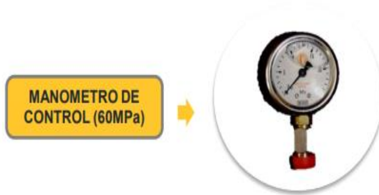
Figura 22 Manómetro de control
