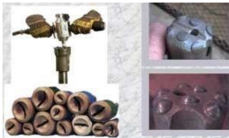
Figura 9. Afilado de broca de botones.
