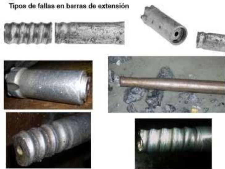
Figura 18. Tipos de fallas en barras de extensión
