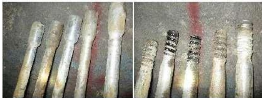
Figura 35. Rotación de las barras y engrasado de las roscas
