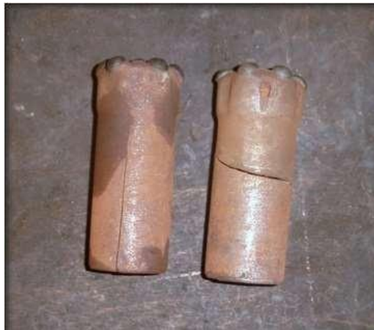
Figura 21. Rotura transversal y longitudinal de la broca.
