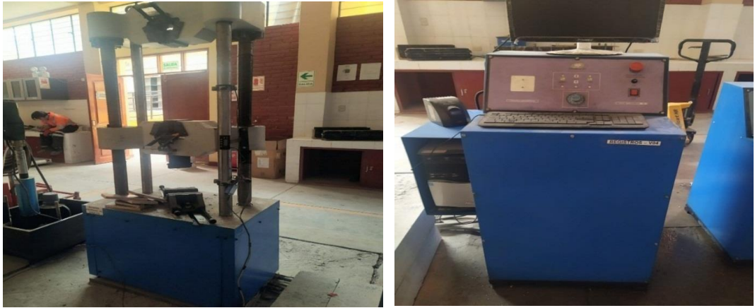
Figura 49: Equipo para ensayo de resistencia a flexión
