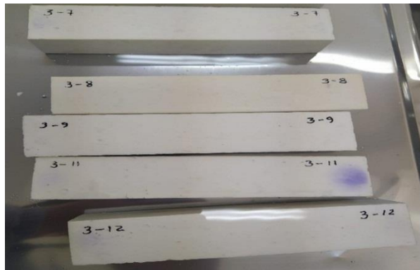
Figura 50: Probetas codificadas para el ensayo a flexión
