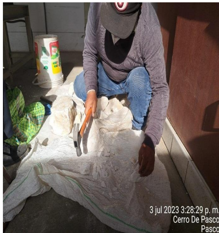
Figura 24: Trituración manual del material
