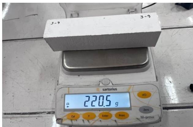
Figura 73: Pesado de probetas para prueba de absorción
