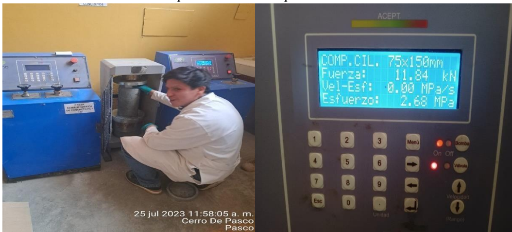
Prueba de resistencia a compresión axial simple
