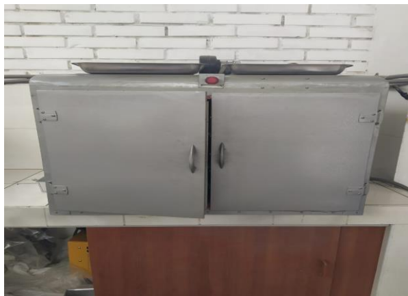
Figura 67: Horno mufla para secado de probetas a 40 °C
