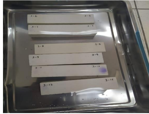
Secado de la prueba de absorción y pesado con líquido absorbido
