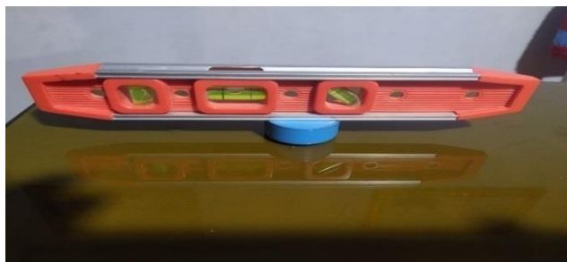
Figura 71: Nivel de mano para nivelar la bandeja con agua
