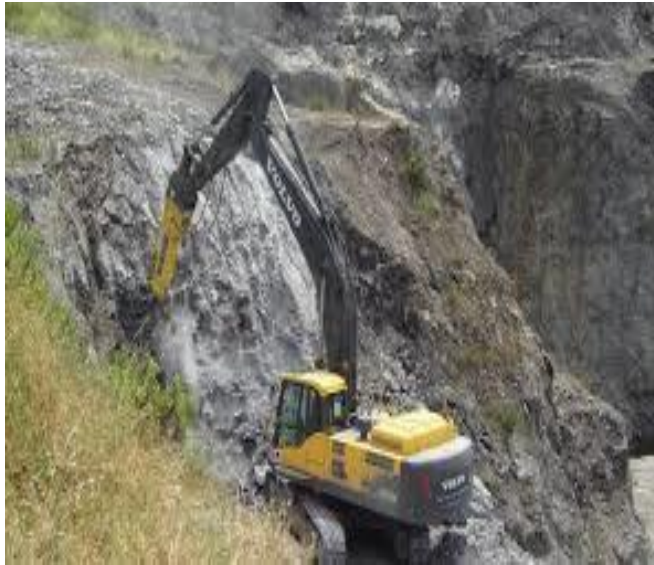
Figura 11: Extracción de piedra aljez mecanizada
