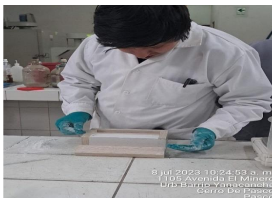
Figura 37: Desmoldando la probeta
