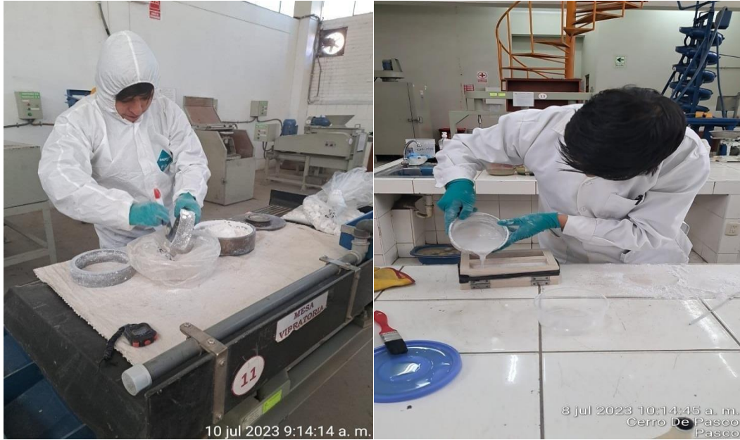
Secado y codificado de probetas
