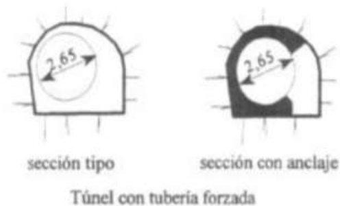
Figura II 2 Túneles hidráulicos en una central hidroeléctrica
