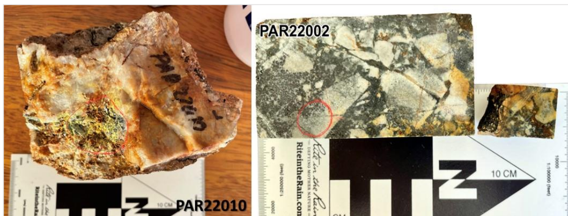
FIGURA 24: PAR22010, MUESTRA PERTENECIENTE A CUERPO MASIVO DE CUARZO BLANCO, PRESENTA VALORES DE 17.89 GR/TN AU, 3.90% MO. PAR22002, BRECHA CUARZO TURMALINA CON VENILLAS DE CUARZO SULFUROS TIPO STOCKWORK, PRESENTA VALORES DE 5.70 GR/TN AU, 0.045% CU Y 2.773% MO.
