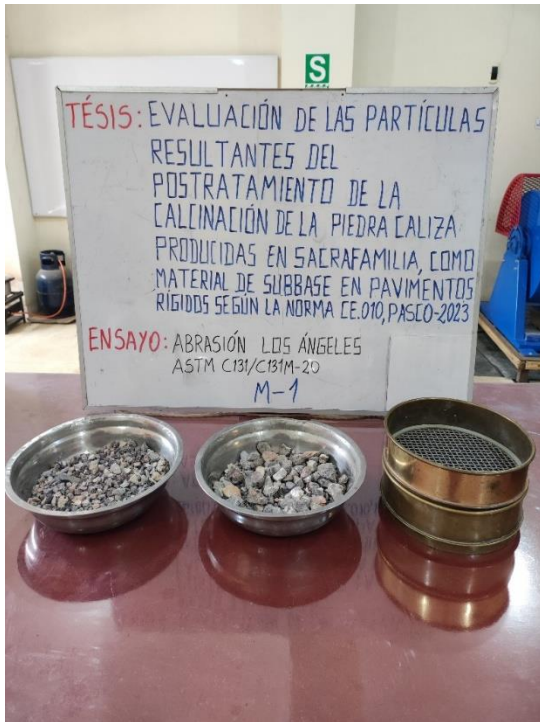
Fotografía 43, Fotografía 44. Selección granulométrica de gravas para ensayo Abrasión los Ángeles
