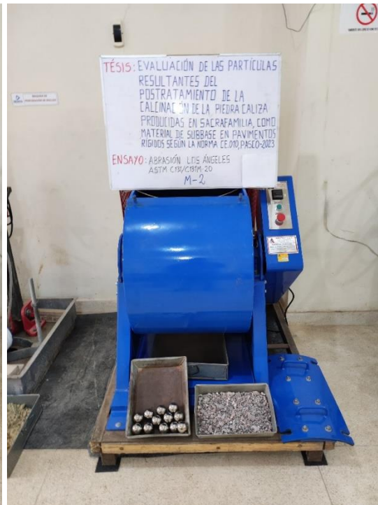
Fotografía 49, Fotografía 50. Ensayo desgaste en Máquina Los Ángeles
