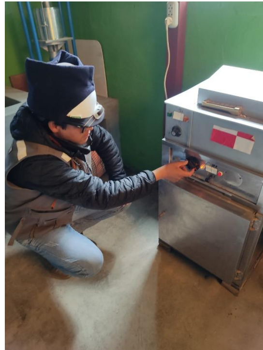
Fotografía 33, Fotografía 34. Procedimiento de secado de muestras para determinación del contenido óptimo de humedad y máxima densidad seca Proctor Modificado .
