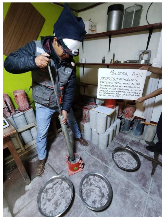
Fotografía 35, Fotografía 36. Procedimiento de ensayo de Proctor Modificado.
