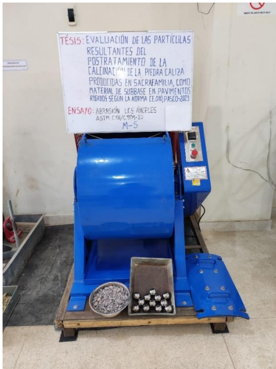
Fotografía 53, Fotografía 54. Ensayo desgaste en Máquina Los Ángeles
