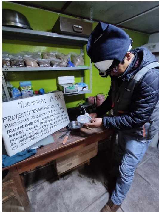
Fotografía 31, Fotografía 32. Ensayo de Límites de consistencia limitantes en el ensayo de Casagrande el material es NO PLÁSTICO.
