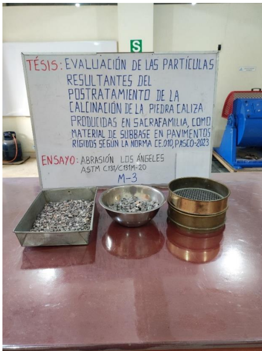
Fotografía 45, Fotografía 46. Selección granulométrica de gravas para ensayo Abrasión los Ángeles
