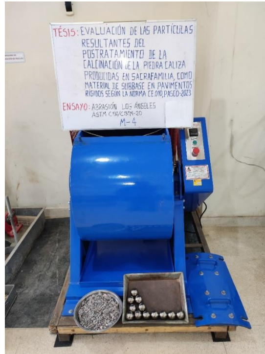
Fotografía 51, Fotografía 52. Ensayo desgaste en Máquina Los Ángeles
