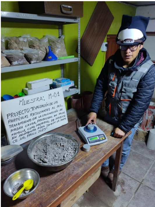
Fotografía 31, Fotografía 32. Ensayo de Límites de consistencia limitantes en el ensayo de Casagrande el material es NO PLÁSTICO.
