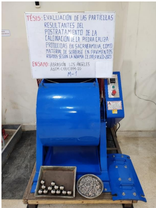
Fotografía 49, Fotografía 50. Ensayo desgaste en Máquina Los Ángeles
