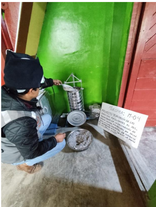
Fotografía 27, Fotografía 28. Ensayo de análisis granulométrico por tamizado mecánico. M-03 y M-04
