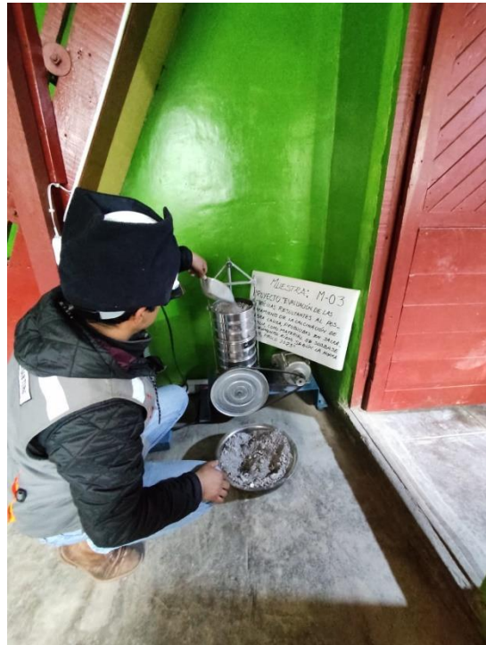
Fotografía 29, Fotografía 30. Ensayo de análisis granulométrico por tamizado mecánico.
