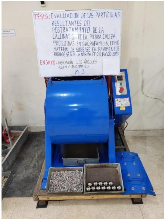
Fotografía 51, Fotografía 52. Ensayo desgaste en Máquina Los Ángeles
