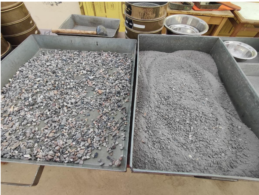
Fotografía 42 Selección de muestras para ensayos Abrasión los Ángeles, equivalente de arena y sales solubles totales
