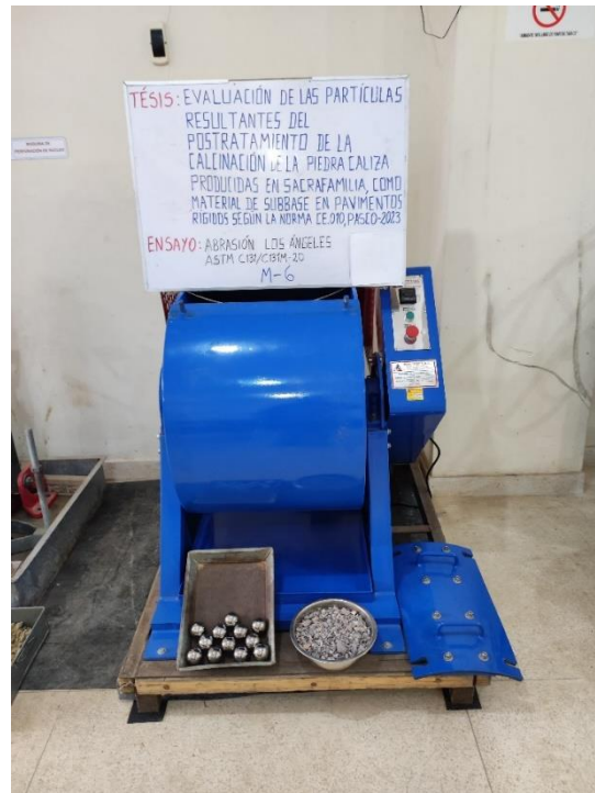
Fotografía 53, Fotografía 54. Ensayo desgaste en Máquina Los Ángeles
