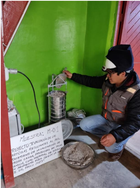
Fotografía 25, Fotografía 26. Ensayo de análisis granulométrico por tamizado mecánico. M-01 y M-02
