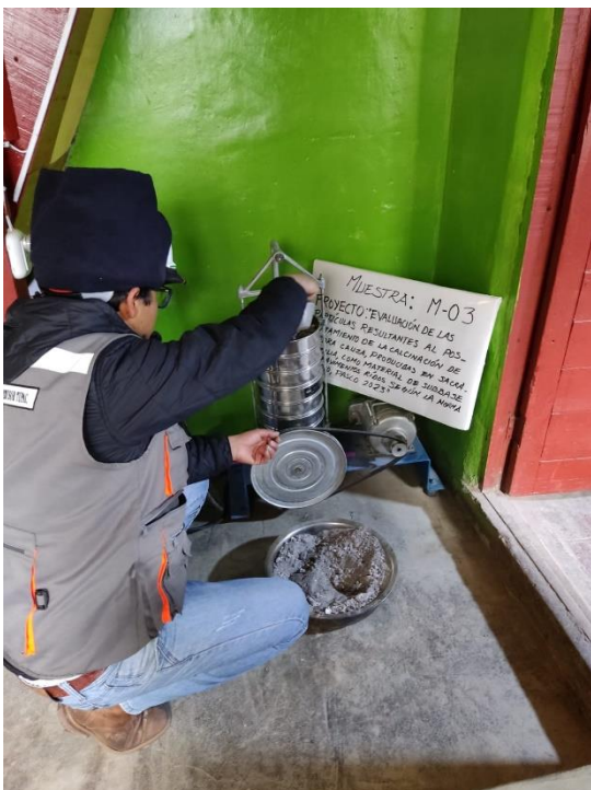
Fotografía 27, Fotografía 28. Ensayo de análisis granulométrico por tamizado mecánico. M-03 y M-04
