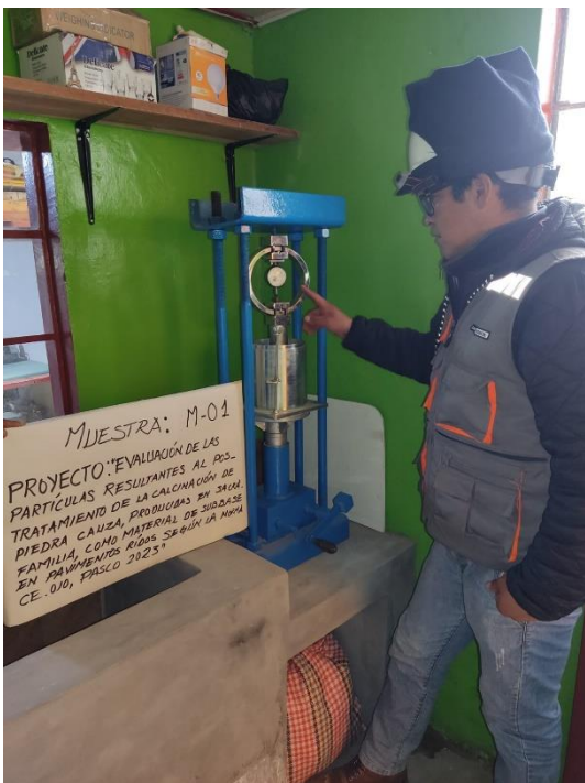
Fotografía 39, Fotografía 40. Procedimiento de ensayo de Proctor Modificado determinación de la carga de penetración.
