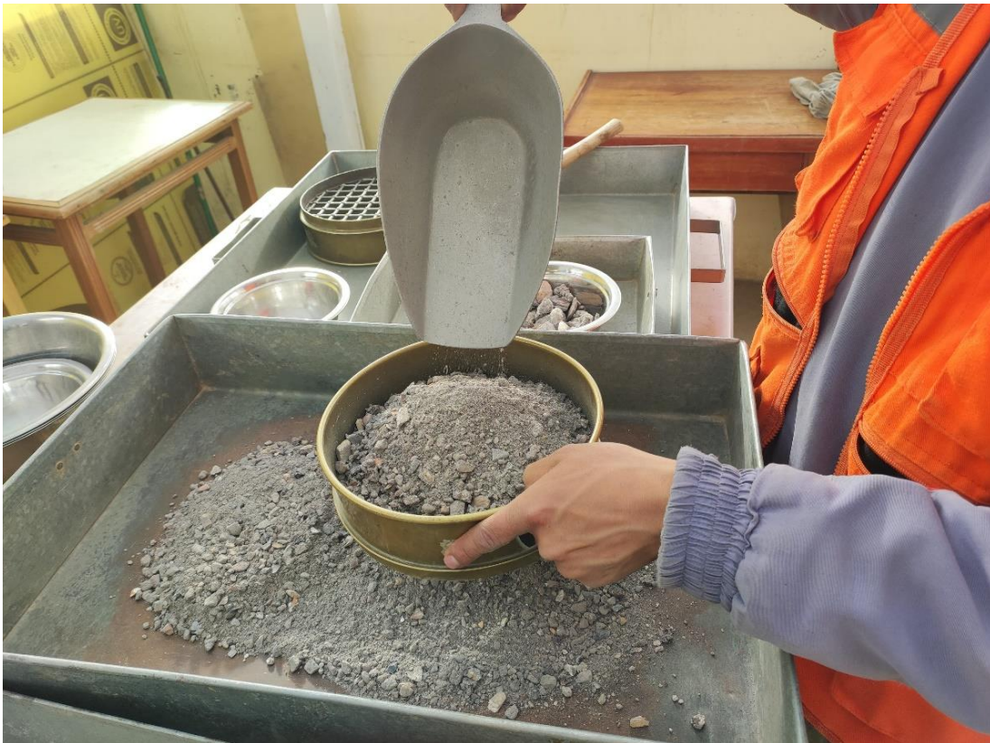
Fotografía 42 Selección de muestras para ensayos Abrasión los Ángeles, equivalente de arena y sales solubles totales
