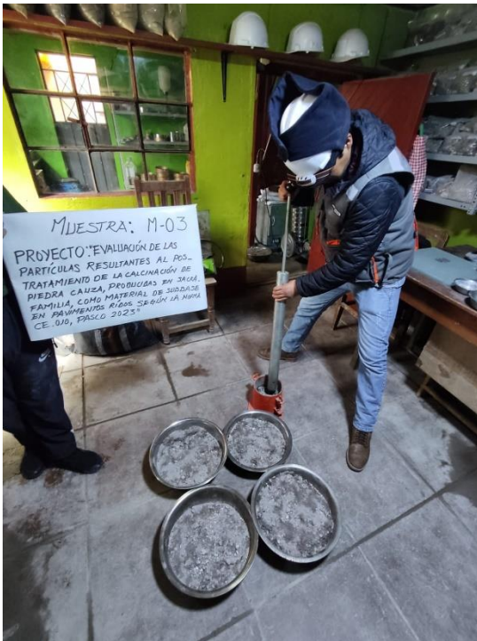
Fotografía 37, Fotografía 38. Procedimiento de ensayo de Proctor Modificado.
