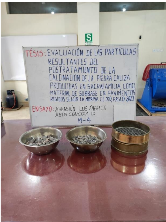
Fotografía 45, Fotografía 46. Selección granulométrica de gravas para ensayo Abrasión los Ángeles
