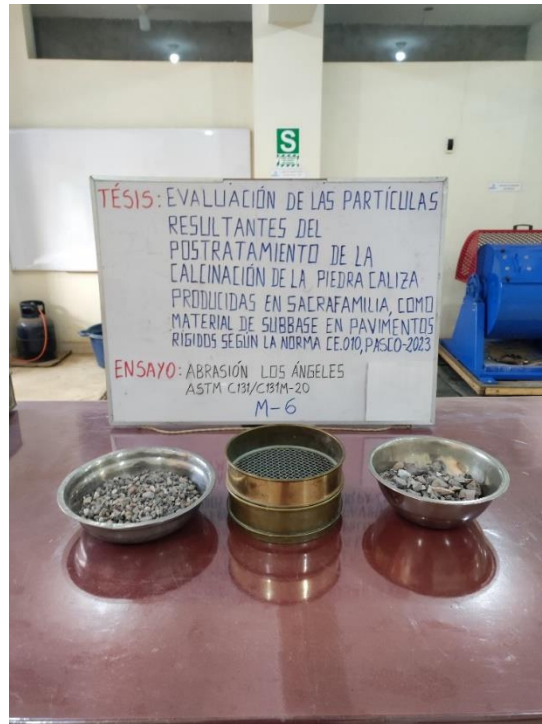
Fotografía 49, Fotografía 50. Ensayo desgaste en Máquina Los Ángeles
