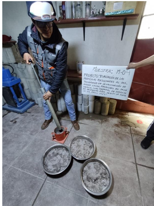
Fotografía 37, Fotografía 38. Procedimiento de ensayo de Proctor Modificado.
