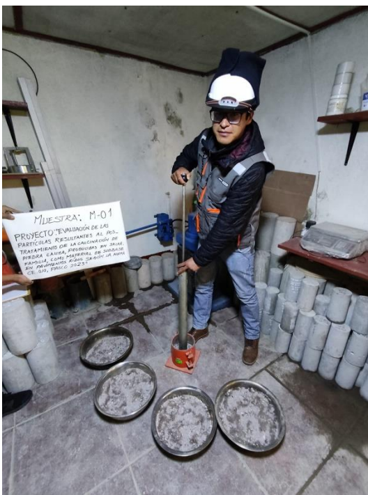
Fotografía 35, Fotografía 36. Procedimiento de ensayo de Proctor Modificado.
