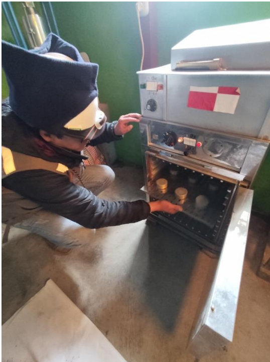
Fotografía 33, Fotografía 34. Procedimiento de secado de muestras para determinación del contenido óptimo de humedad y máxima densidad seca Proctor Modificado .
