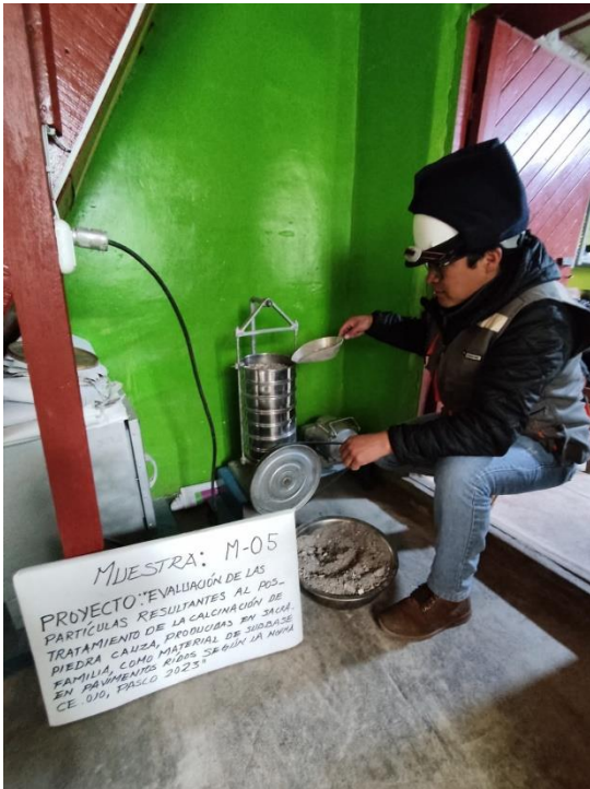
Fotografía 29, Fotografía 30. Ensayo de análisis granulométrico por tamizado mecánico.
