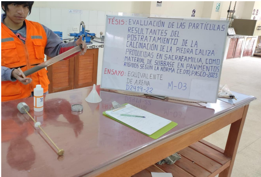
Fotografía 58. Ensayo Equivalente de Arena, Sales Solubles Totales y Cloruros
