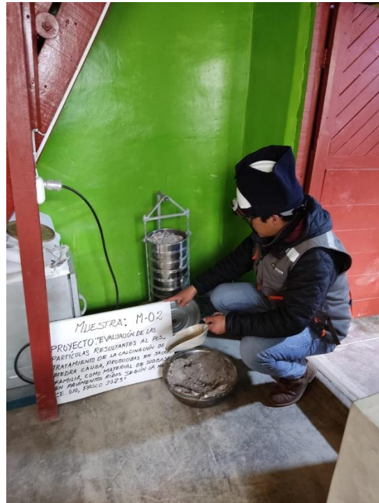
Fotografía 25, Fotografía 26. Ensayo de análisis granulométrico por tamizado mecánico. M-01 y M-02
