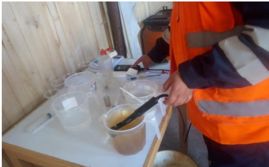
Figura 4. Control de parámetros – Multiparámetro Hanna
