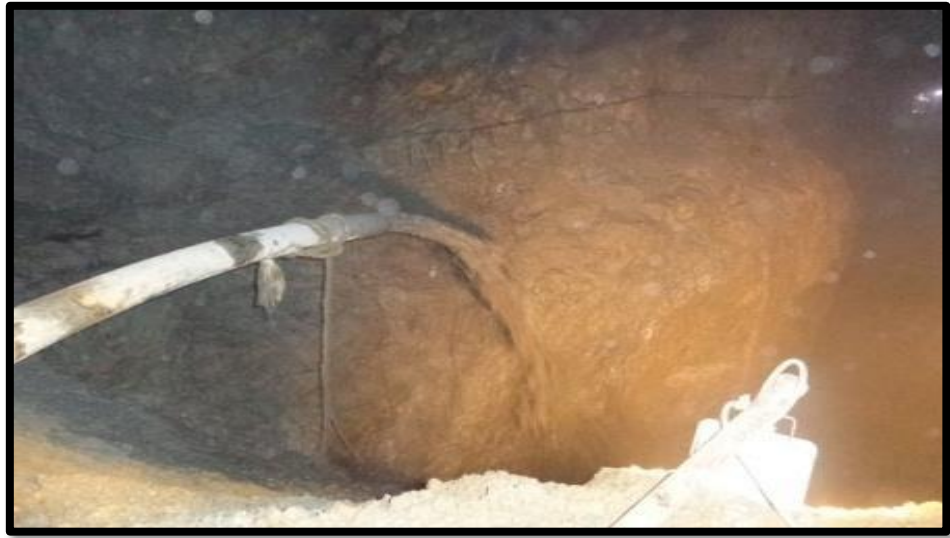
Ilustración 25. Tajo de Taladros Largos en Proceso de Relleno
