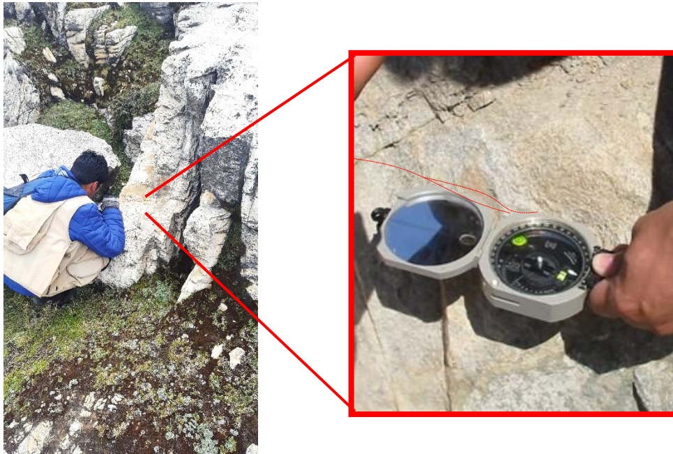
Figura 20. Vista de cómo se orienta la brújula para medir el Azimuth de la estructura fractal.
