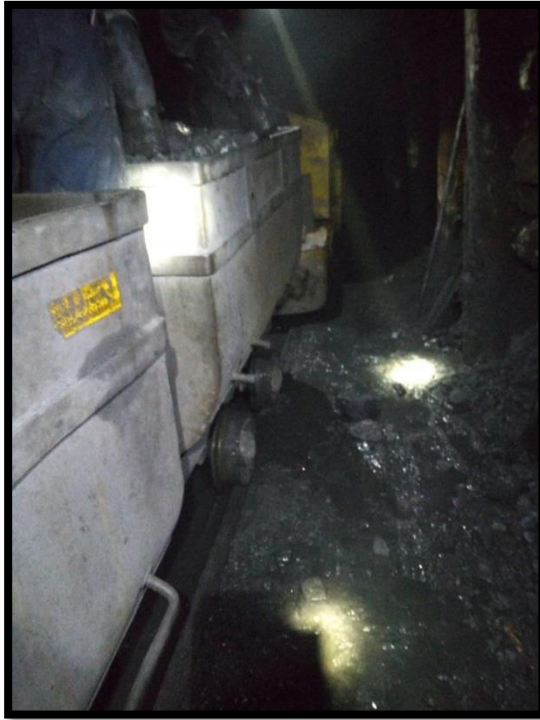
Acarreo de desmonte con carros U-36 jalados por locomotora a batería.
