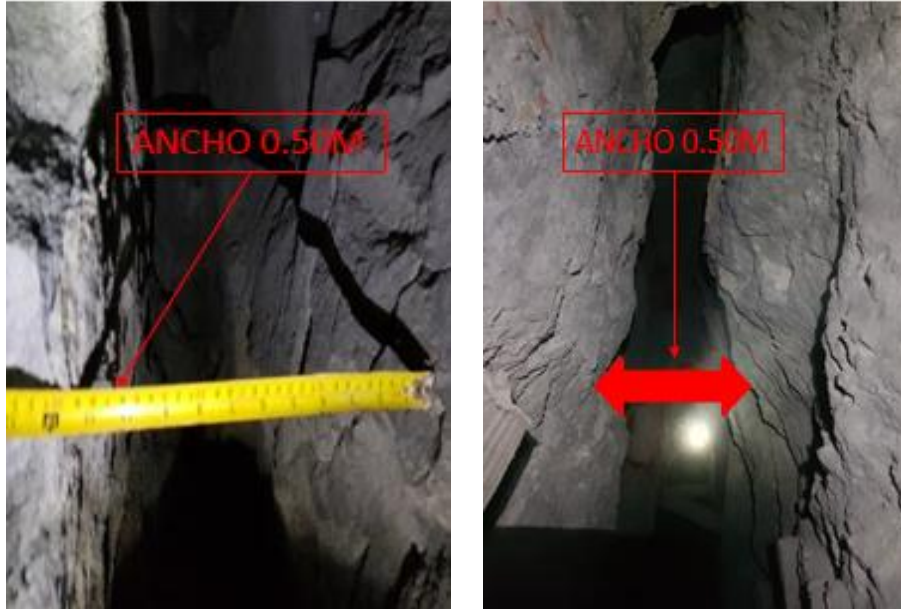
Foto 001: Resultado de Voladura en Circado en Vetas Angostas
