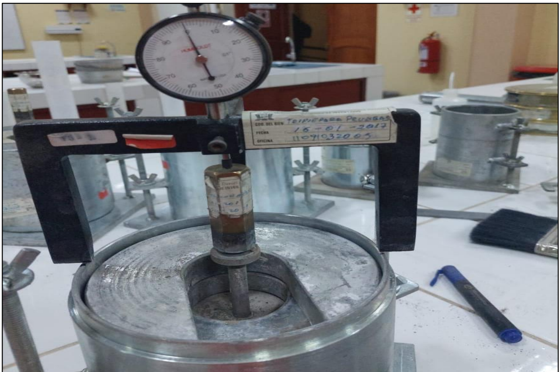
Fotografía 30. Se realiza el ensayo de expansión para pruebas de CBR con el deformímetro dial análogo.
