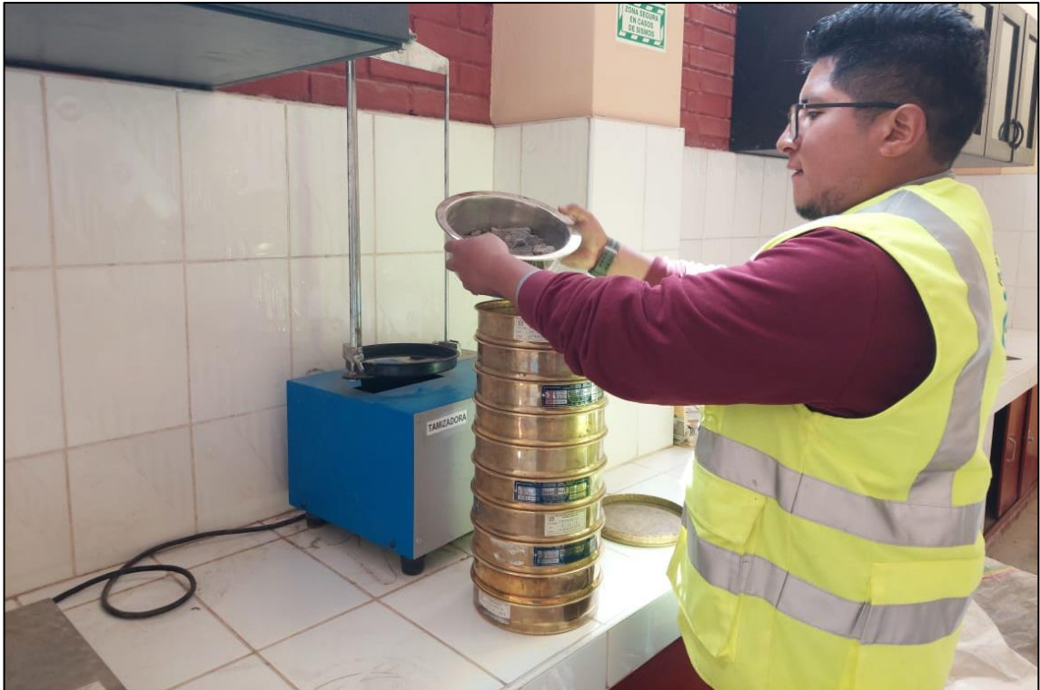
Fotografía 21. Procedimiento del tamizado del suelo con tratamiento (ceniza de quinual) para determinar la masa del material retenido en cada tamiz.
