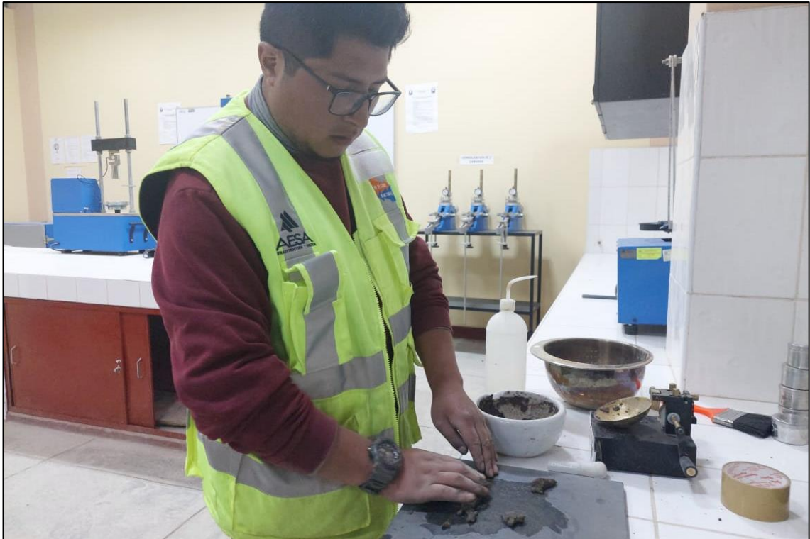
Fotografía 23. Se realiza el ensayo para obtener el límite de plasticidad del suelo con tratamiento (ceniza de quinual). Y posteriormente hallar el índice de plasticidad.
