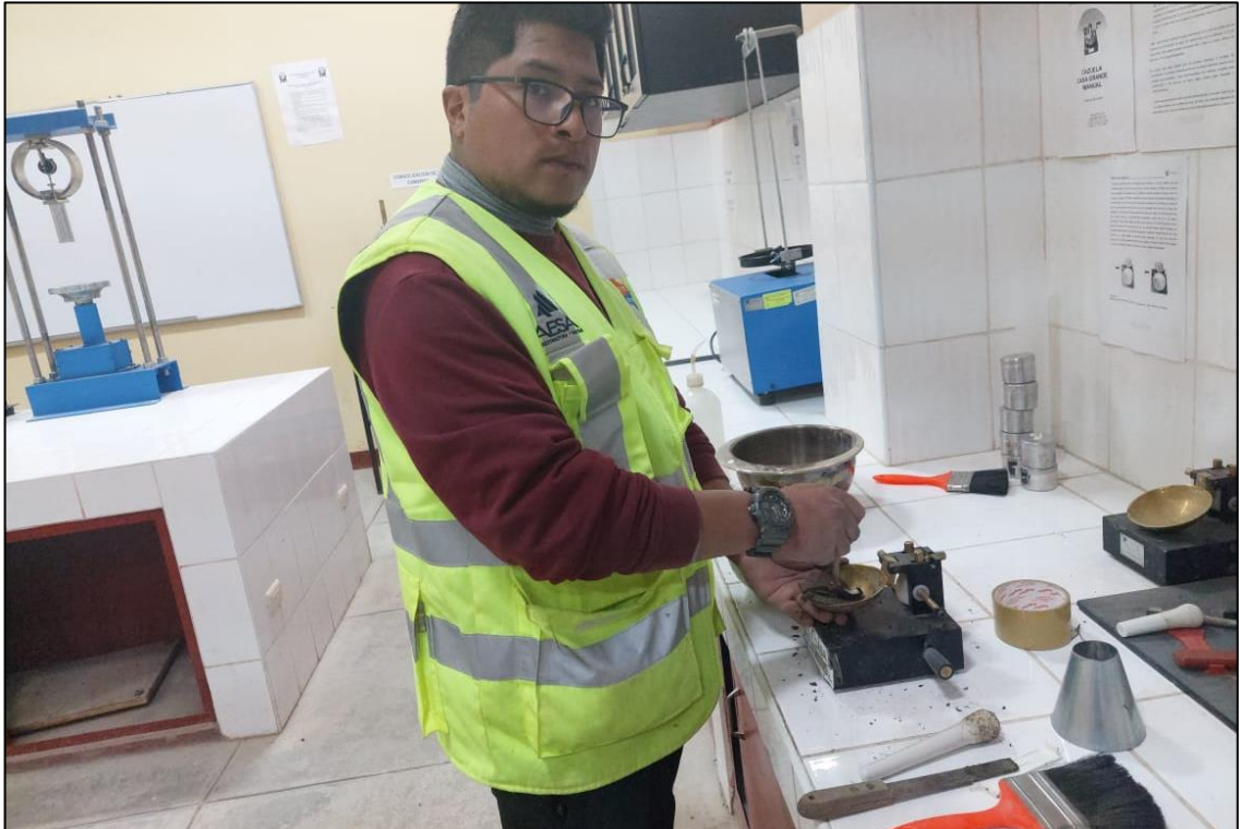
Fotografía 22. Se realiza el ensayo para obtener el límite líquido con la Copa de Casagrande del suelo con tratamiento (ceniza de quinual).
