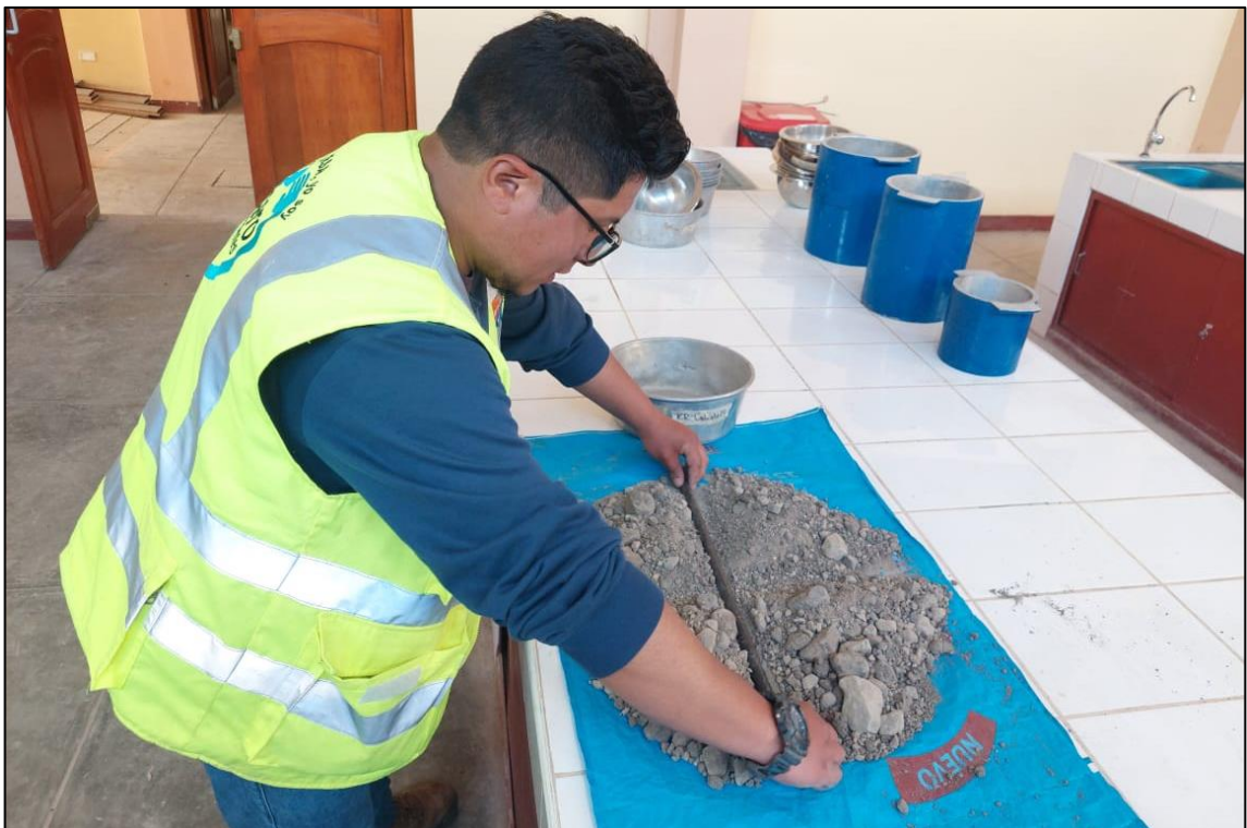
Fotografía 14. Cuarteo de la muestra para los ensayos correspondiente para la investigación.
