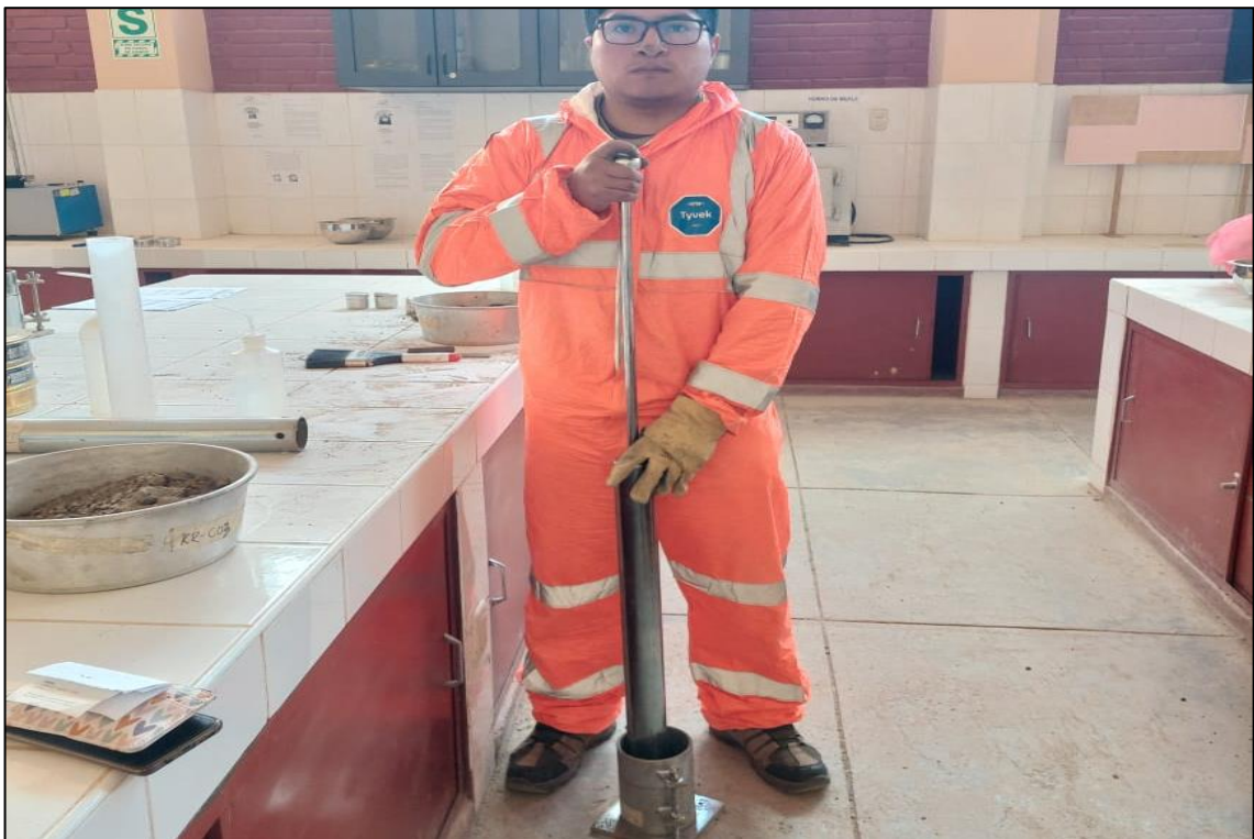
Fotografía 28. Compactación del suelo con tratamiento en tres capas, cada capa tubo 25 golpes de acuerdo al metodo que se utilizó para este ensayo.
