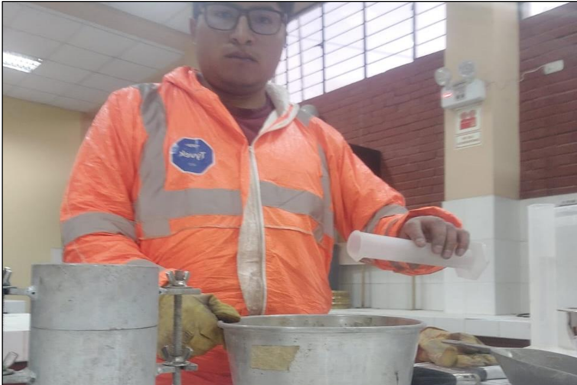
Fotografía 25. Se empieza a realizar el ensayo de proctor modificado para hallar la dosificación óptima de cenizas de quinual para el tratamiento del suelo.
