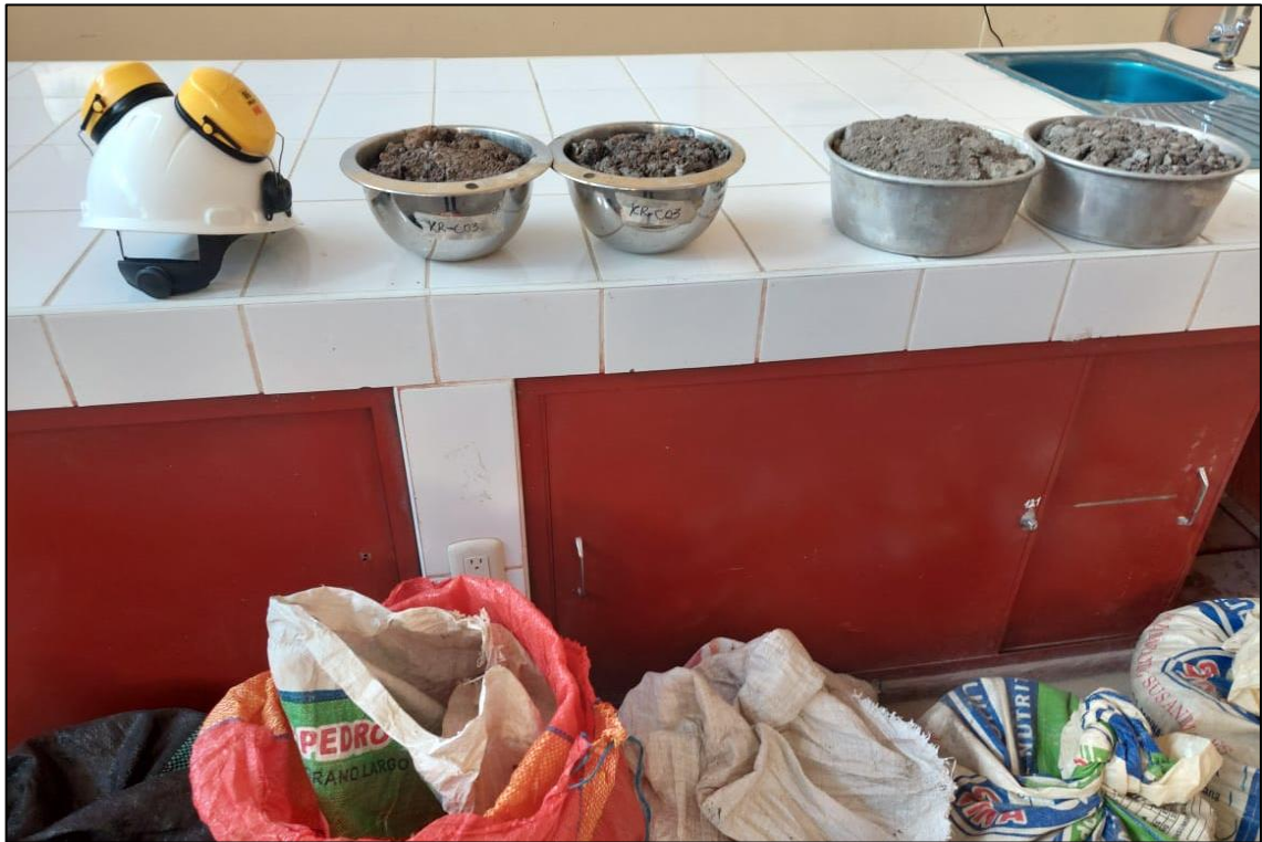
Fotografía 12. Muestras secas después de 24 horas en el horno.
