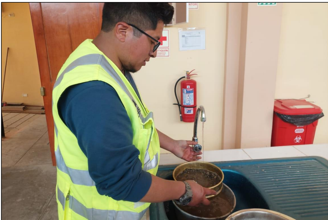
Fotografía 16. Lavado de las muestras y posteriormente llevarlo al horno para realizar el ensayo de granulometría.
