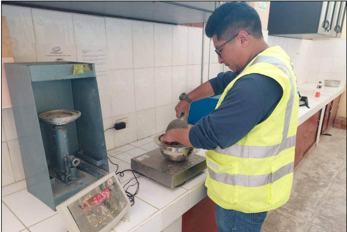
Fotografía 15. Peso de la muestra para realizar el ensayo de granulometría.
