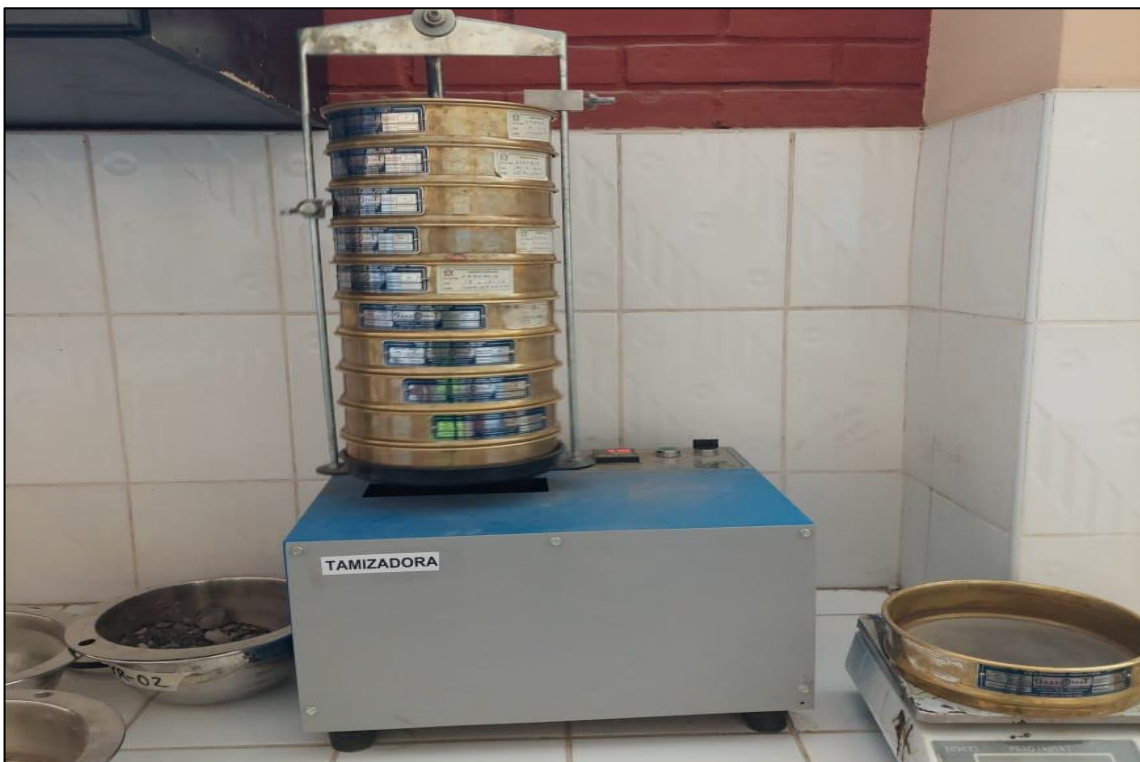
Fotografía 18. Procedimiento del tamizado para determinar la masa del material retenido en cada tamiz.
