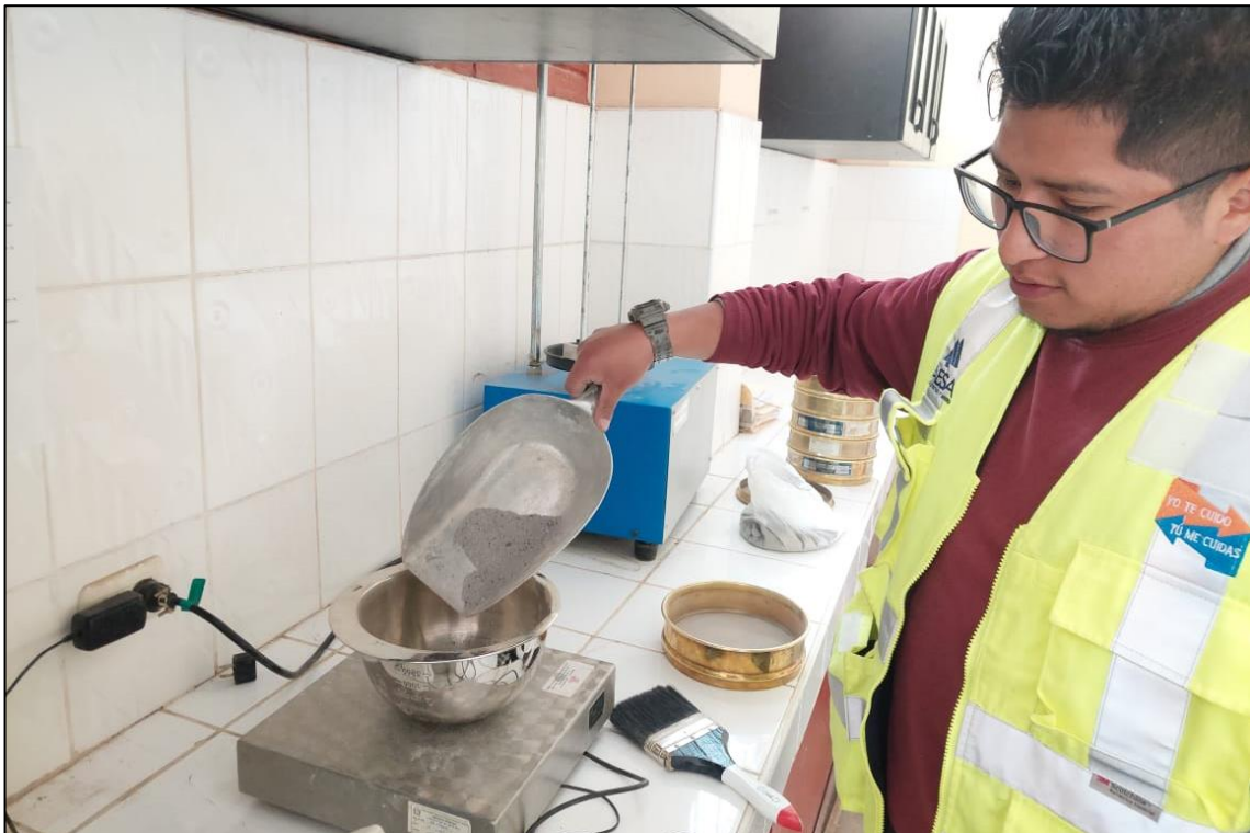
Fotografía 20. Peso de la ceniza de quinual para realizar los diseños experimentales para la investigación.
