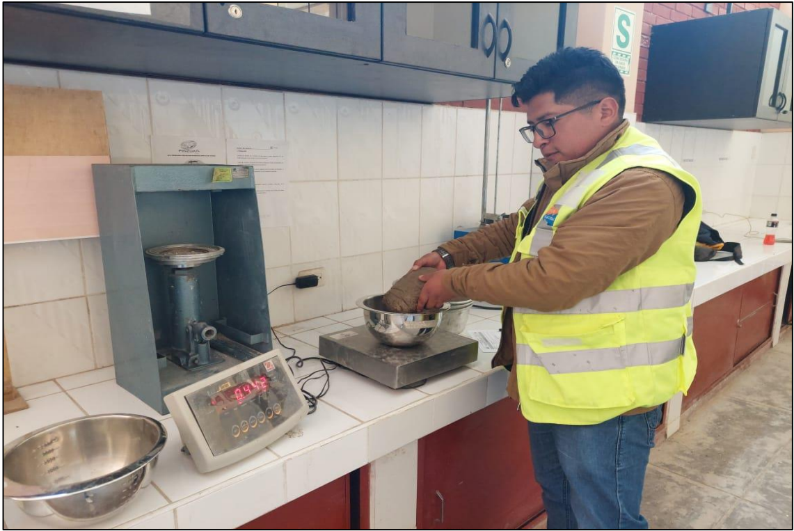
Fotografía 11. Peso de la muestra N° 02 húmeda para hallar los resultados del contenido de humedad.
