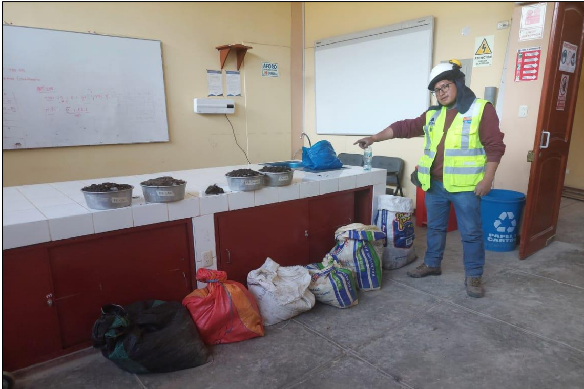
Fotografía 9. Separación de las muestras por kilos para el ensayo de contenido de humedad y los demás ensayos para el proyecto de investigación.
