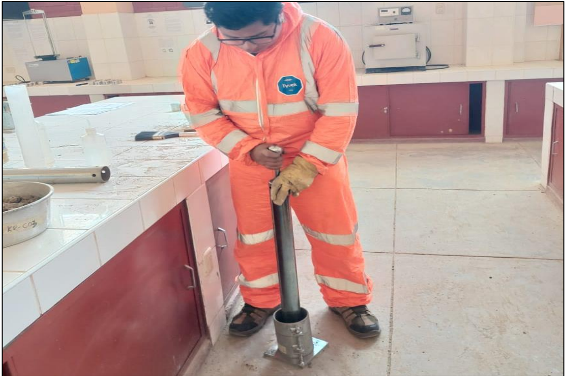
Fotografía 27. Compactación del suelo en tres capas, cada capa tubo 25 golpes de acuerdo al metodo que se utilizó para este ensayo.
