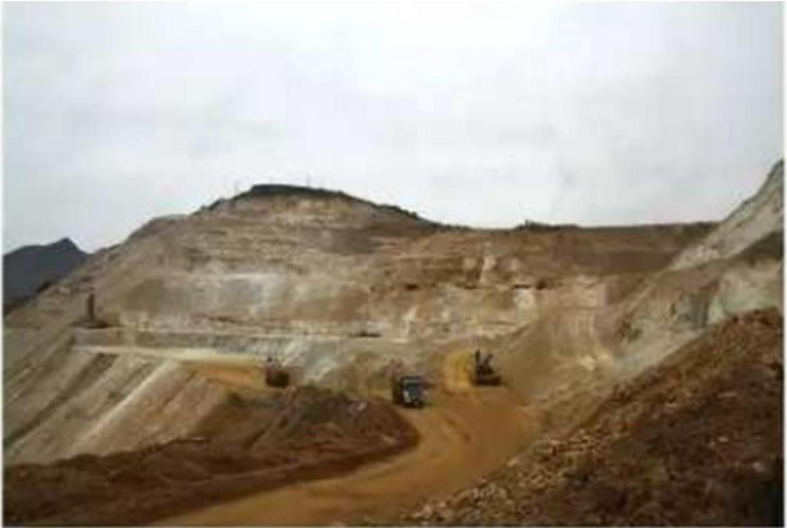
**Foto 004: Explotación del Tajo Mediante Bancos**
