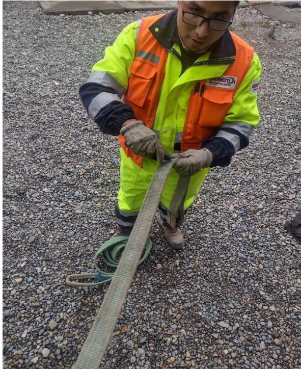
Gráfico N° 76: Fotografía N° 17. Corte de eslingas en mal estado.
