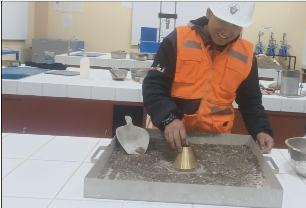
Fotografía 13. Se levanta el molde verticalmente y se verifica si la muestra existe humedad libre, si el agregado mantiene la forma de cono se sigue secando y se hace de nuevo el ensayo hasta que el cono se derrumbe al quitar el molde.
