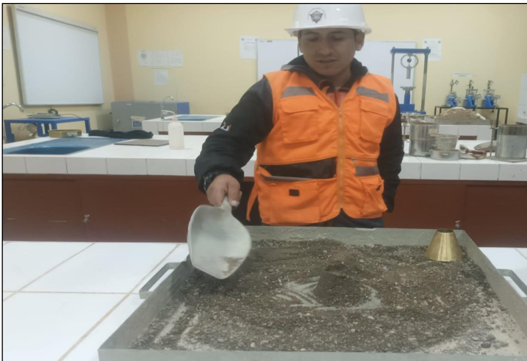
Fotografía 10. Preparación de la muestra para el ensayo de peso específico del agregado fino.
