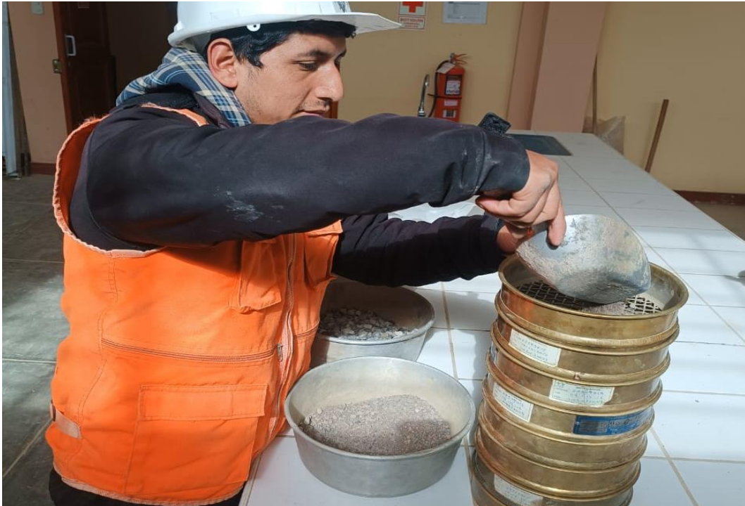
Fotografía 7. Se vierte una cantidad determinada a los tamices para el ensayo granulométrico.
