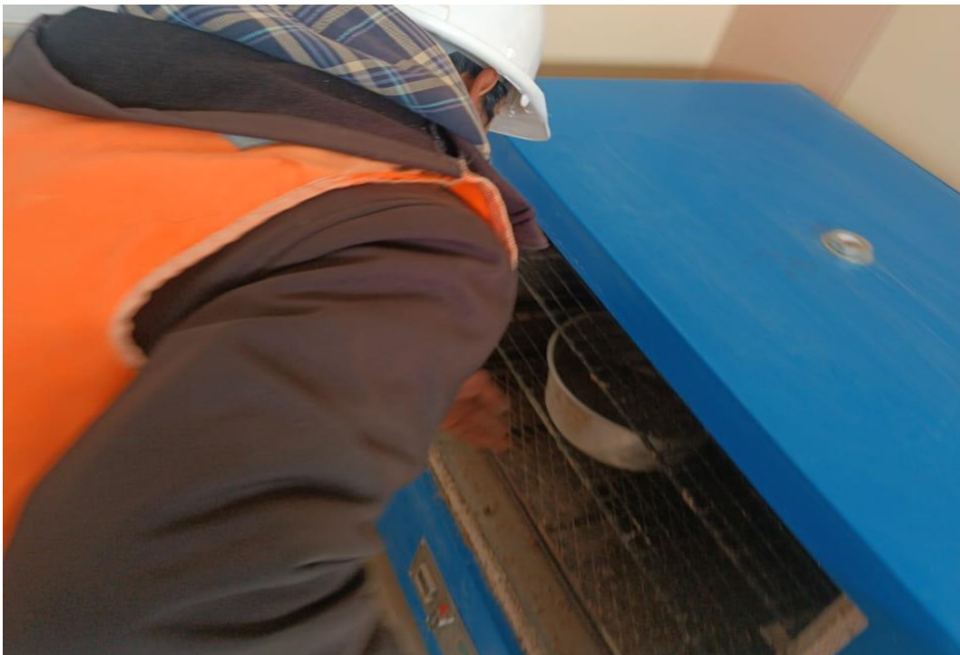
Fotografía 2. Se realiza el secad en horno de los agregados para los ensayos.
