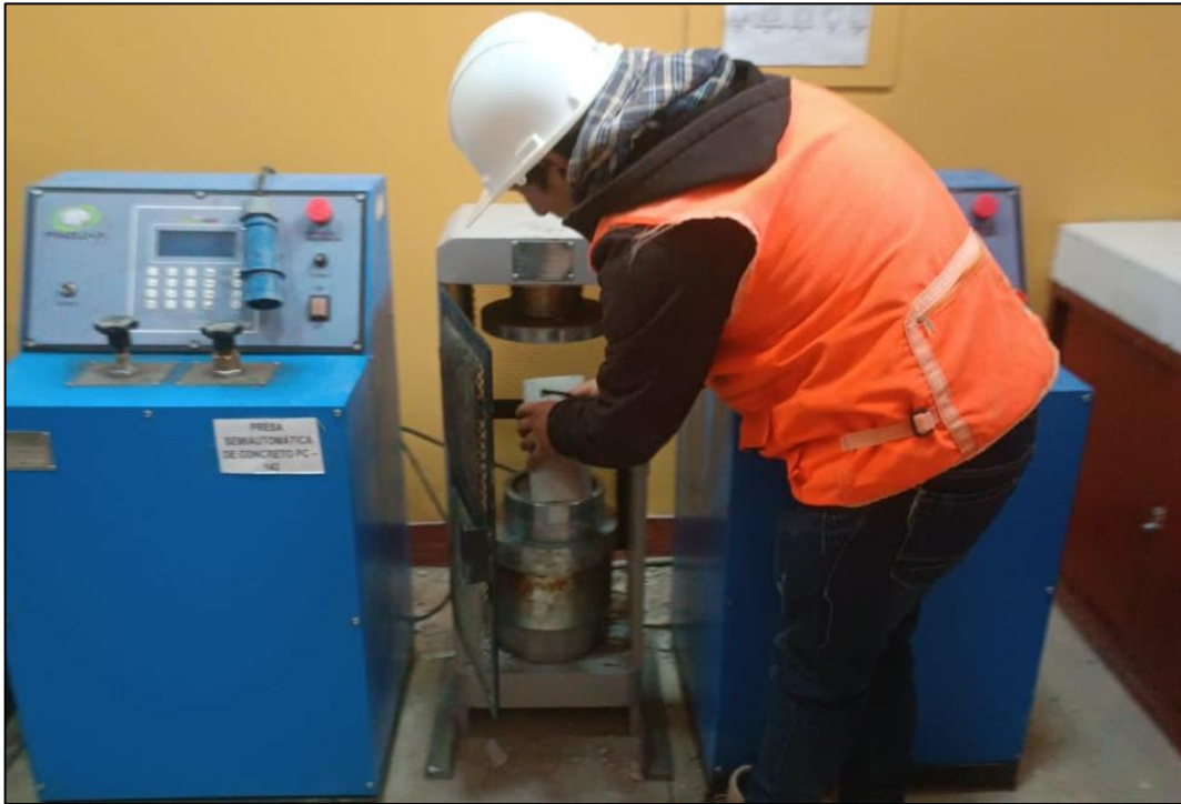
Fotografía 31. Ubicación de la probeta en la prensa de concreto.
