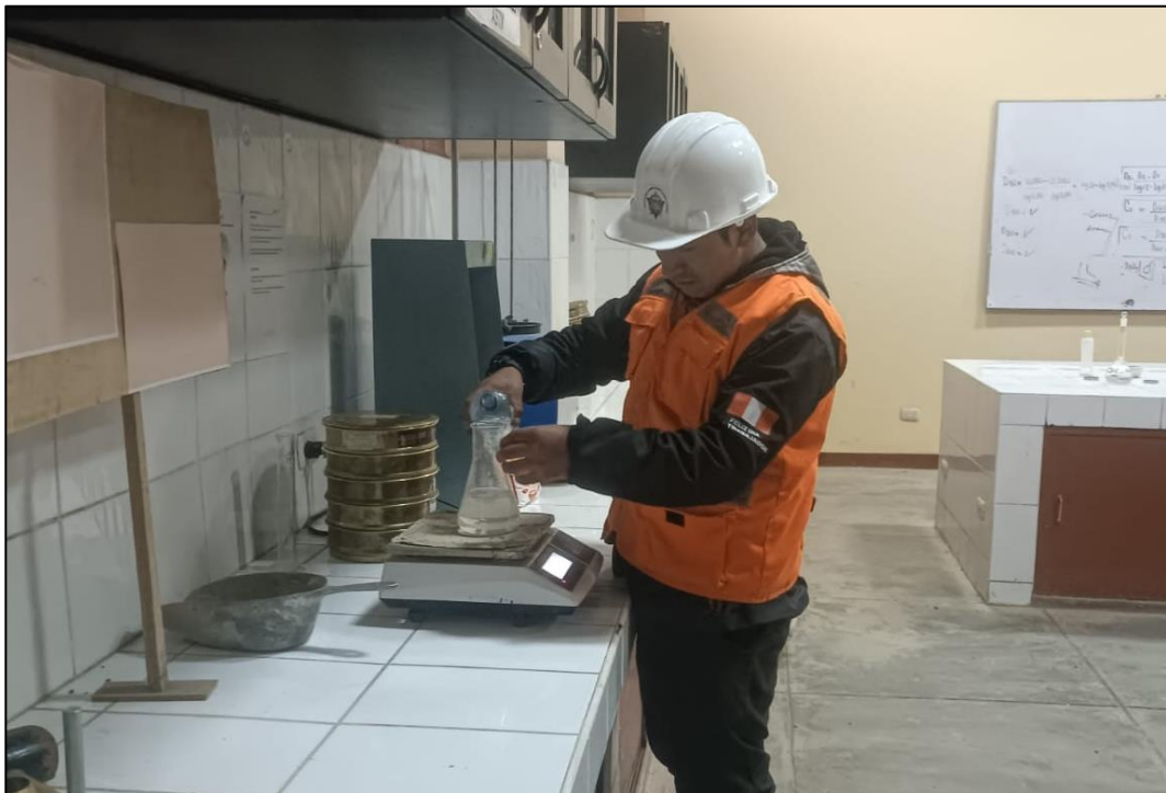
Fotografía 14. Inicio del ensayo de la absorción del agregado fino.
