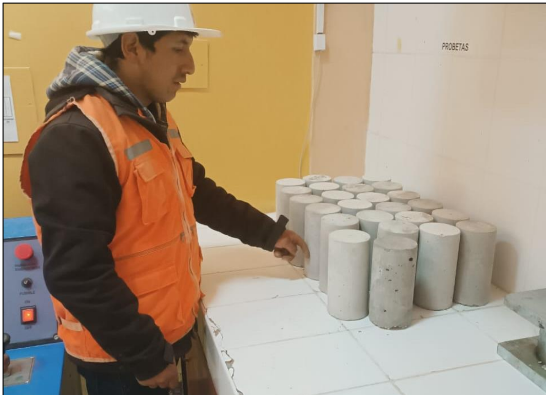
Fotografía 30. Probetas realizadas con diferentes mezclas después de una hora de haber curado.
