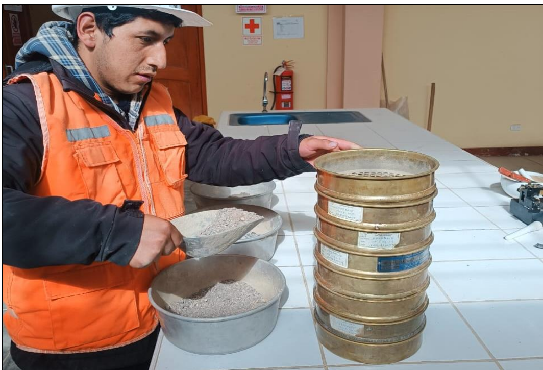
Fotografía 6. Inicio del ensayo granulométrico de los agregados.
