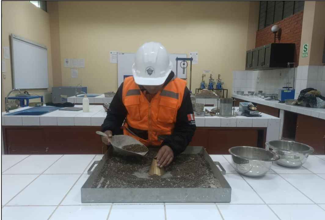
Fotografía 11. Se utiliza el molde cónico para la prueba de peso específico.
