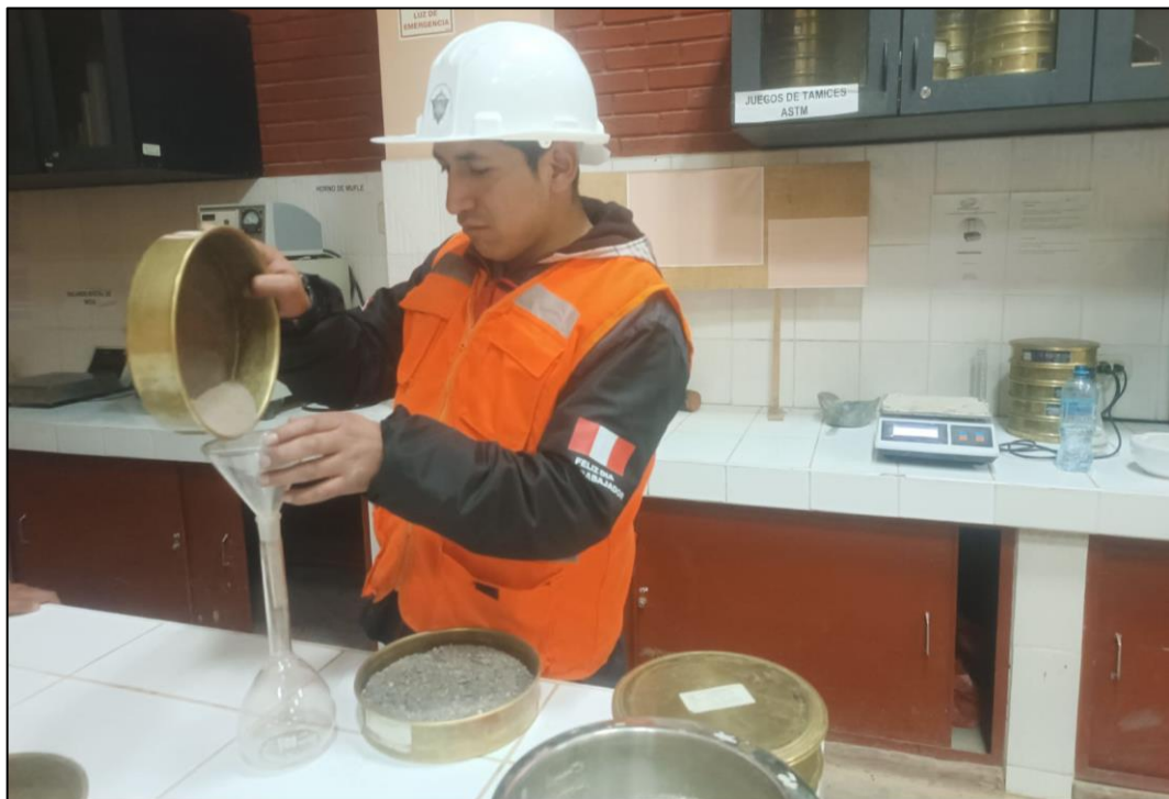
Fotografía 18. Se introduce de inmediato en el frasco la muestra y se llena de agua hasta alcanzar aproximadamente la marca de 500 cm 3 .
