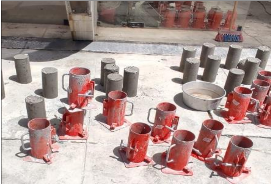
Fotografía 29. Desmolde de las probetas con concreto natural y concreto experimental.
