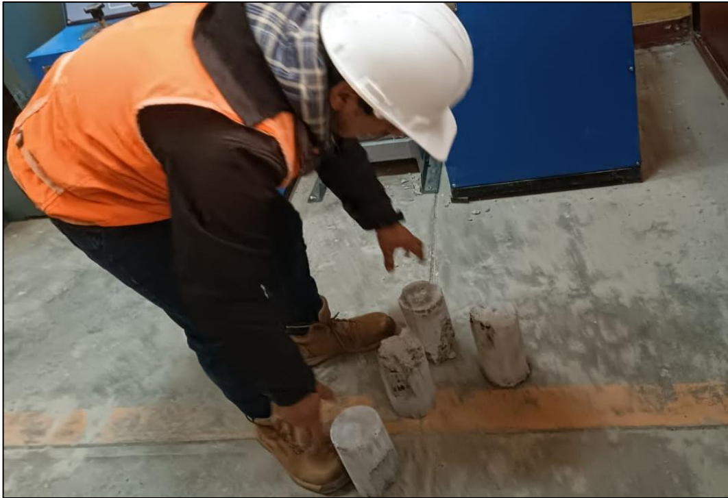
Fotografía 33. Resultados del ensayo a compresión, se muestran los tipos de corte que obtuvo cada probeta.
