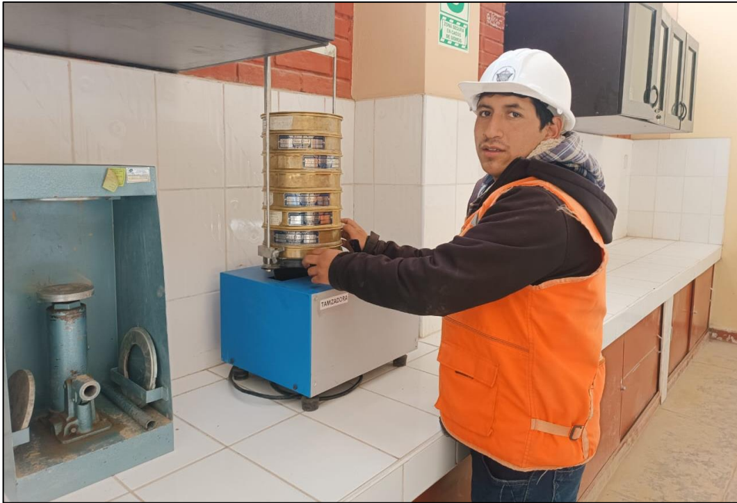
Fotografía 9. Tamizando los agregados (finos y gruesos).
