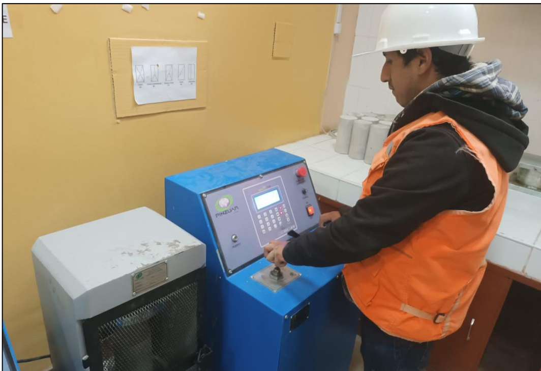
Fotografía 32. Manipulación de la máquina para el ensayo de resistencia a la compresión.
