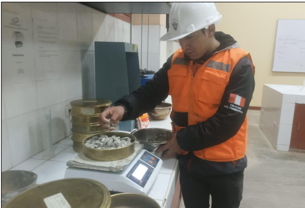
Fotografía 22. Se inicia el ensayo de peso específico y absorción del agregado grueso.
