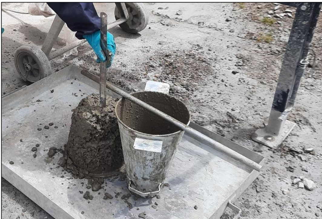
Fotografía 28. Asentamiento del concreto natural y el concreto experimental.
