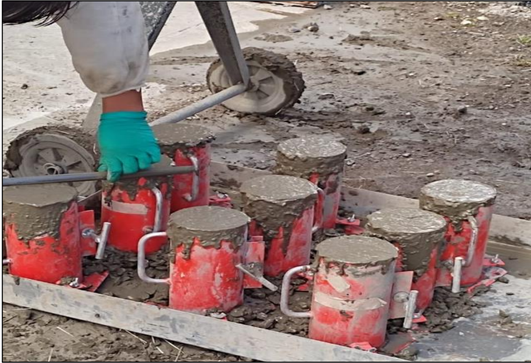
Fotografía 27. Preparación de las probetas con concreto natural y el concreto experimental.
