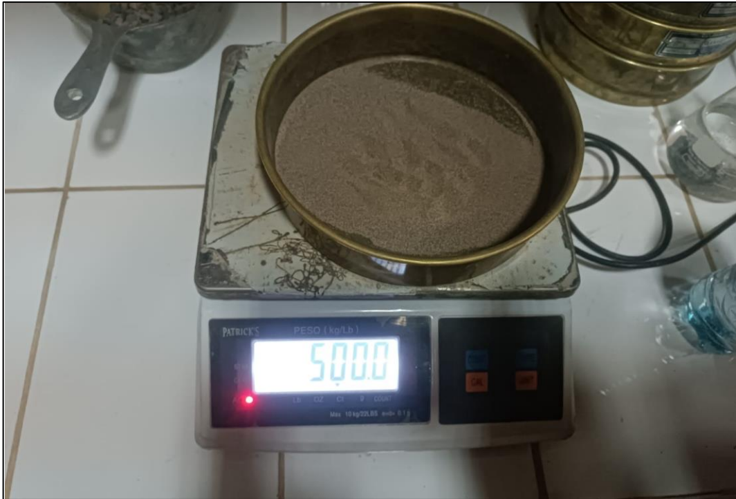
Fotografía 17. Se pesa una muestra de 500 gramos del material preparado.
