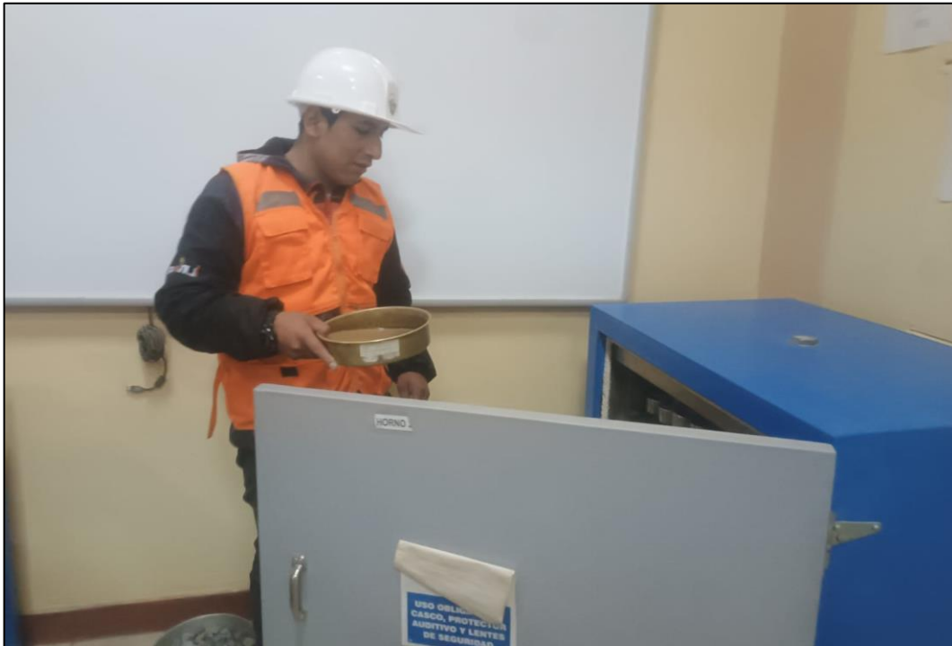
Fotografía 21. Se seca a peso constante en el horno a una temperatura de 110 °C y luego se enfría.
