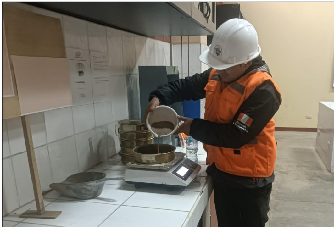
Fotografía 16. Peso del agregado fino secado durante 24 horas para el ensayo de peso específico del agregado fino.
