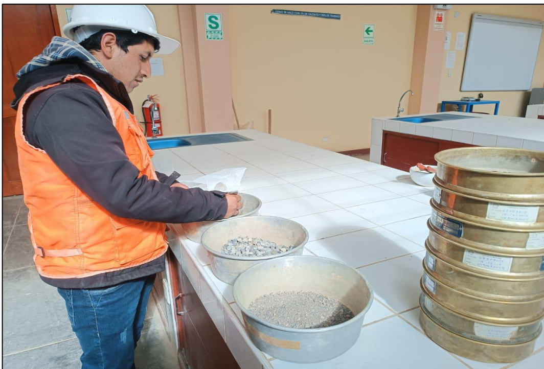
Fotografía 4. Preparación de los agregados para el ensayo granulométrico.
