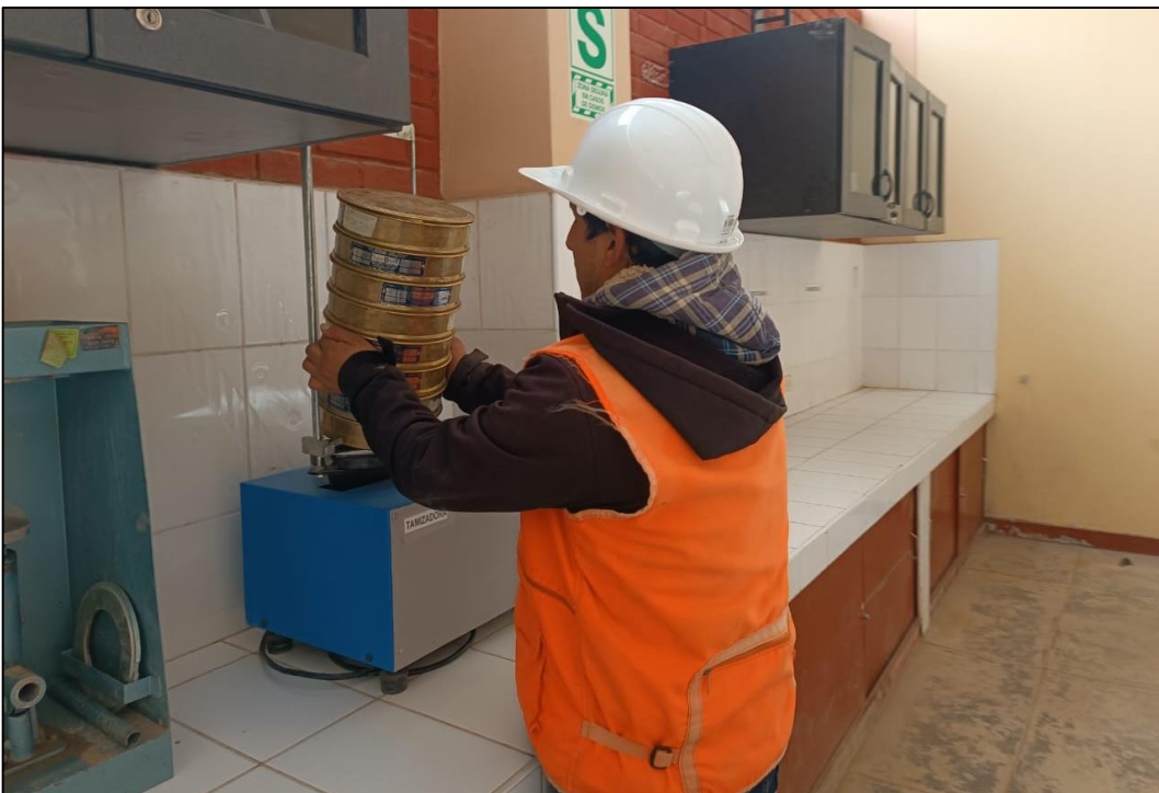
Fotografía 8. Llevando los agregados a la tamizadora para el ensayo granulométrico.
