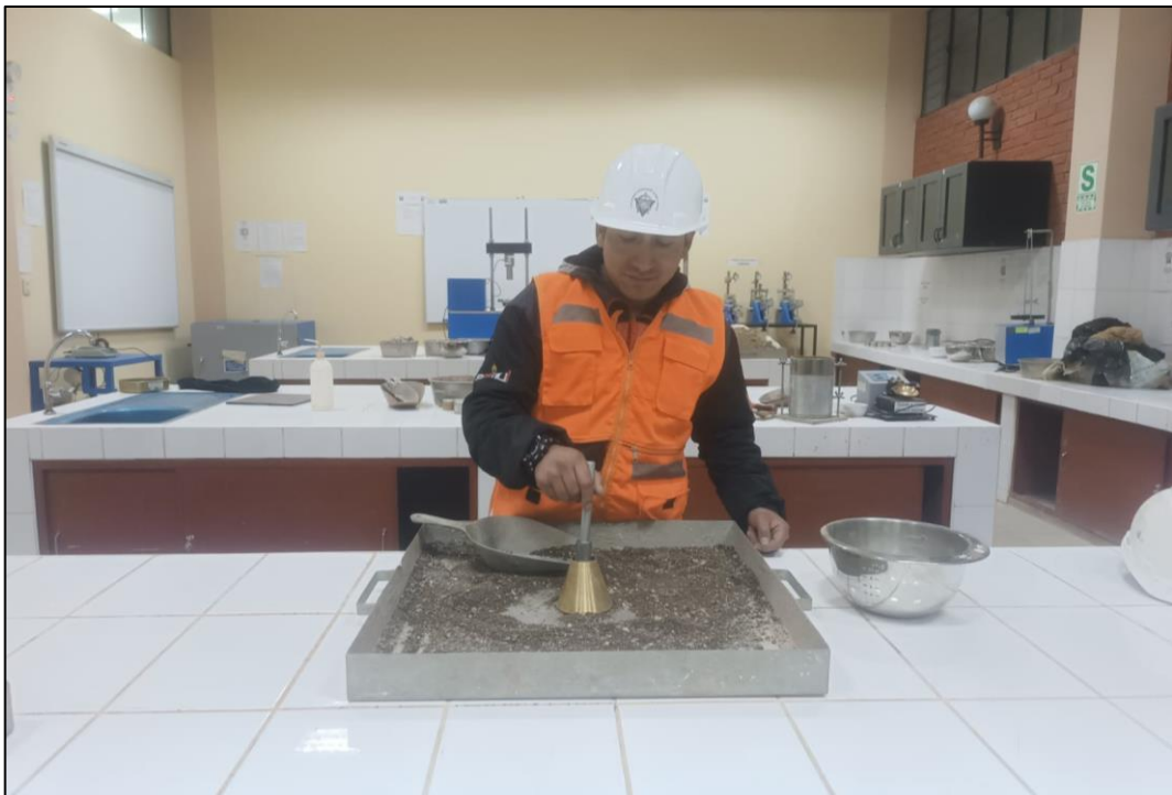
Fotografía 12. Se golpea la muestra suavemente 25 veces con la barra de metal.
