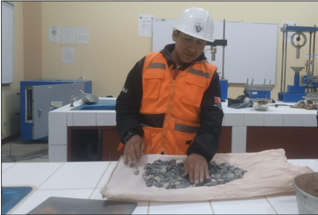
Fotografía 23. Se remueve la muestra del agua y hacerla rodar sobre un paño grande y absorbente, hasta hacer desaparecer toda película de agua visible.
