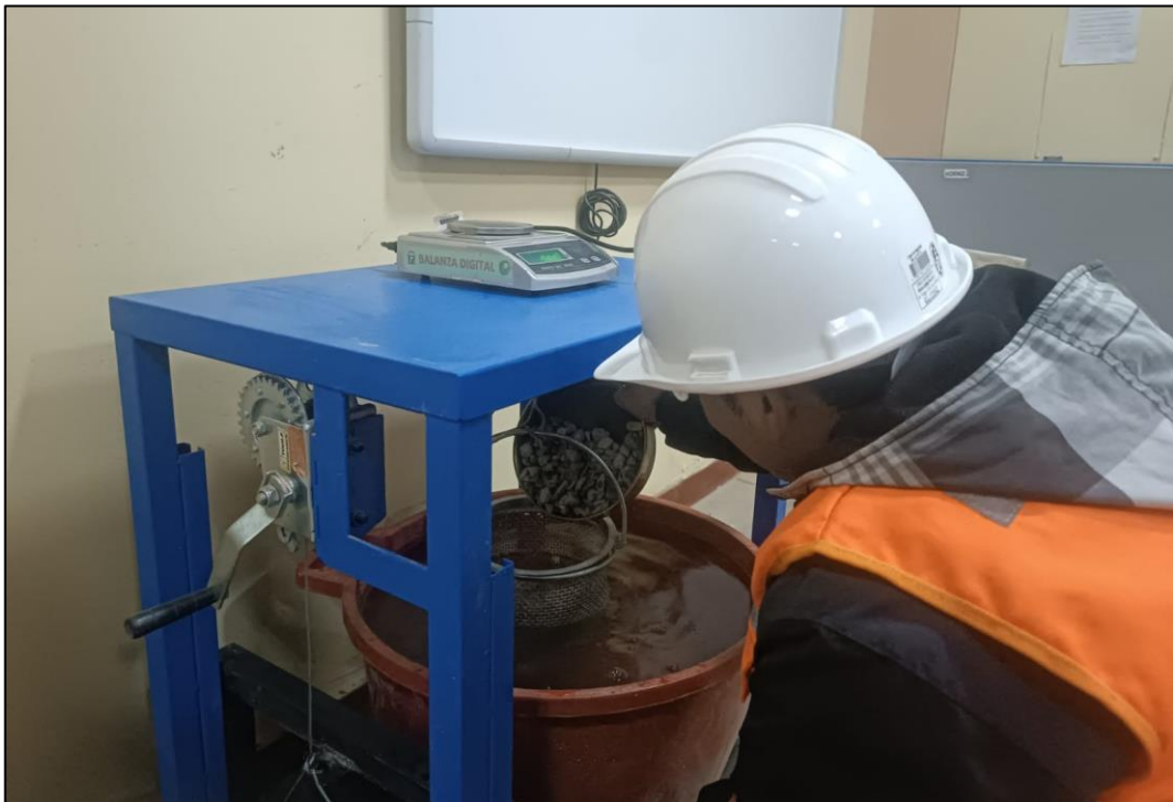
Fotografía 26. Colocación de la muestra en la cesta de alambre y se determina su peso a una temperatura entre 23 °C.
