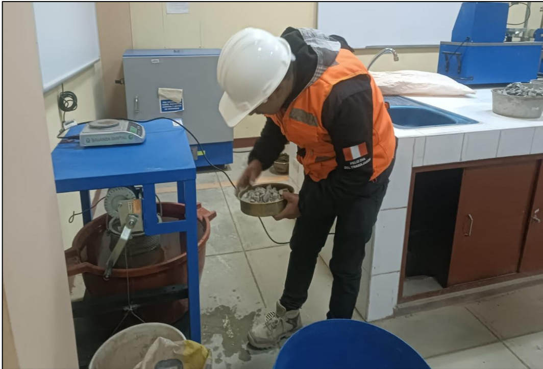
Fotografía 25. Se coloca de inmediato la muestra saturada en la cesta de alambre.
