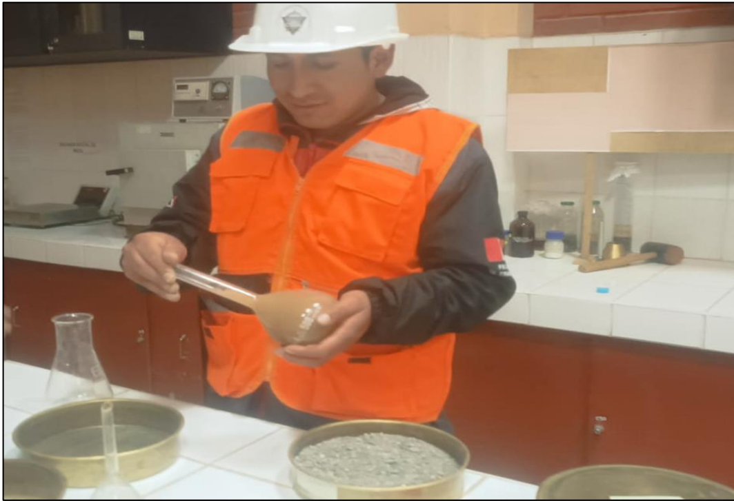
Fotografía 19. Se agita cuidadosamente y después de una hora se llena con agua hasta los 500 m 3 y se determina el peso total del agua introducido en el frasco.
