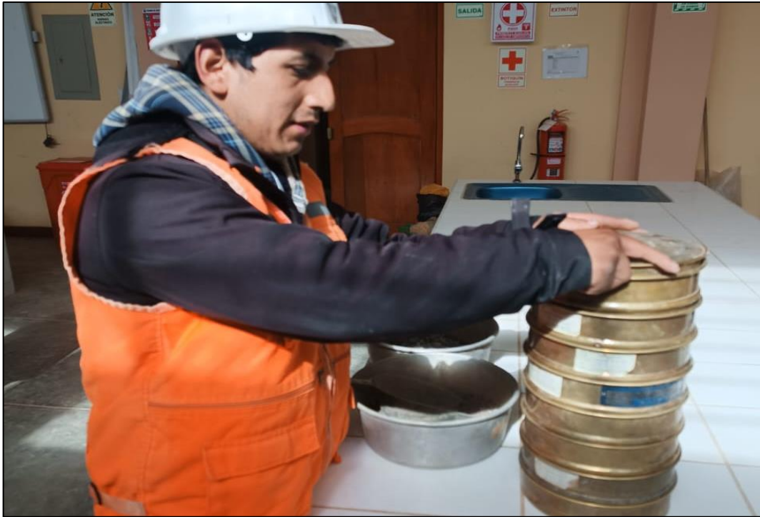
Fotografía 5. Ubicación de los tamices según la norma NTP 400.012
