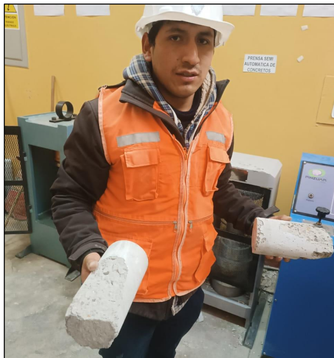
Fotografía 34. Resultados del ensayo a compresión de cada probeta, se puede observar los tipos de corte que se obtuvo.
