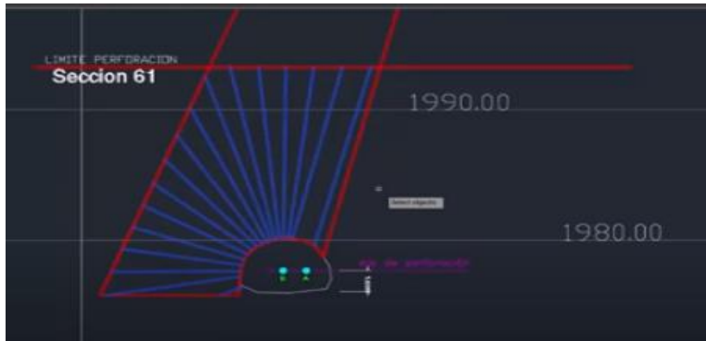
Figura 8: Malla de perforación radial de taladros largos.
