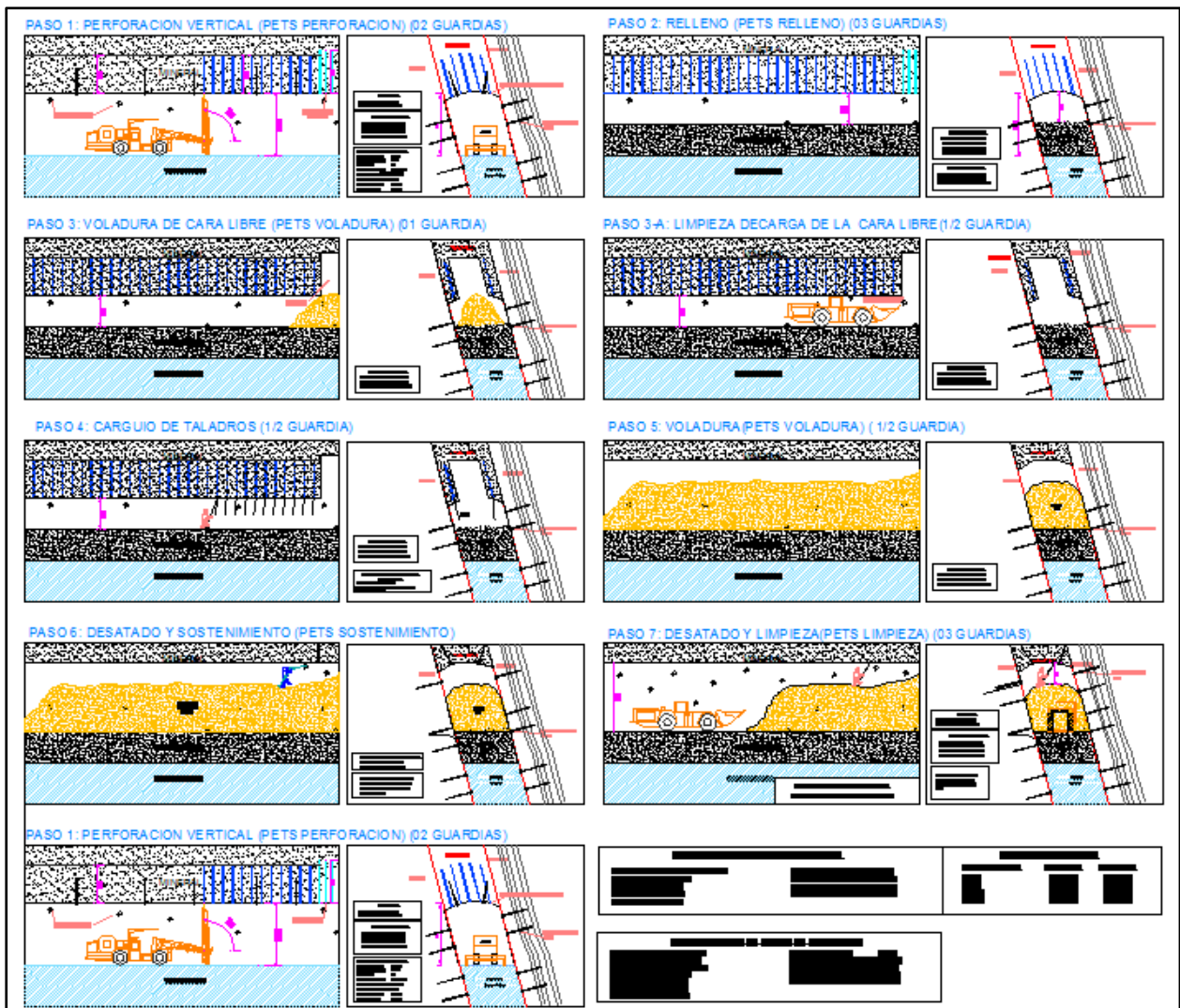
Figura 22: Ciclo del Método de Explotación Corte y Relleno
