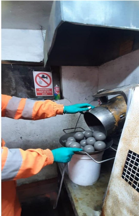
Fotografía 03: Preparación de mineral en el molino de Bond.
