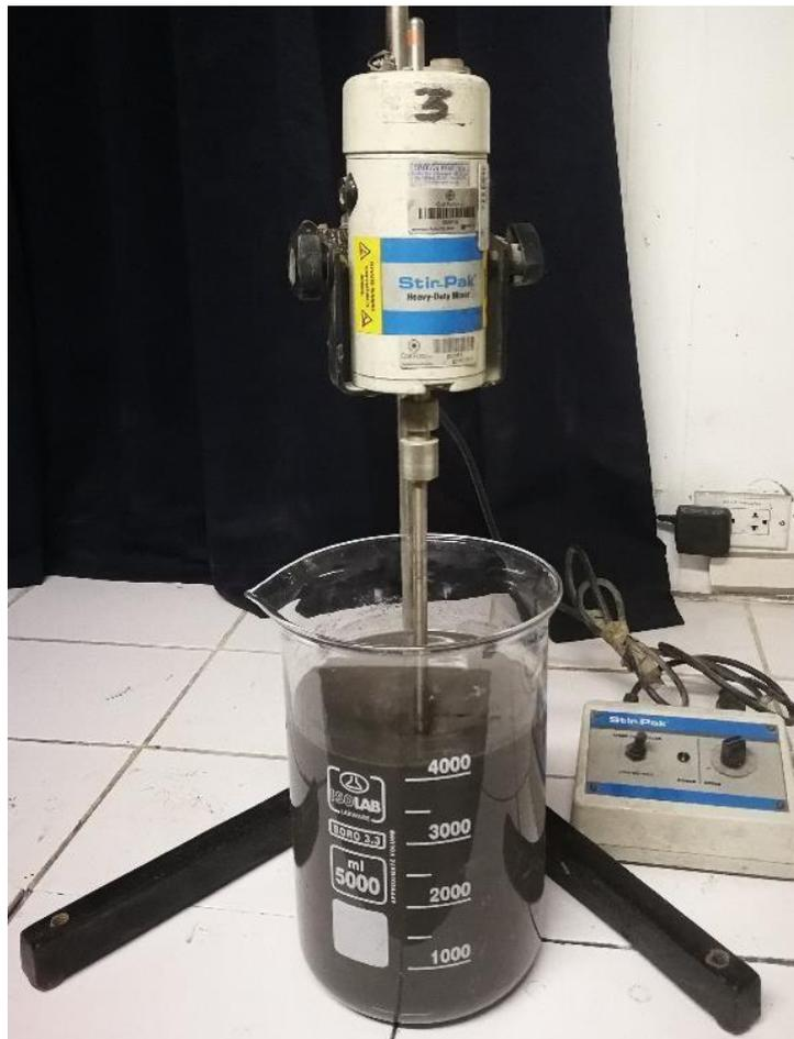
*Homogenizado de relave para poner a las probetas de un litro*
