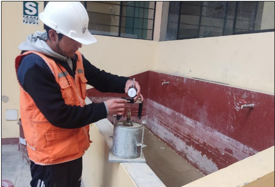
Fotografía 24. Se realiza la prueba del ensayo de CBR y esponjamiento del suelo natural y el suelo con tratamiento con el 4% de sal proteinada.
