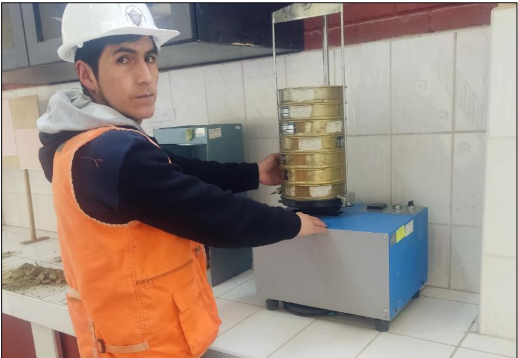
Fotografía 10. Procedimiento del tamizado para determinar la masa del material en cada tamiz.
