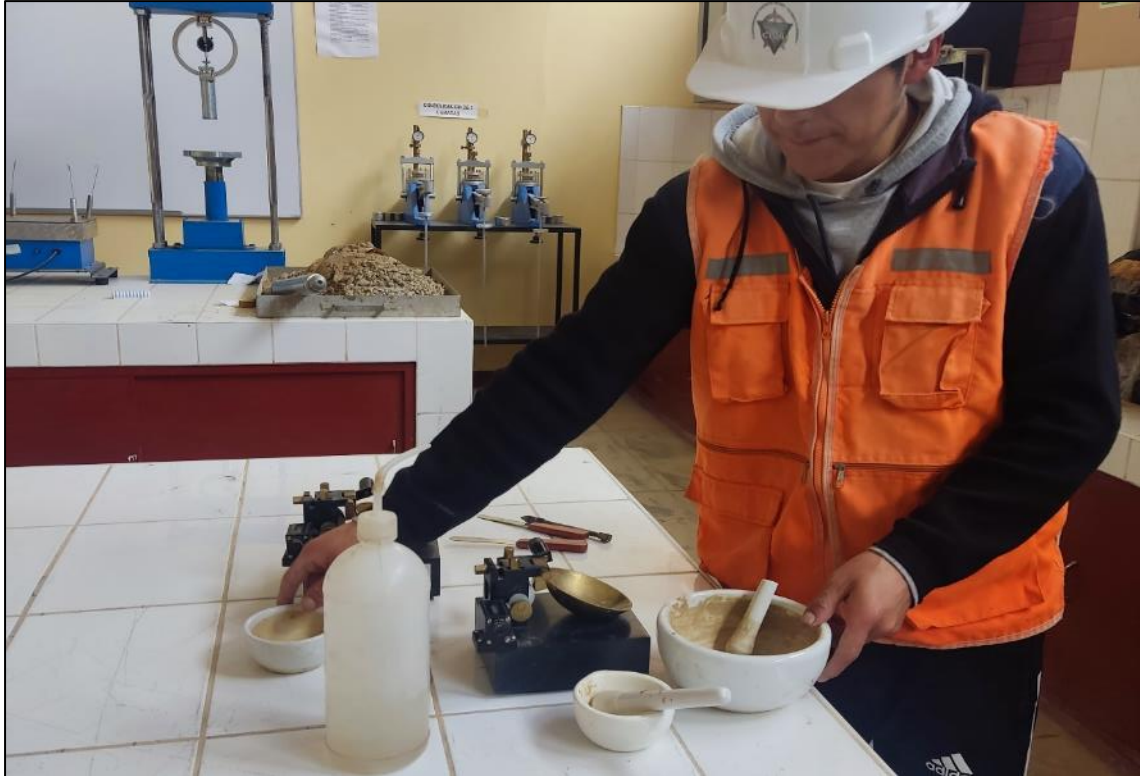
Fotografía 11. Se realiza el ensayo para obtener el límite líquido con la Copa de Casagrande del suelo natural y el suelo con tratamiento (sal proteinada).
