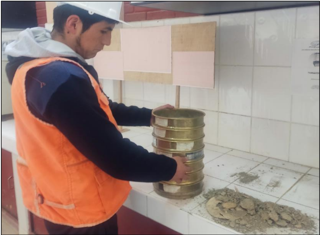
Fotografía 9. Tamices a utilizar para el ensayo de granulometría y otros fines.
