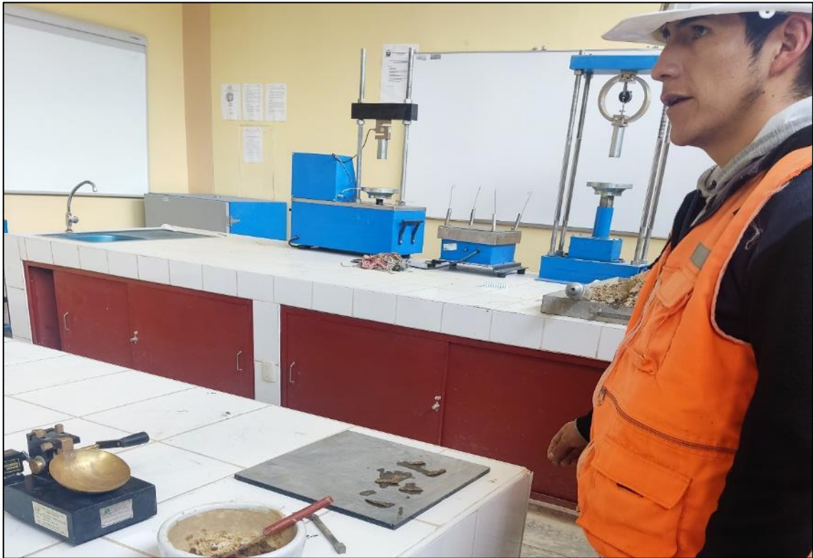
Fotografía 17. Se obtiene los resultados del límite de plasticidad del suelo natural y del suelo con tratamiento (sal proteinada). Y posteriormente hallar el índice de plasticidad.
