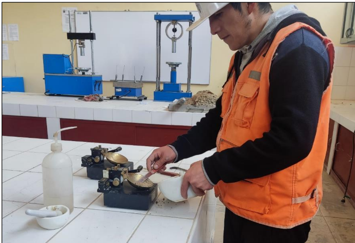
Fotografía 12. Se vierte la muestra para obtener el límite líquido con la Copa de Casagrande del suelo natural y el suelo con tratamiento (sal proteinada).
