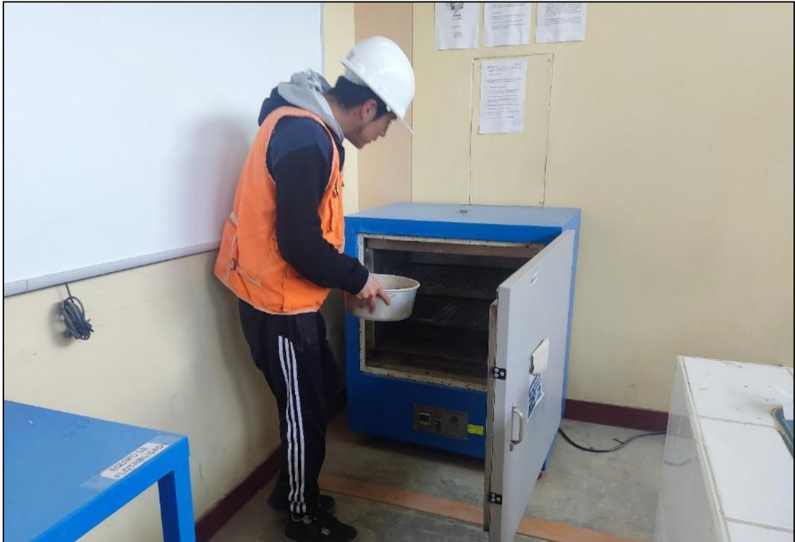
Fotografía 7. Traslado de las muestras al horno por 24 horas, para el comienzo de los ensayos respectivos.
