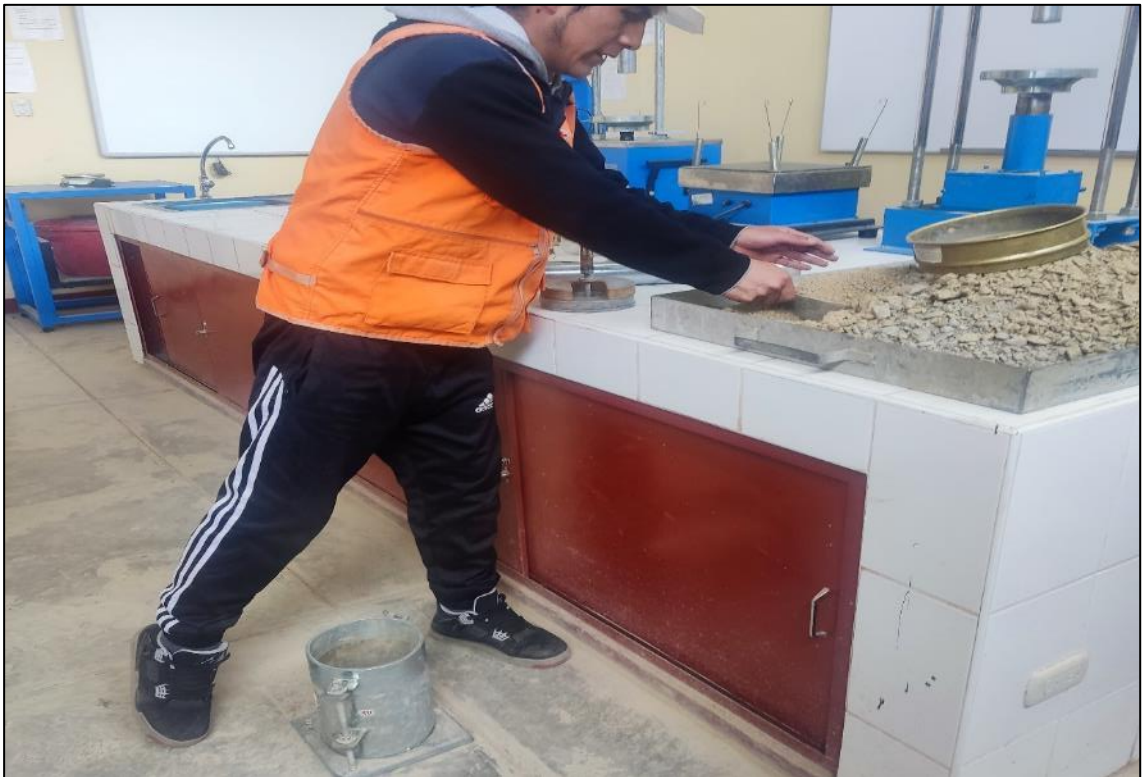
Fotografía 7. Se empieza a realizar la prueba con la compactación del suelo en tres capas, cada capa tubo 25 golpes de acuerdo al metodo que se utilizó para este ensayo.
