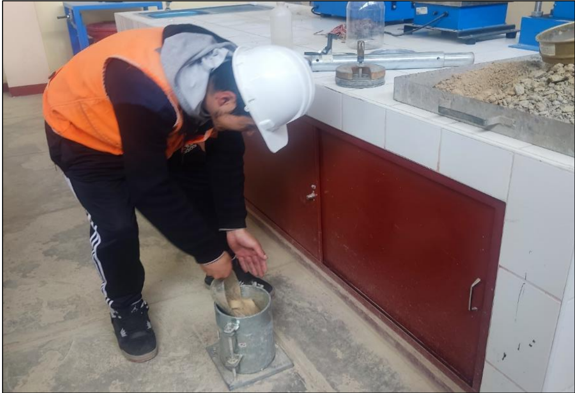
Fotografía 8. Se realiza la prueba con la compactación del suelo en tres capas, cada capa tubo 25 golpes de acuerdo al metodo que se utilizó para este ensayo.
