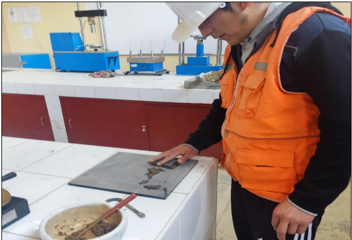
Fotografía 16. Se realiza el ensayo para obtener el límite de plasticidad del suelo natural y del suelo con tratamiento (sal proteinada). Y posteriormente hallar el índice de plasticidad.
