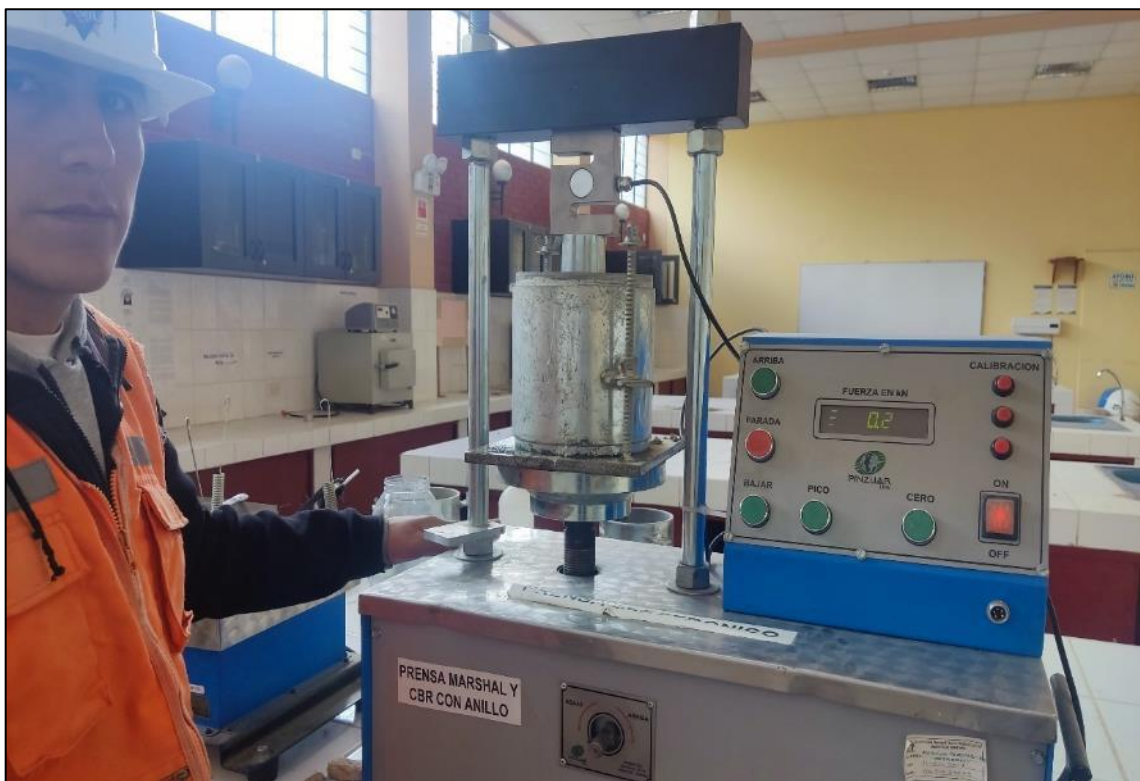
Fotografía 28. Resultados de las pruebas del CBR para el suelo natural y el suelo con tratamiento con el 4% de sal proteinada
