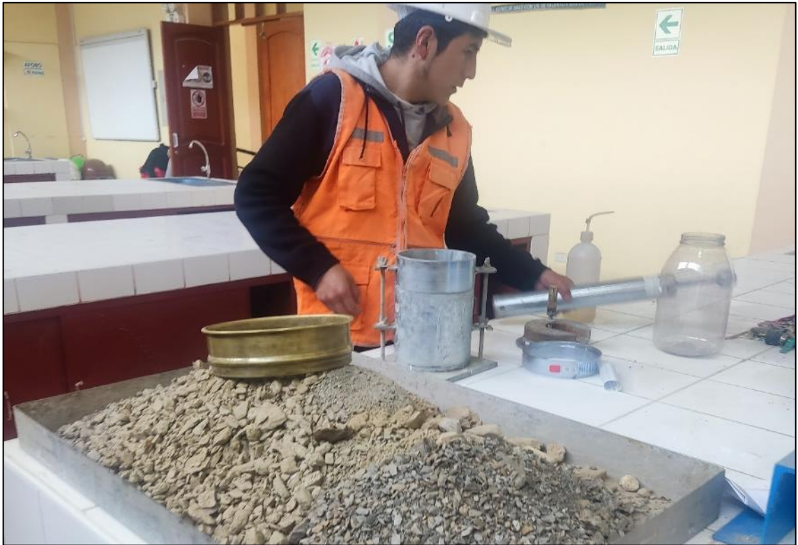
Fotografía 19. Materiales a usar para realizar el ensayo del proctor modificado del suelo natural y el suelo con tratamiento.
