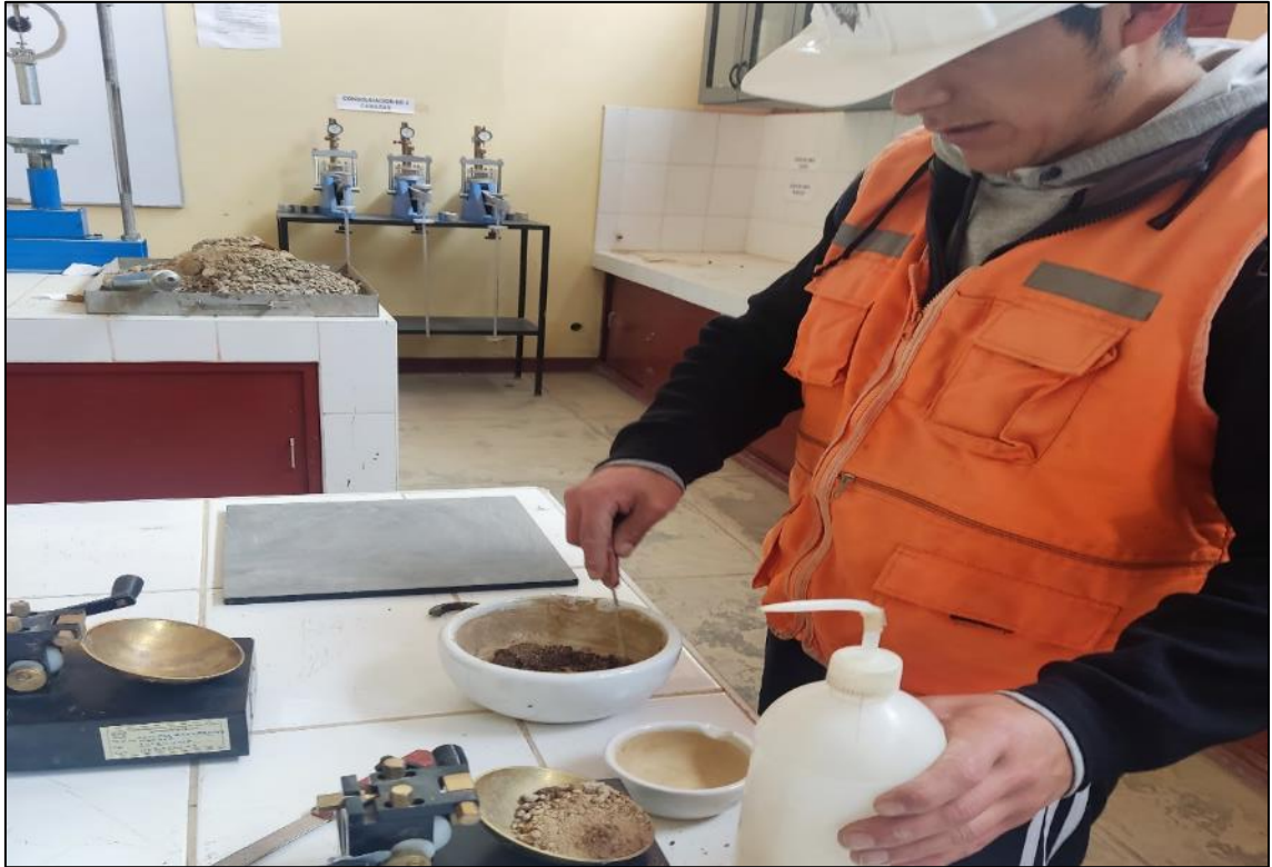
Fotografía 15. Se remueve la muestra para el ensayo para obtener el límite de plasticidad del suelo natural y del suelo con tratamiento (sal proteinada). Y posteriormente hallar el índice de plasticidad.
