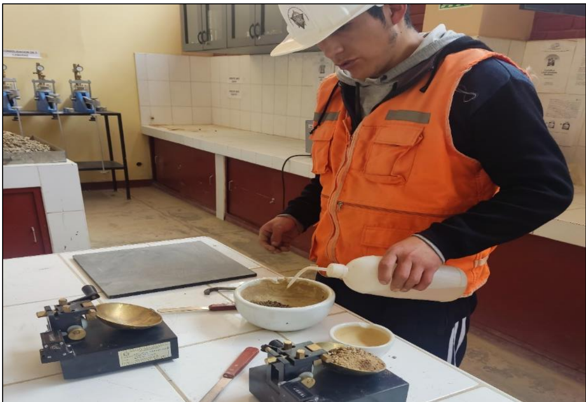
Fotografía 14. Se empieza a realizar el ensayo para obtener el límite de plasticidad del suelo natural y del suelo con tratamiento (sal proteinada). Y posteriormente hallar el índice de plasticidad.
