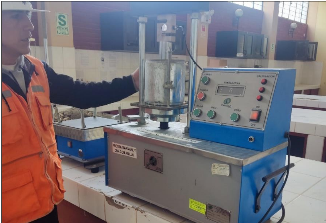
Fotografía 27. Se realiza la prueba del CBR para el suelo natural y el suelo con tratamiento con el 4% de sal proteinada.
