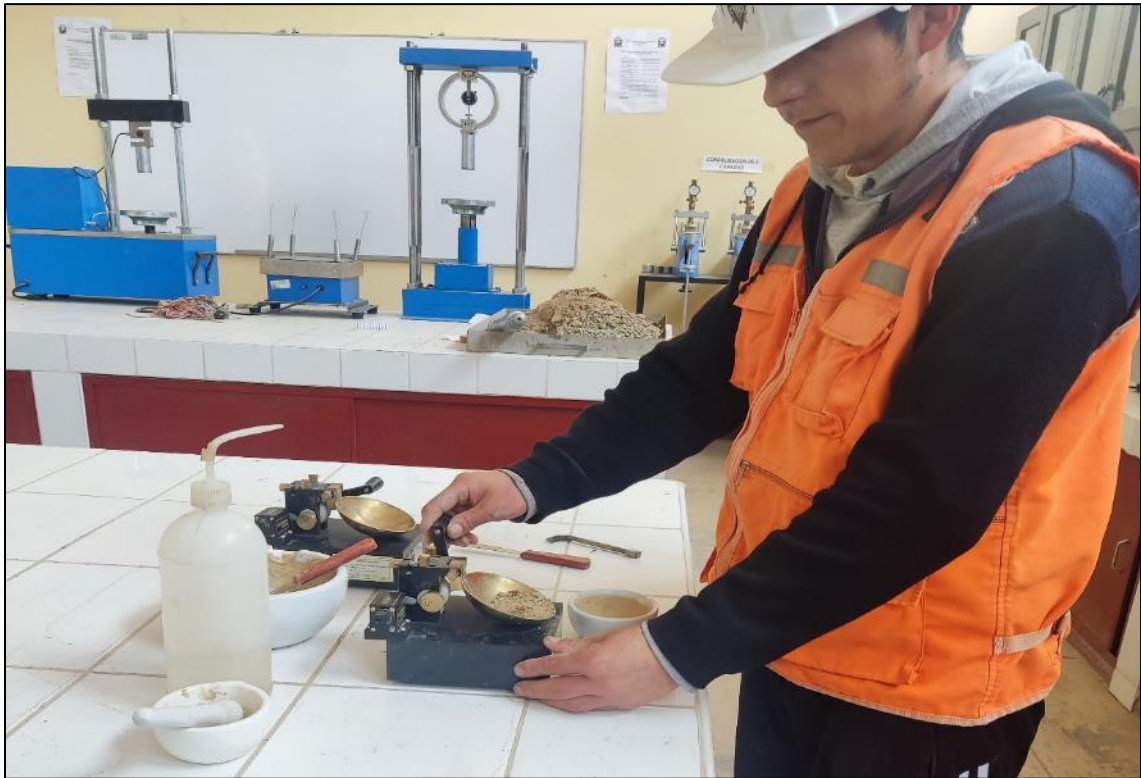
Fotografía 13. Se realiza la prueba realizando los golpes correspondientes para obtener el límite líquido con la Copa de Casagrande del suelo natural y el suelo con tratamiento (sal proteinada).
