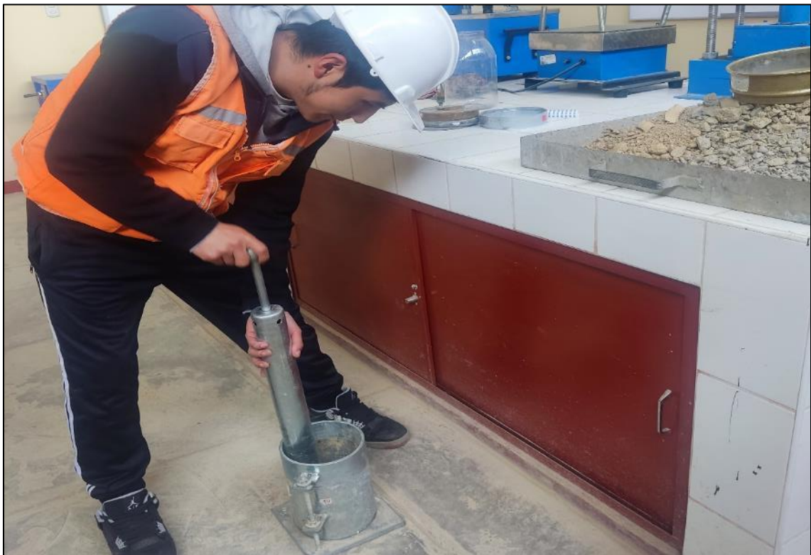
Fotografía 22. Se realiza la prueba con la compactación del suelo en tres capas, cada capa tubo 25 golpes de acuerdo al metodo que se utilizó para este ensayo.
