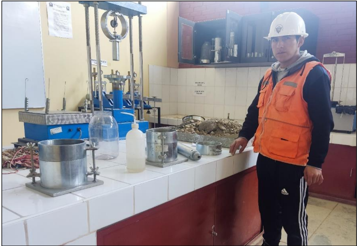
Fotografía 23. Materiales para realizar el ensayo de CBR del suelo natural y el suelo con tratamiento con el 4% de sal proteinada.
