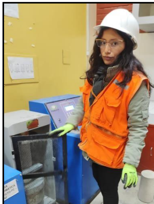
Fotografía 22. Resistencia a la compresión de las probetas.
