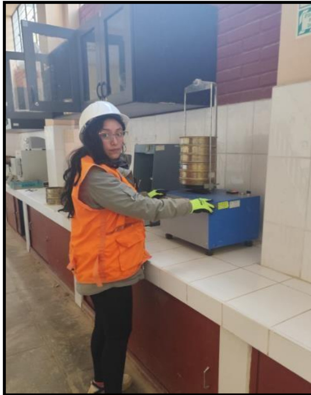
Fotografía 8. Tamizando el caucho reciclado.
