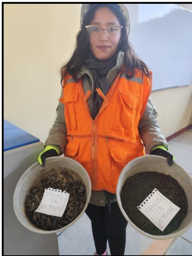
Fotografía 17. Ensayo de la absorción y peso específico del agregado fino.
