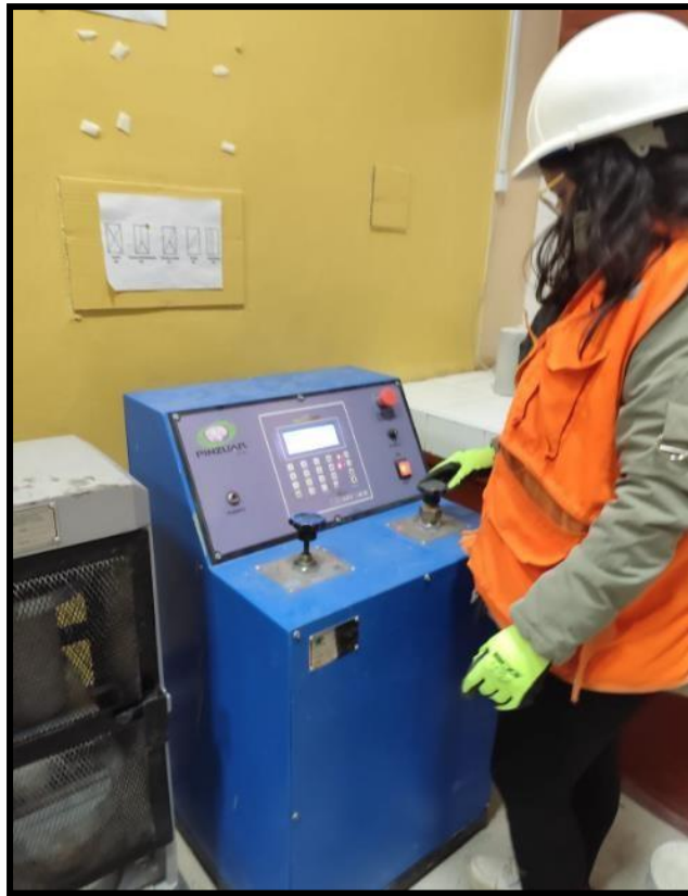
Fotografía 23. Manejo del equipo para el ensayo de compresión.
