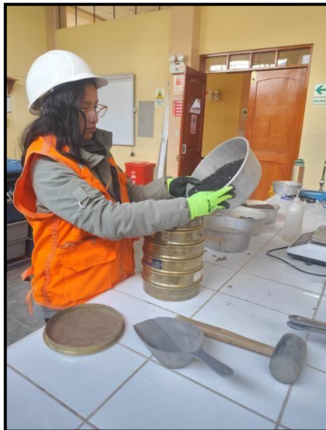
Fotografía 6. Análisis Granulométrico del Caucho Reciclado.
