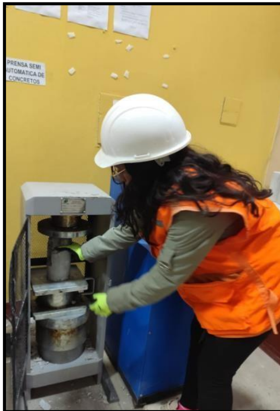
Fotografía 24. Falla de la probeta cilíndrica.
