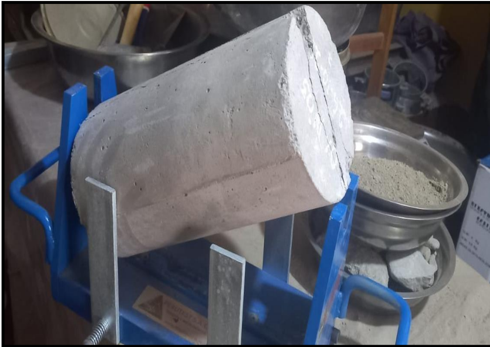
Fotografía 27. Falla obtenida por el ensayo de resistencia a tracción.
