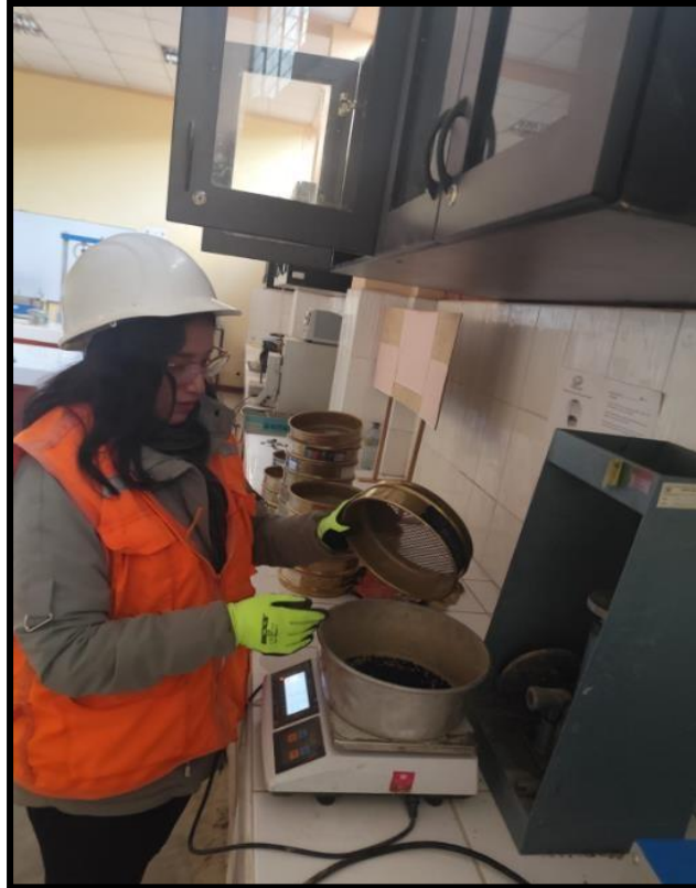
Fotografía 11. Se pesa el porcentaje de caucho reciclado en cada malla.
