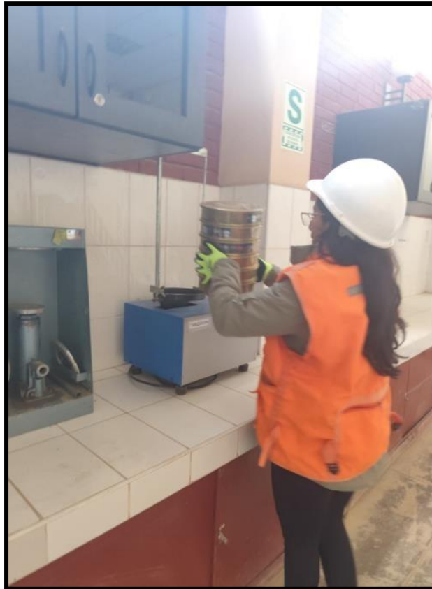
Fotografía 7. Llevando el caucho reciclado a la tamizadora.
