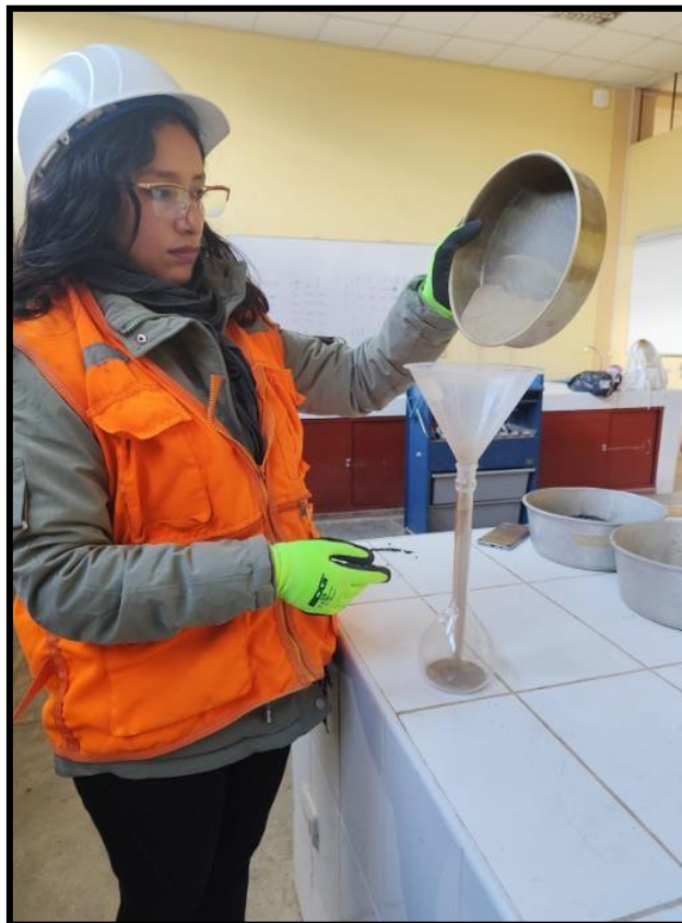
Fotografía 16. Ensayo del peso específico y absorción del agregado fino.
