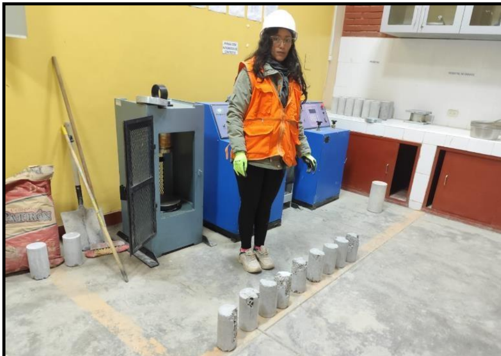
Fotografía 26. Resultados del ensayo de resistencia a la compresión a los 7, 14 y 28 días de curado.
