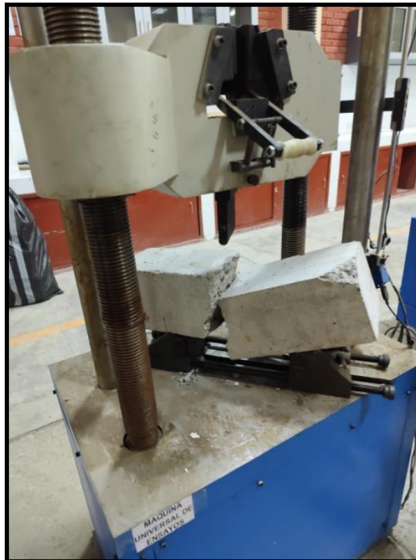
Fotografía 30. Resultados obtenidos por el ensayo a flexión de las probetas prismáticas.
