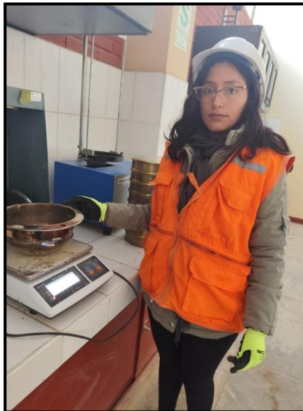
Fotografía 11. Se pesa el porcentaje de caucho reciclado en cada malla.
