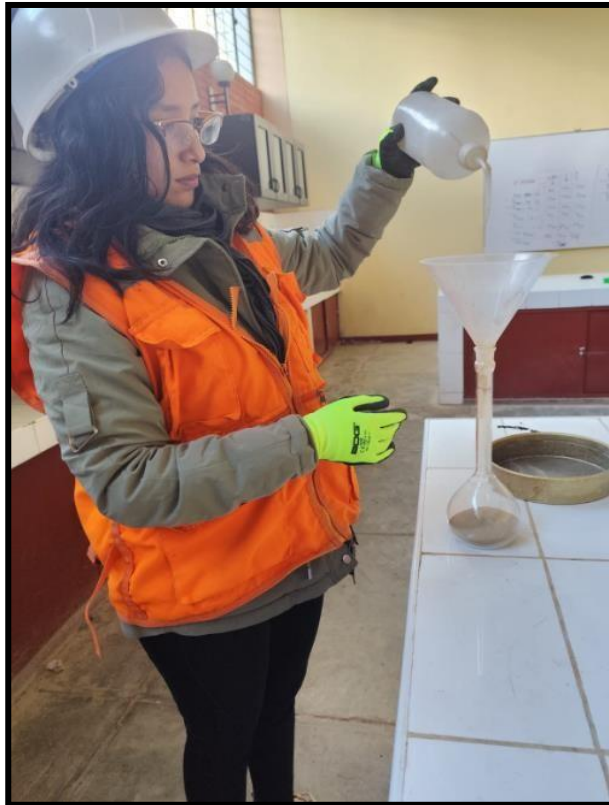
Fotografía 17. Ensayo de la absorción y peso específico del agregado fino.
