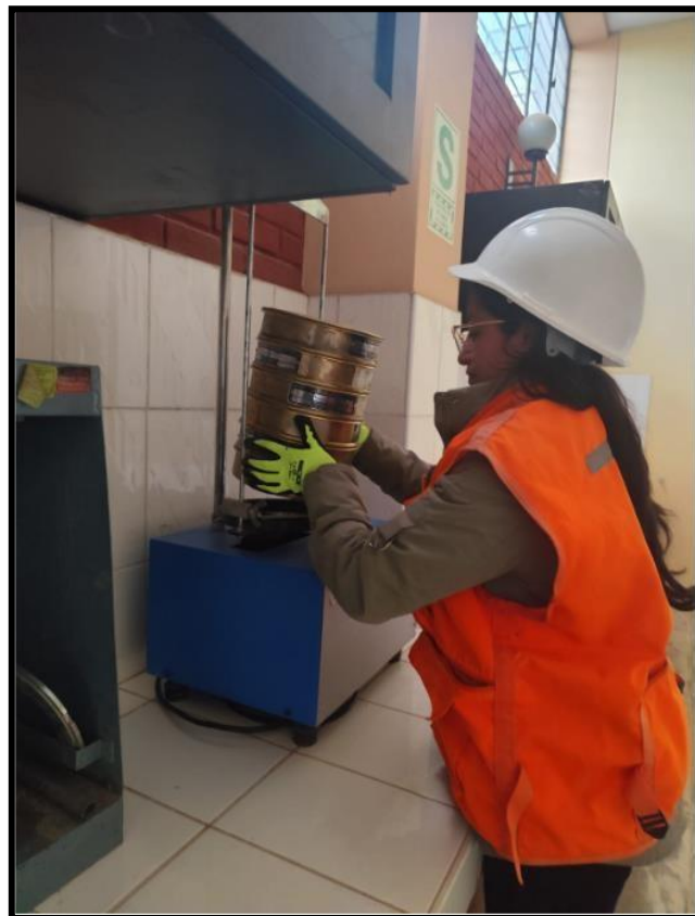
Fotografía 4. Llevando los agregados a la tamizadora.
