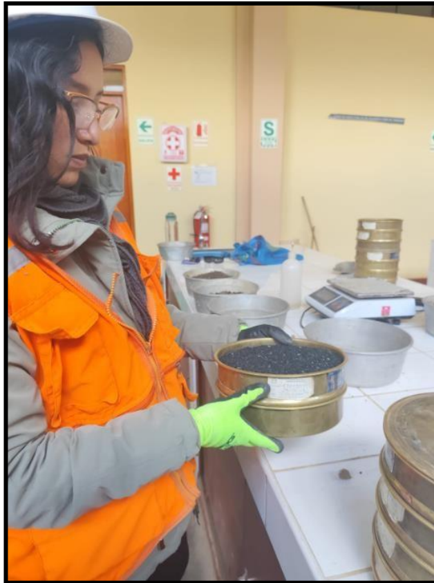
Fotografía 9. Se empieza a pesar por tamiz al caucho reciclado.
