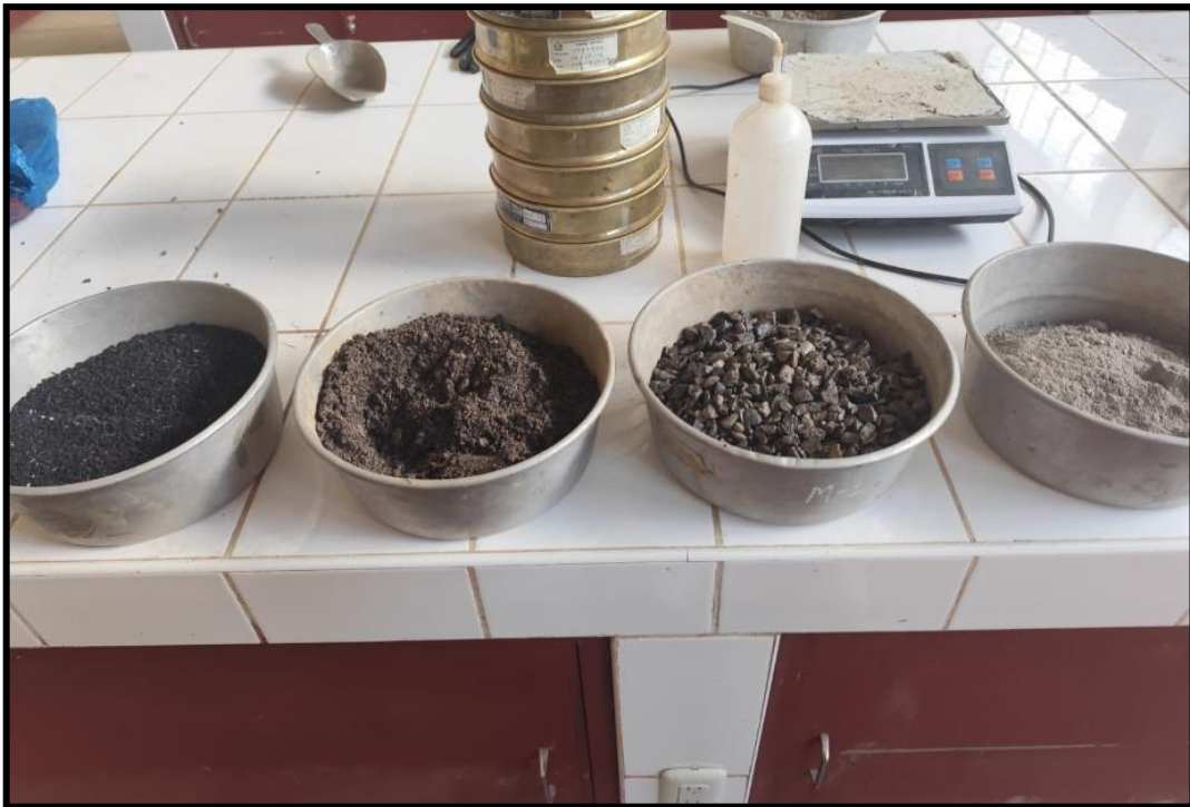
Fotografía 1. Agregado fino, grueso y caucho reciclado
