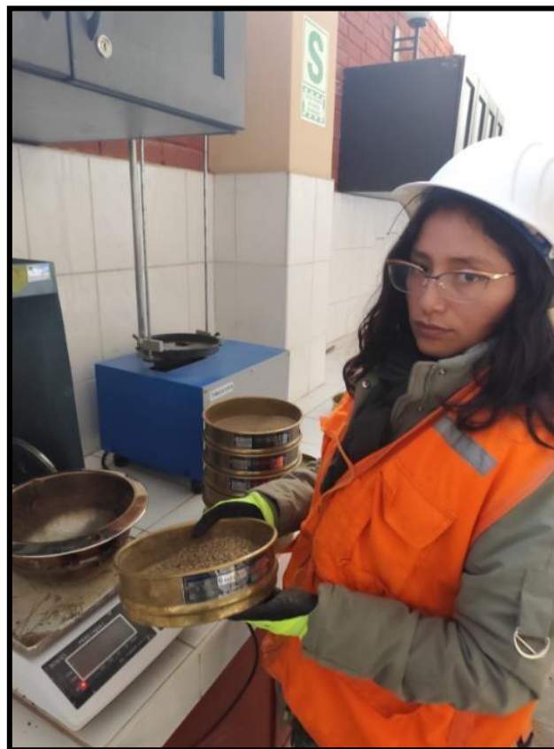
Fotografía 13. Peso del agregado grueso después de tamizar.
