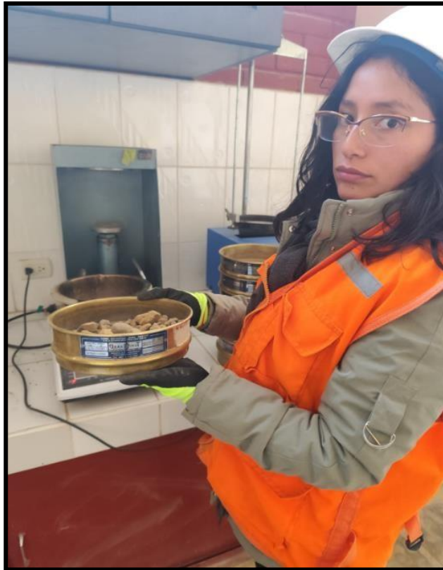
Fotografía 13. Peso del agregado grueso después de tamizar.
