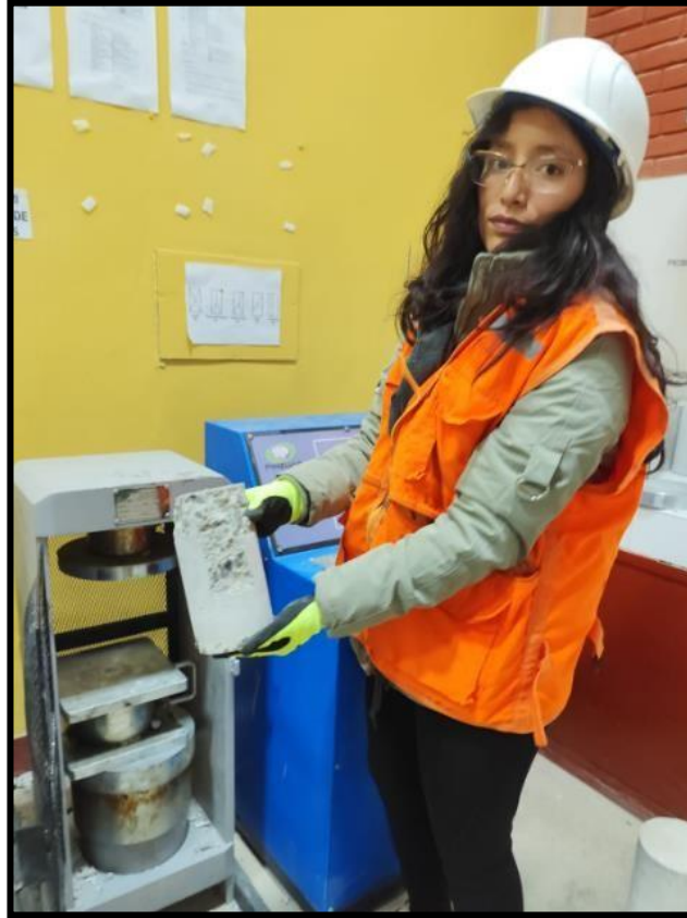
Fotografía 25. Falla de la probeta cilíndrica tipo corte.
