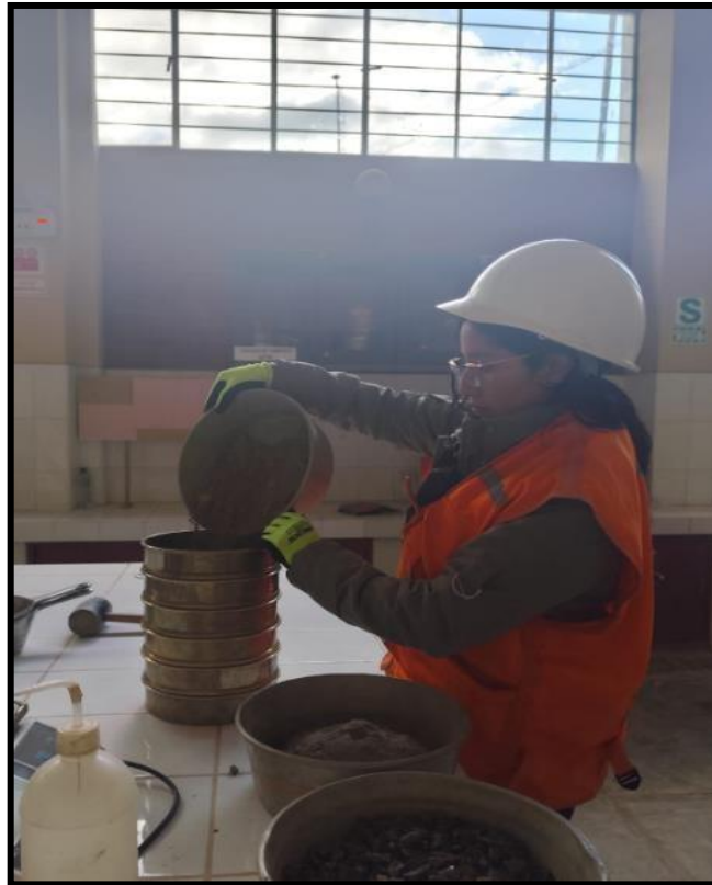
Fotografía 3. Ensayo del Análisis Granulométrico de los Agregados
