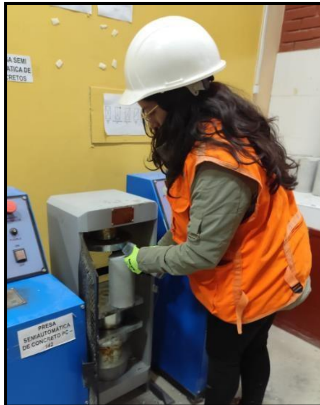
Fotografía 21. Resistencia a la compresión de las probetas cilíndricas.
