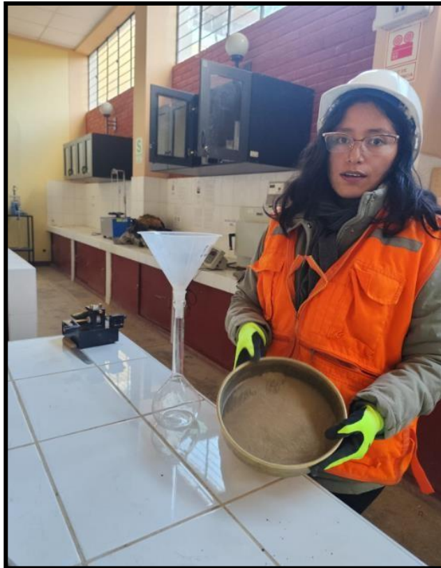
Fotografía 15. Ensayo del Peso específico y absorción del agregado fino.
