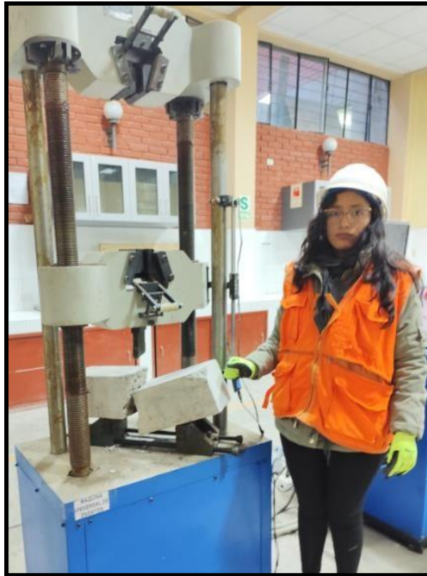
Fotografía 29. Falla obtenida por la resistencia a la flexión.
