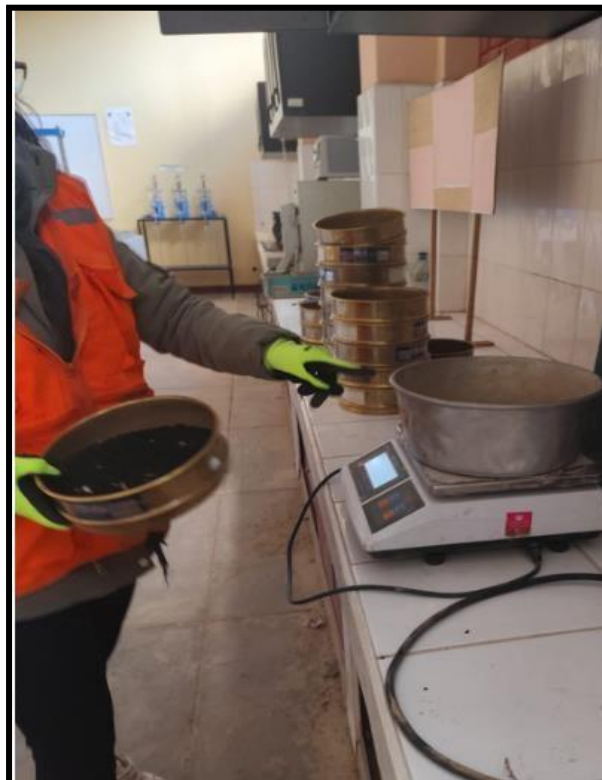
Fotografía 9. Se empieza a pesar por tamiz al caucho reciclado.
