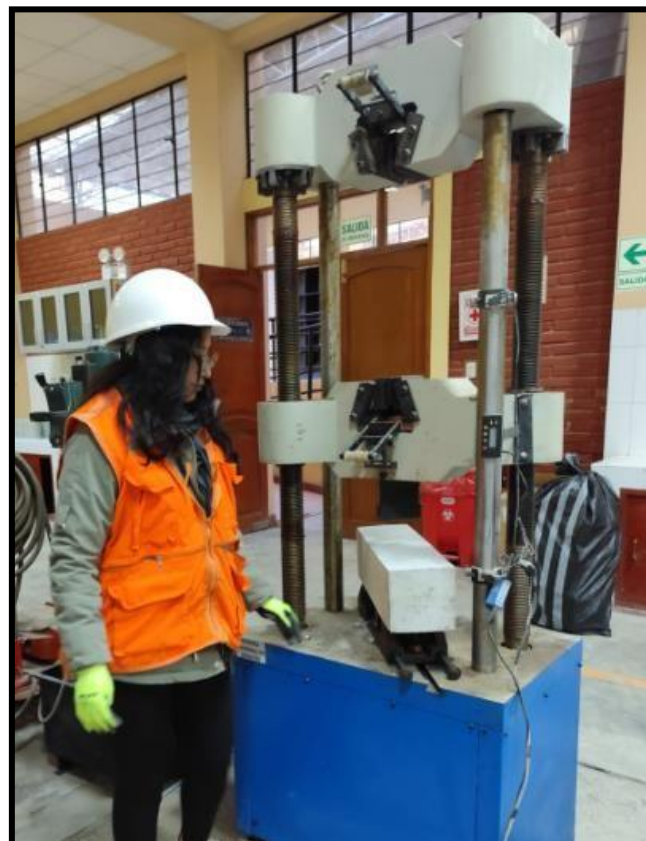
Fotografía 28. Ensayo para la resistencia a la flexión.
