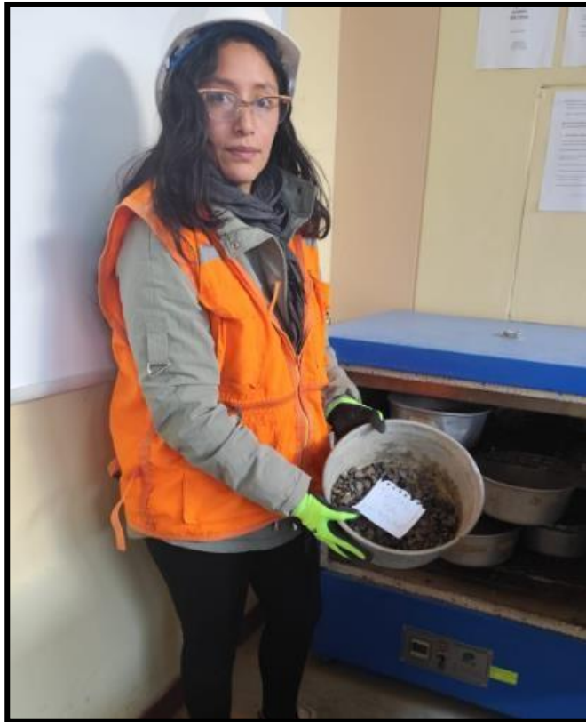
Fotografía 19. Los agregados son llevados al horno con temperatura indicada en las normas.
