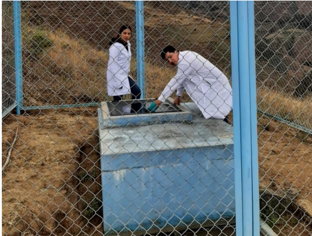
Figura 10 Toma de muestra en el tanque de almacenamiento de agua potable
