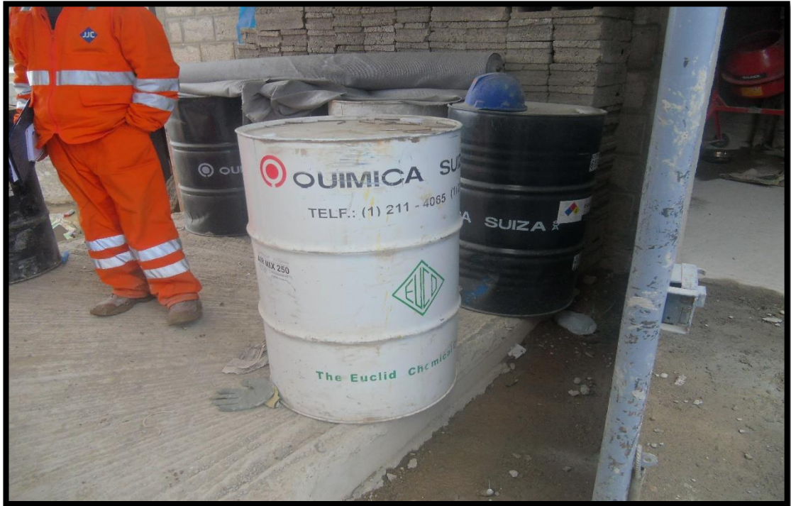
Foto N°03: Aditivos a usar en Planta Concretera de Rancas.
