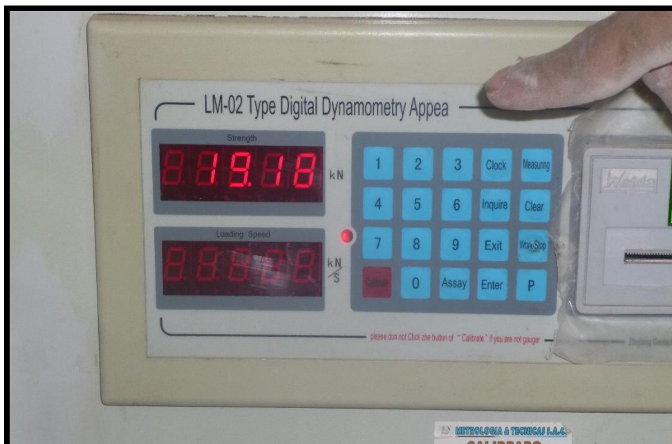
Foto N°08: Indicador digital de la prensa para rotura de probetas, que indica la resistencia del concreto.
