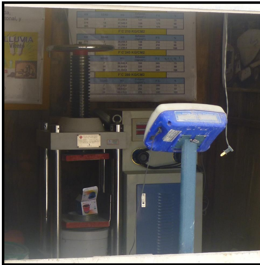
Foto N°07: Prensa para rotura de probetas.
