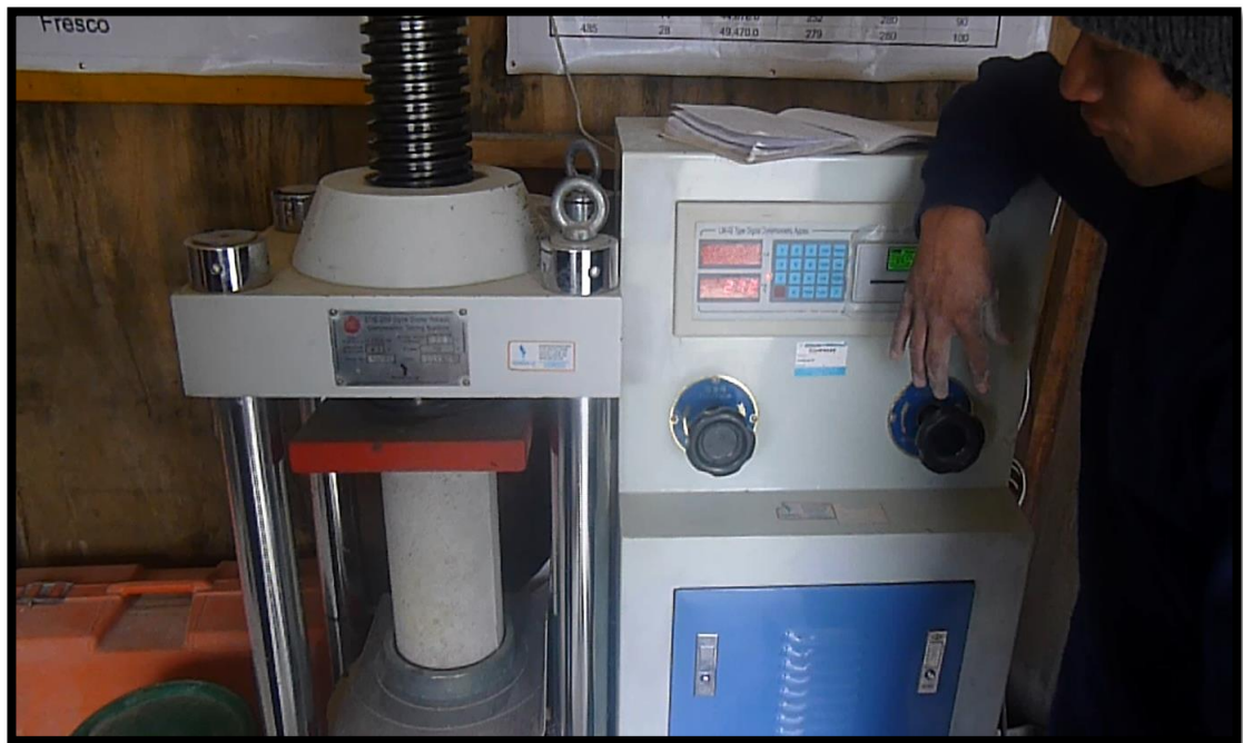
Foto N°09: Ensayo de rotura de probetas.
