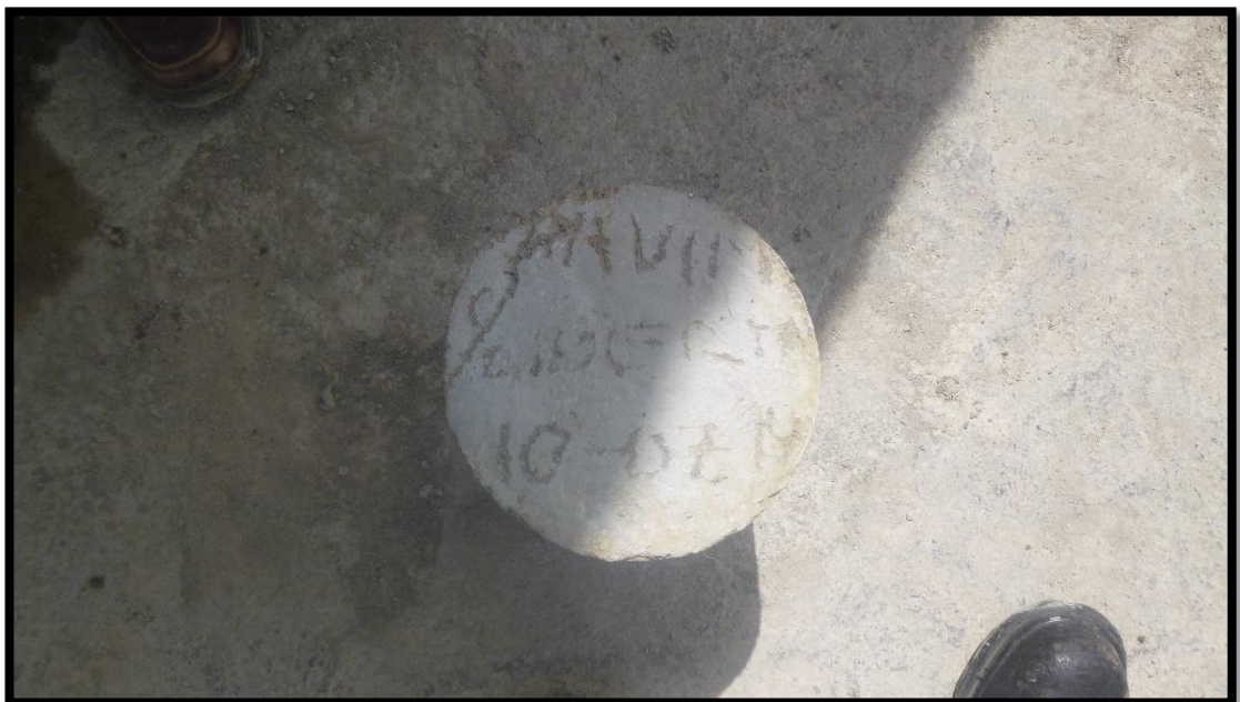
Foto N°06: Testigo de concreto a ensayar en la rotura de probetas.
