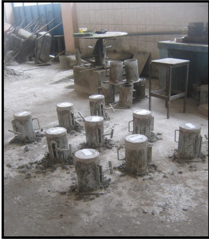
Foto N°05: Testigos de concreto para realizar los ensayos de compresión respectivos.
