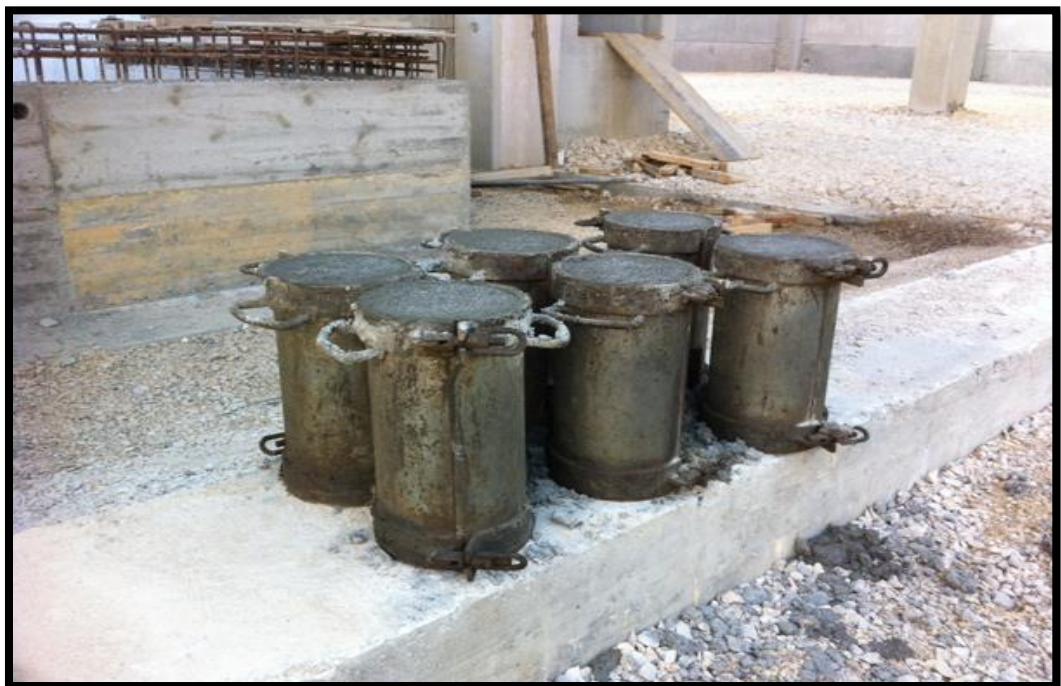
Foto N°08: Muestras de concreto vaciadas para el Ensayo de Resistencia
