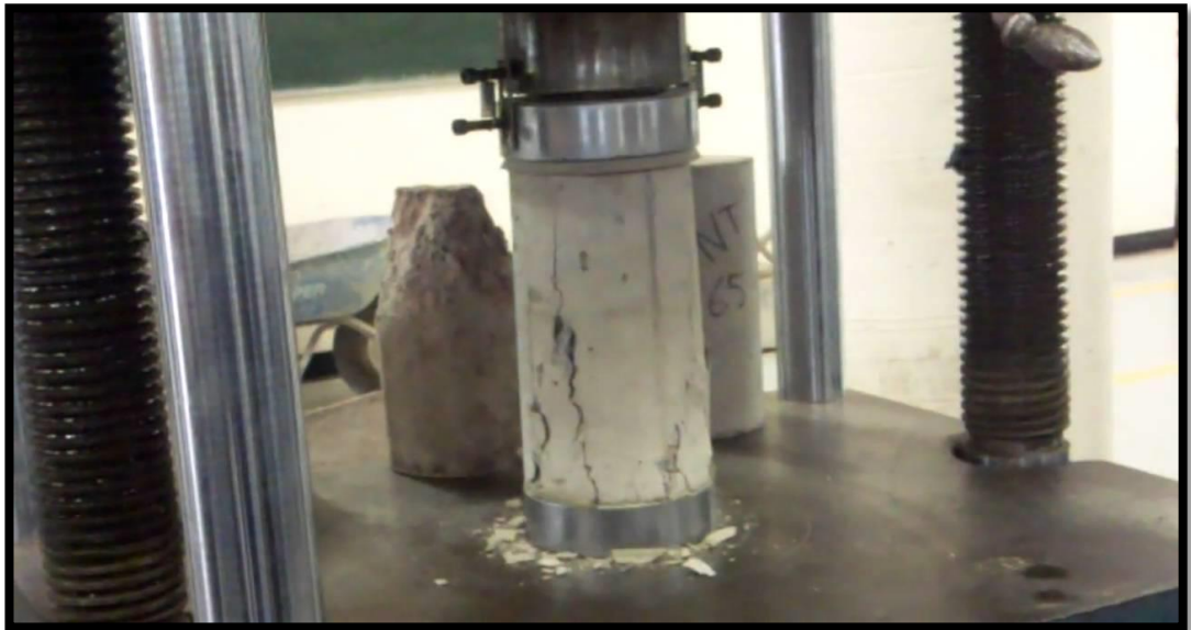
Foto N°10: Ensayo de la resistencia a la compresión.
