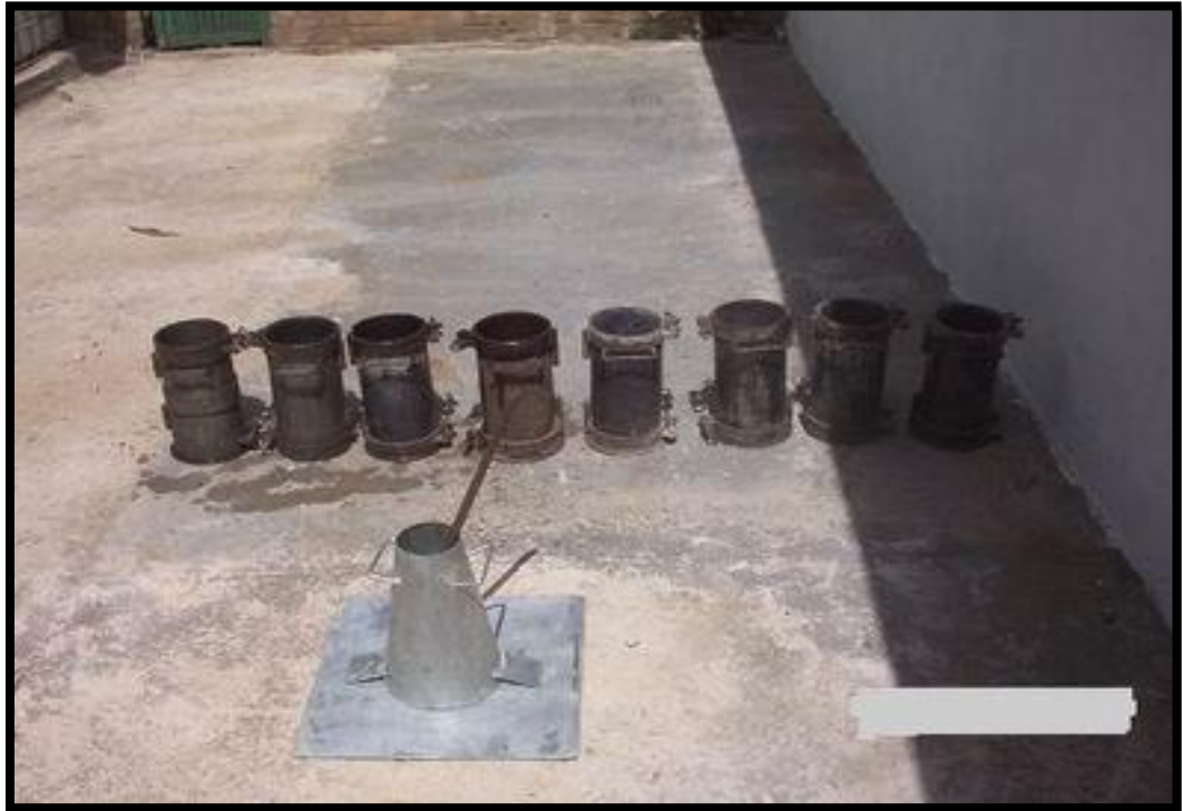
Foto N°07: Probetas para el ensayo de resistencia.
