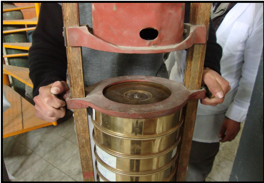
Foto N°02: Ensayo de granulometría.
