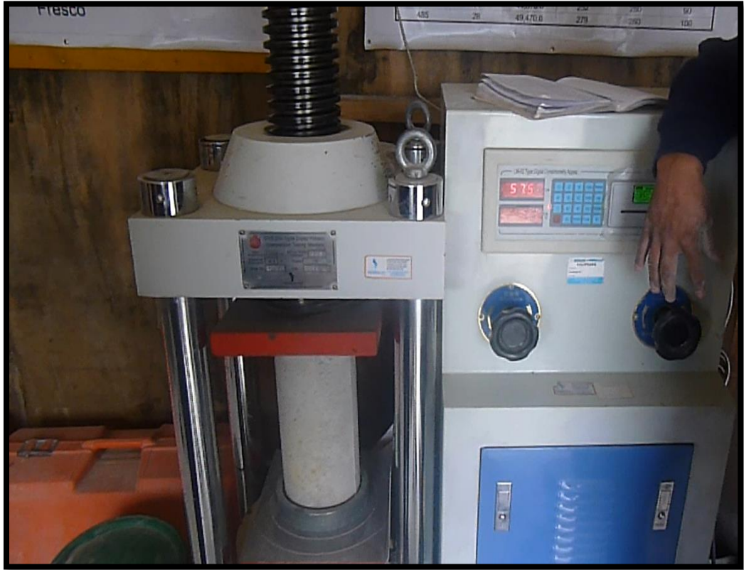
Foto N°09: Ensayo de la resistencia a la compresión.
