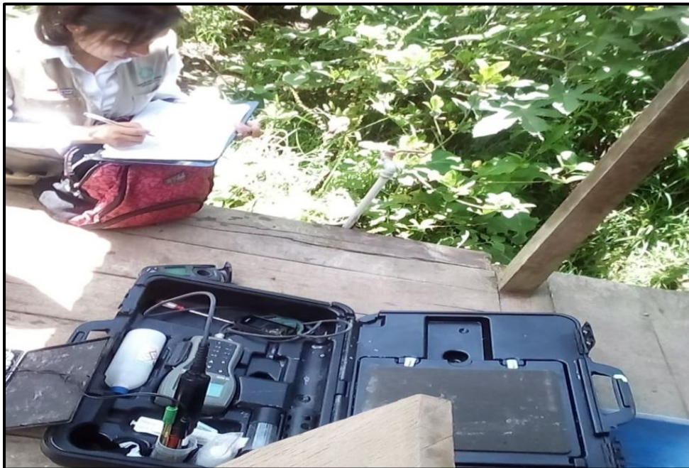
Fotografía N° 61: Medición de parámetros de campo de la muestra N° 03 conexión domiciliaria Gonzales Soto
