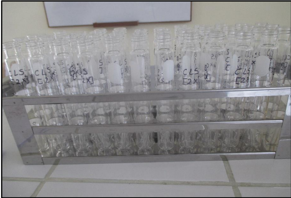
Fotografía N° 19: Preparación de la batería de tubos con series de 5 tubos a concentración doble y 10 tubos a concentración simple
