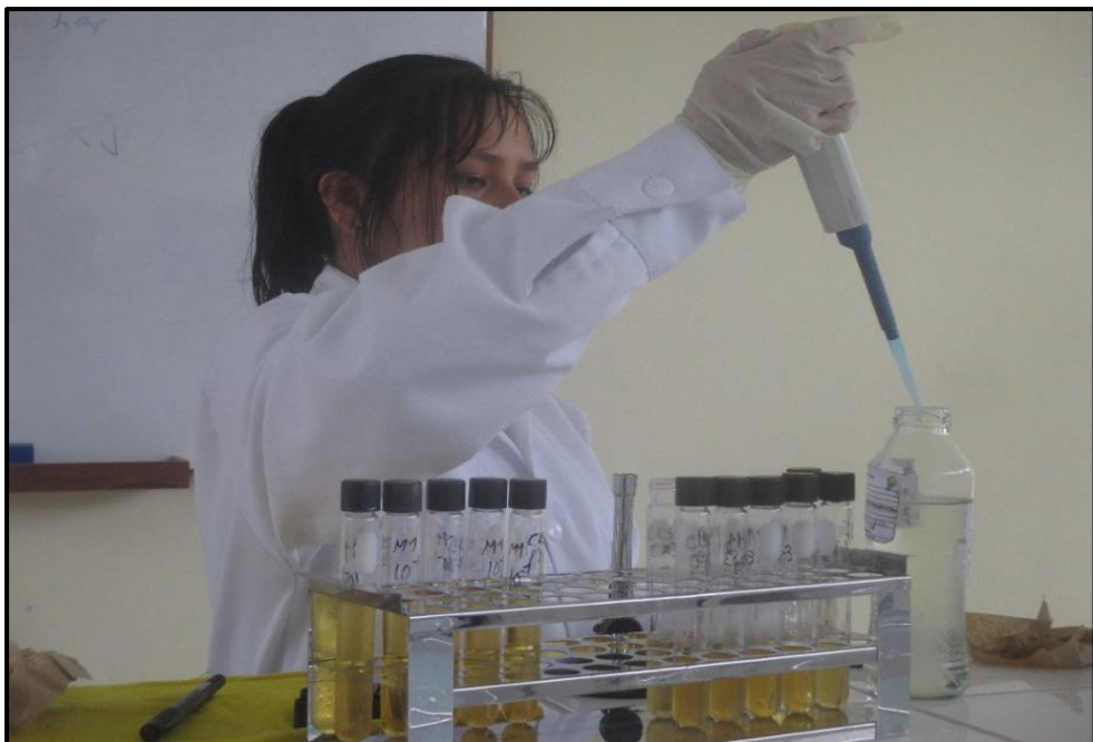
Fotografía N° 68: Siembra de muestra de agua al tubo con medio Caldo Lauril Sulfato en menor volumen
