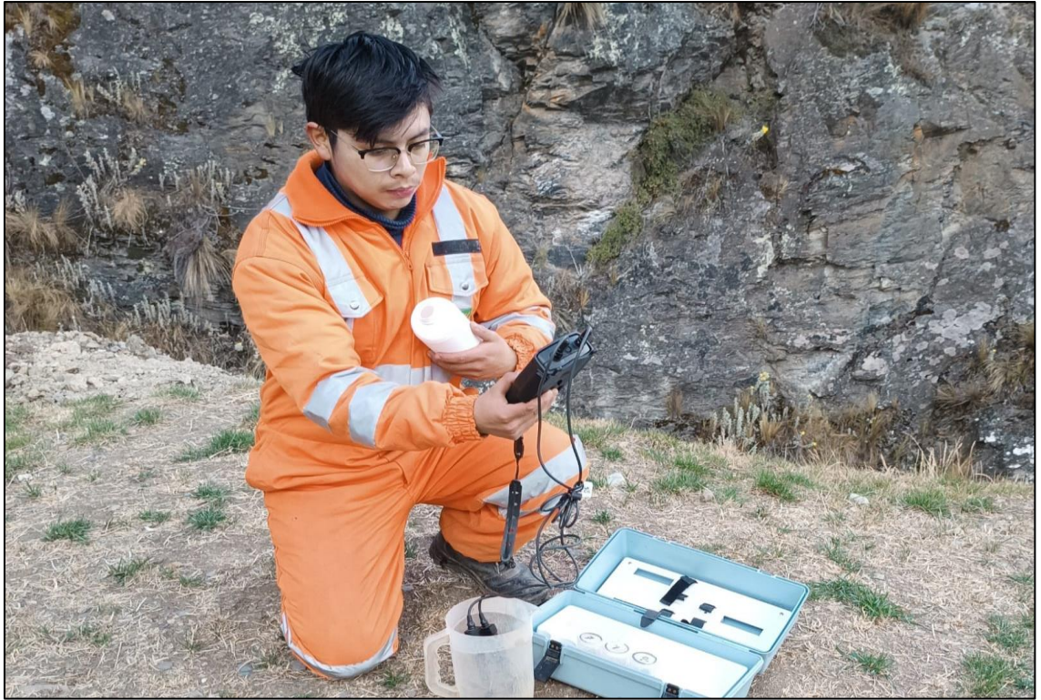
Ilustración 11: Monitoreo In -Situ utilizando equipo Multiparámetro.
