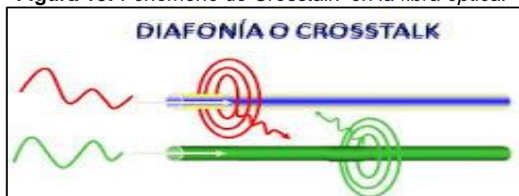
Figura 18: Fenómeno de Crosstalk en la fibra óptica.
