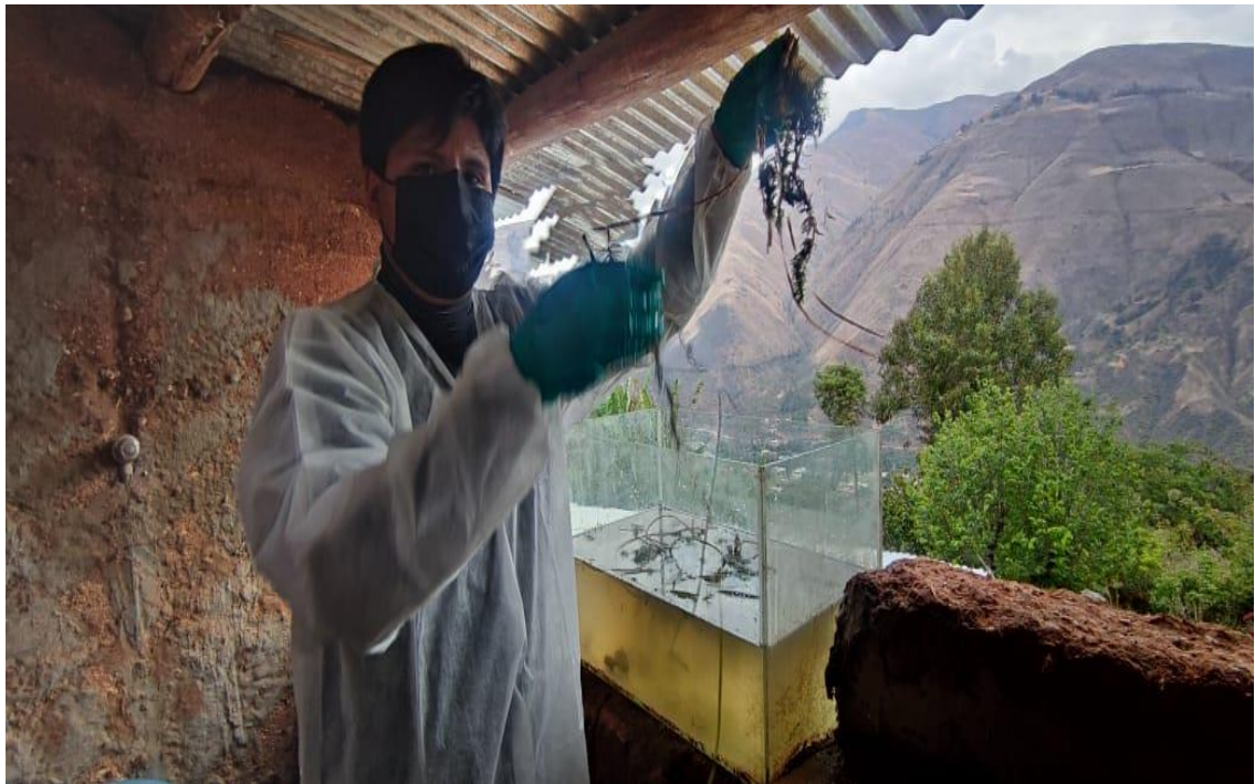
FOTOGRAFIA N° 07: Presentación de una de las muestras de la Elodea Canadensis antes de ser introducida al recipiente que contiene la solución metálica
