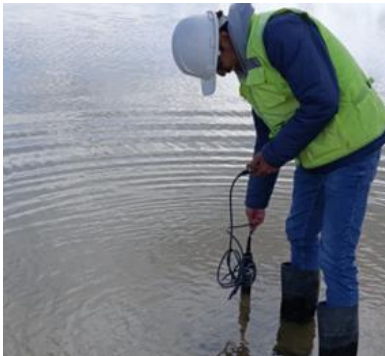
Fotografía 8: H, Medición de Parámetros Físico - Químicos In Situ del pto. PMPH-12
