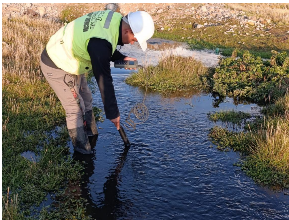
Fotografía 4: H, Medición de Parámetros Físico - Químicos In Situ del pto. PMPH-7
