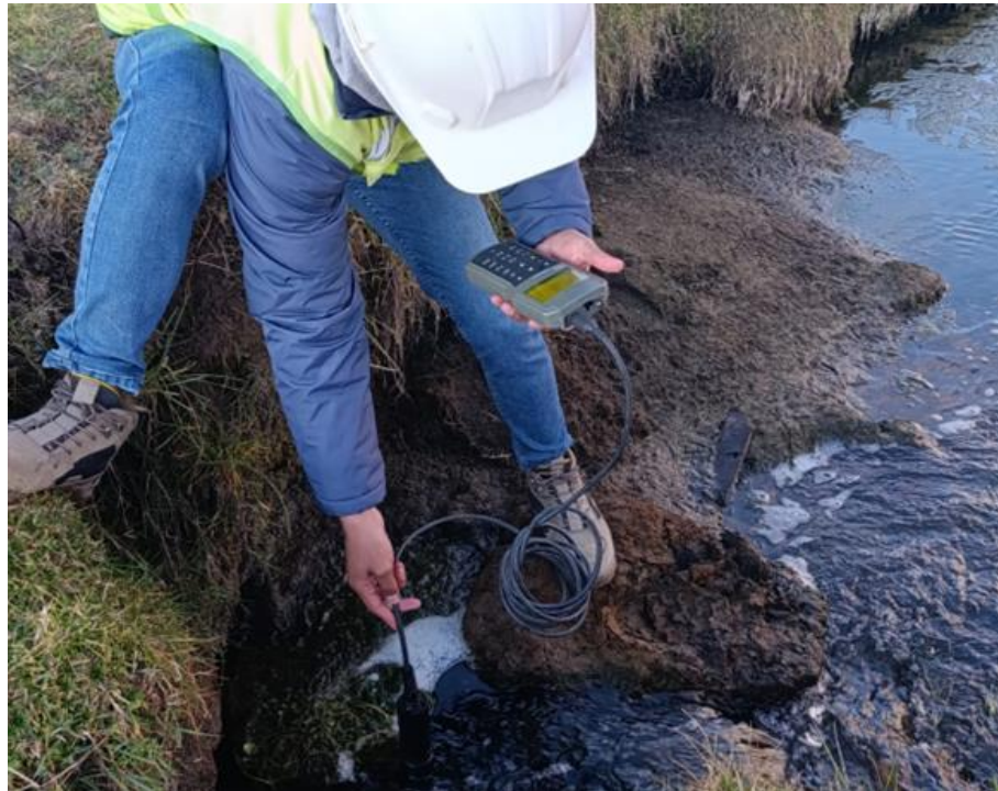
Fotografía 5: H, Medición de Parámetros Físico - Químicos In Situ del pto. PMPH-8
