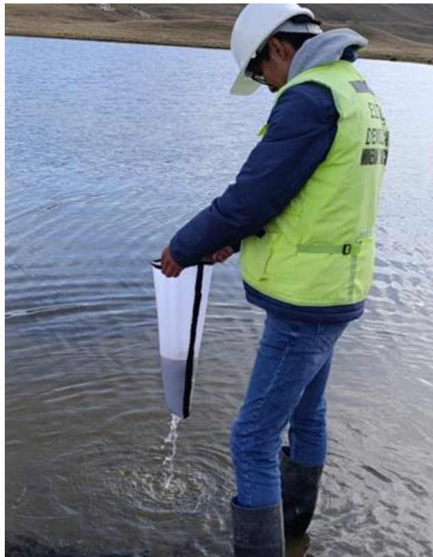
Fotografía 14: H, Toma de muestra de Plancton In Situ del pto. PMPH-11
