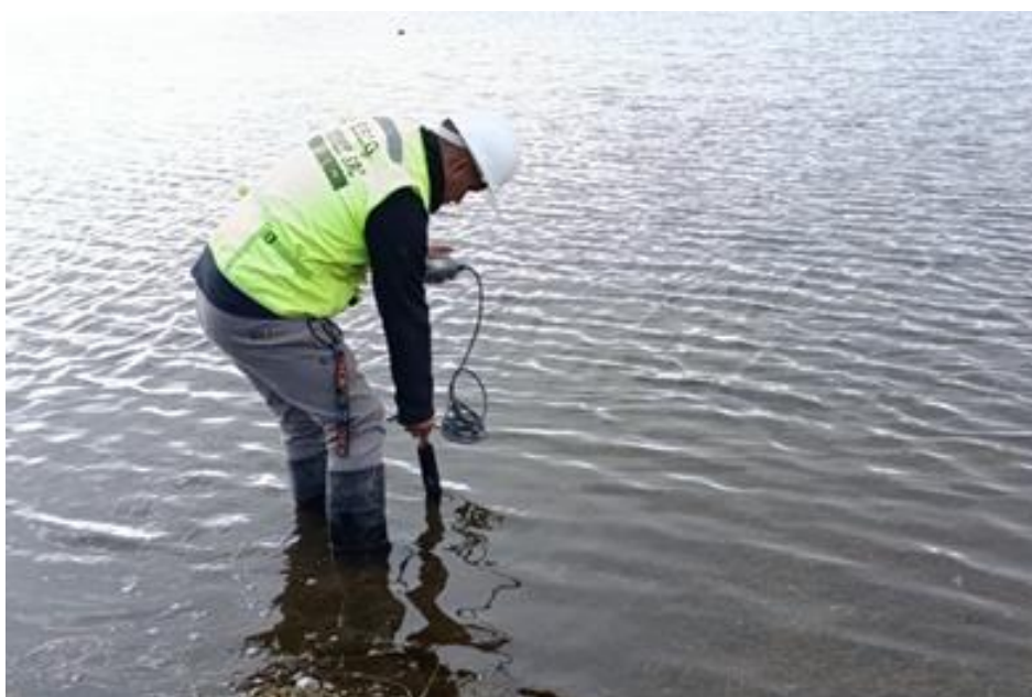
Fotografía 8: H, Medición de Parámetros Físico - Químicos In Situ del pto. PMPH-12
