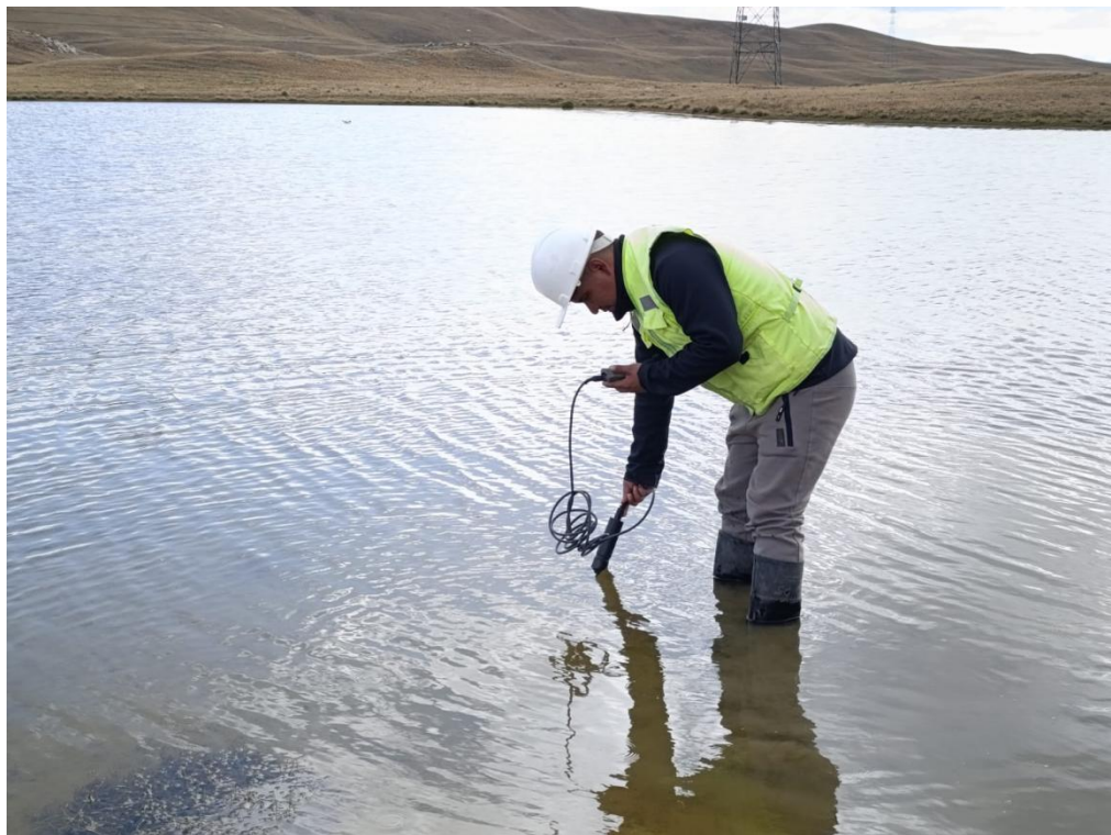
Fotografía 2: H, Medición de Parámetros Físico - Químicos In Situ del pto. PMPH-2
