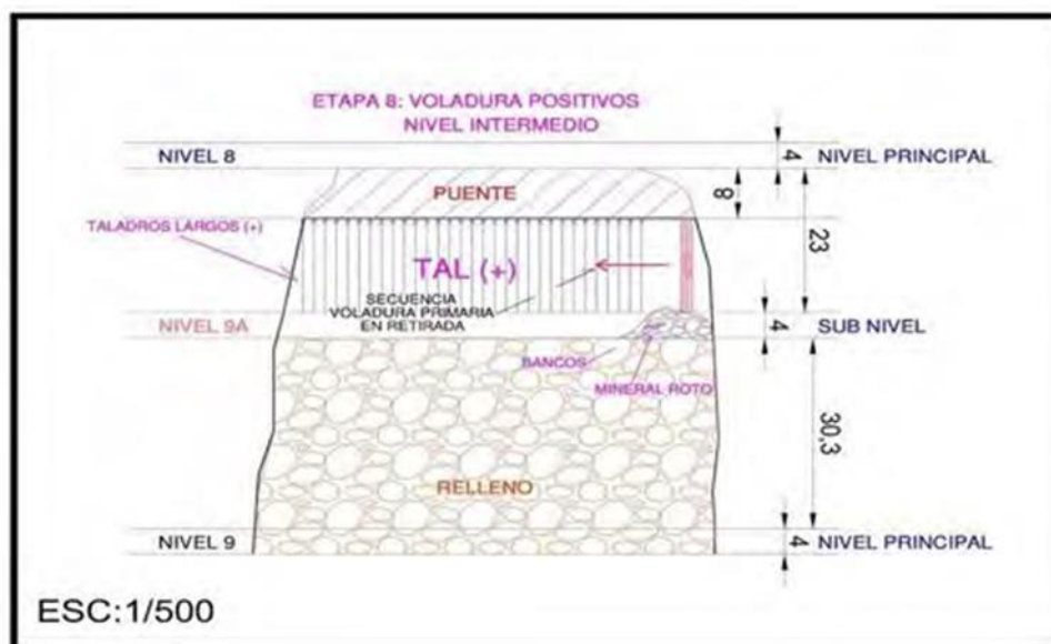
Figura 6 Estándares Método Sublevel Stopping
