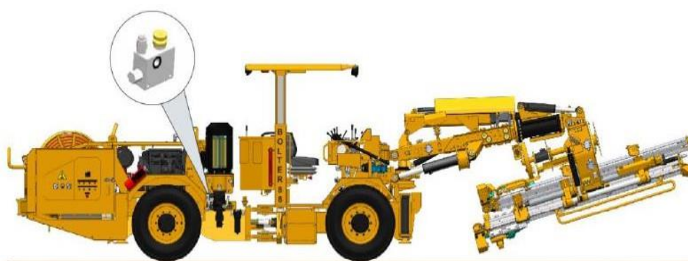
Figura 16 Ubicación de la válvula reguladora de flujo del sistema de rotación de la perforadora
