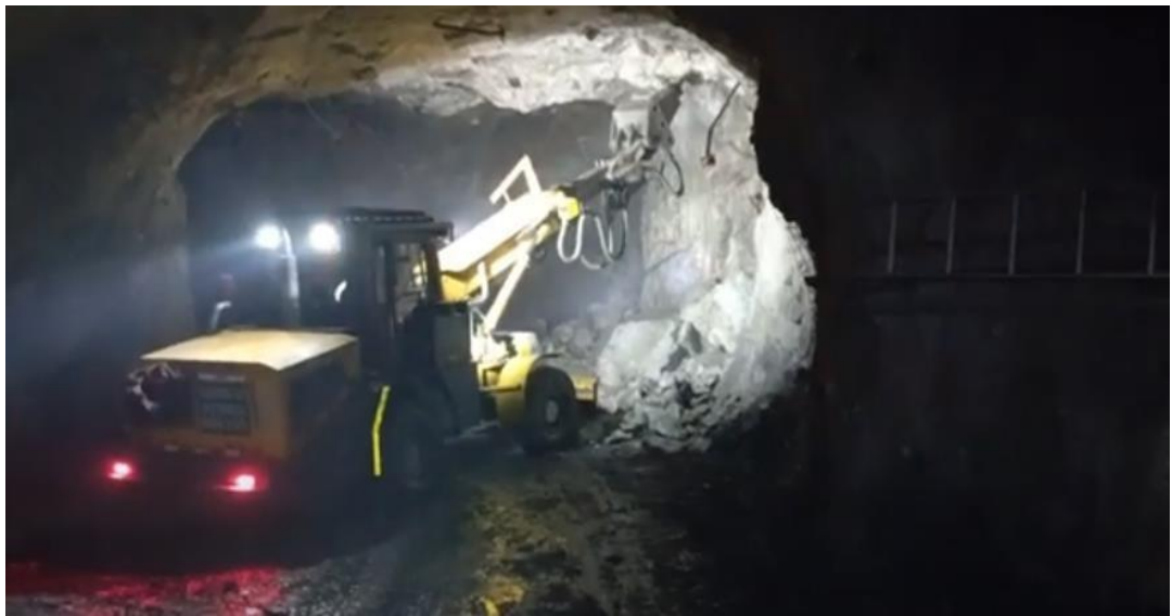
Figura 30 Desatador escales en plena operación en un tajo
