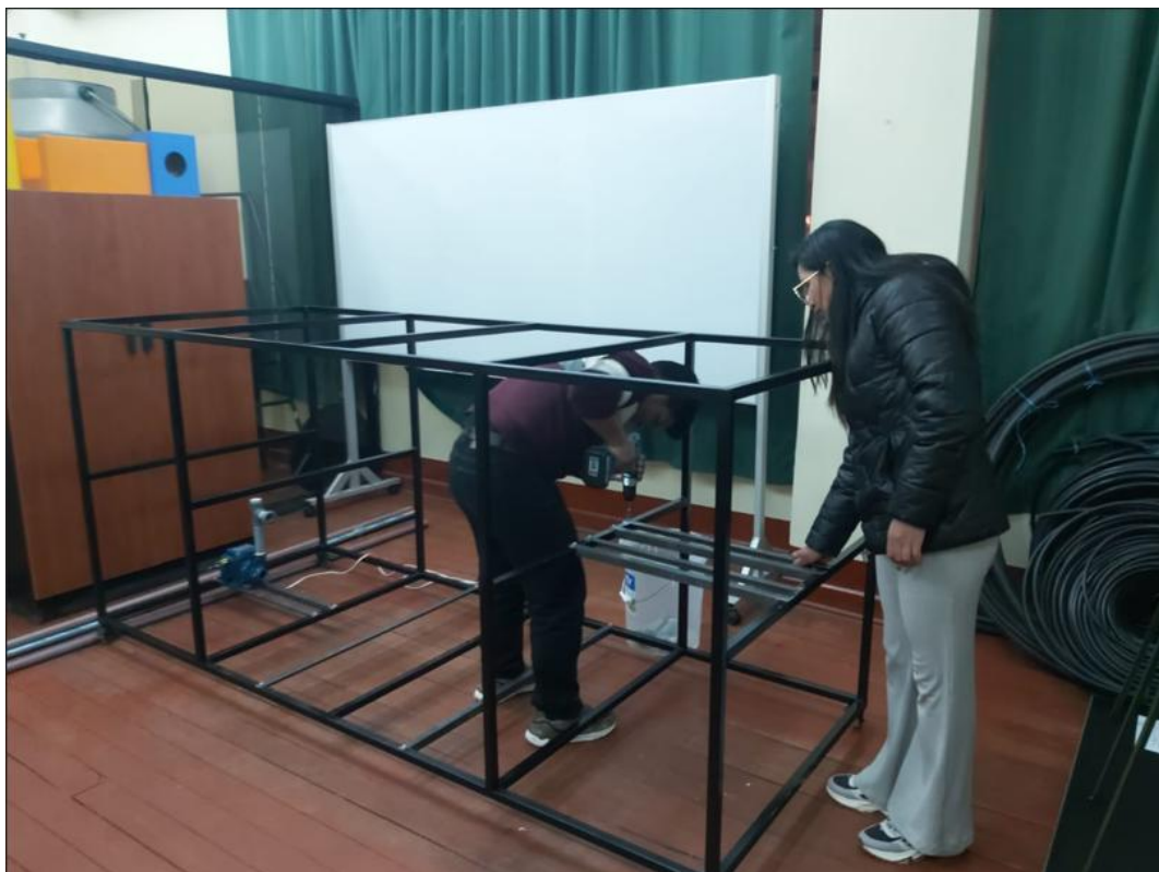
Construcción del soporte de estructura metálica del banco de pruebas
