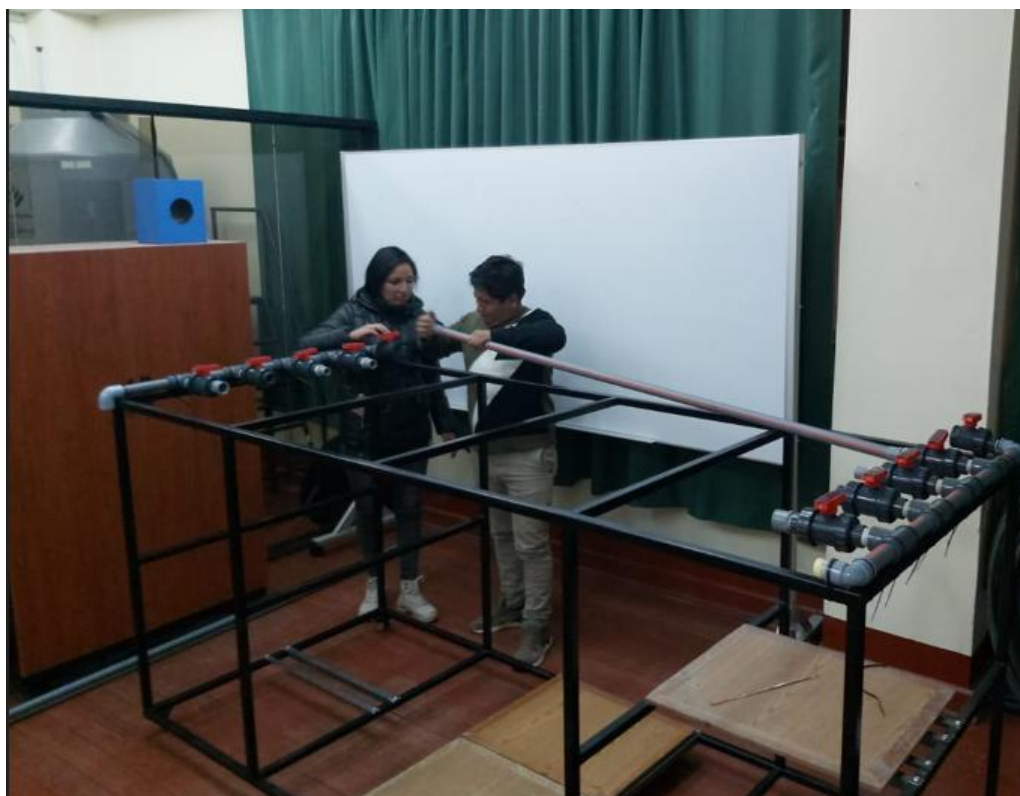
Montaje del módulo tubular en el soporte de estructura metálica
