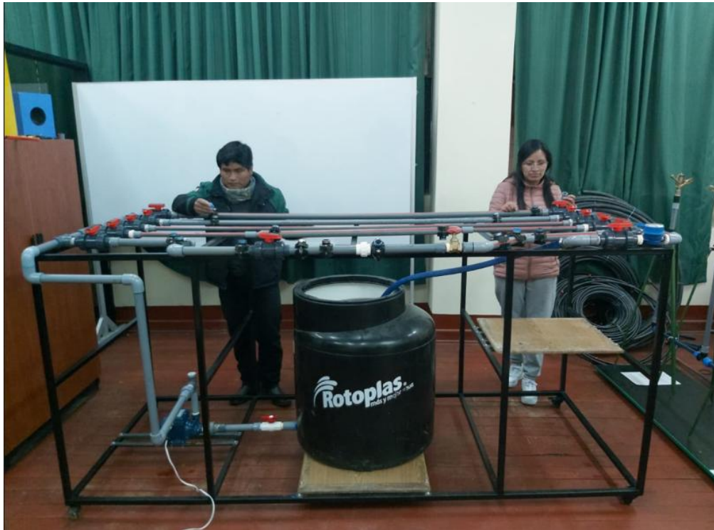
Realización de las pruebas hidráulicas. Mediciones de caudales y mediciones de presiones a la entrada y salida de las tuberías.
