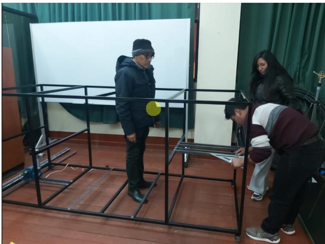
Verificando a escuadra los ángulos rectos del soporte de estructura metálica, con inspección del asesor de la investigación.
