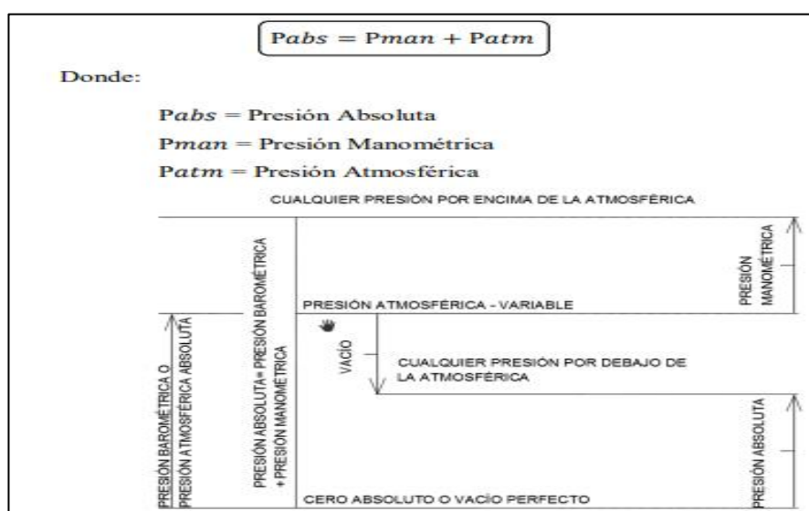
Figura 2 Relación entre las presiones manométricas y absolutas
