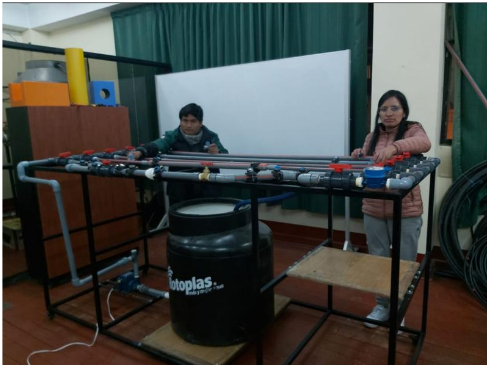
Mediciones de caudales y mediciones de presiones inmediatamente antes y después de cada accesorio materia de investigación
