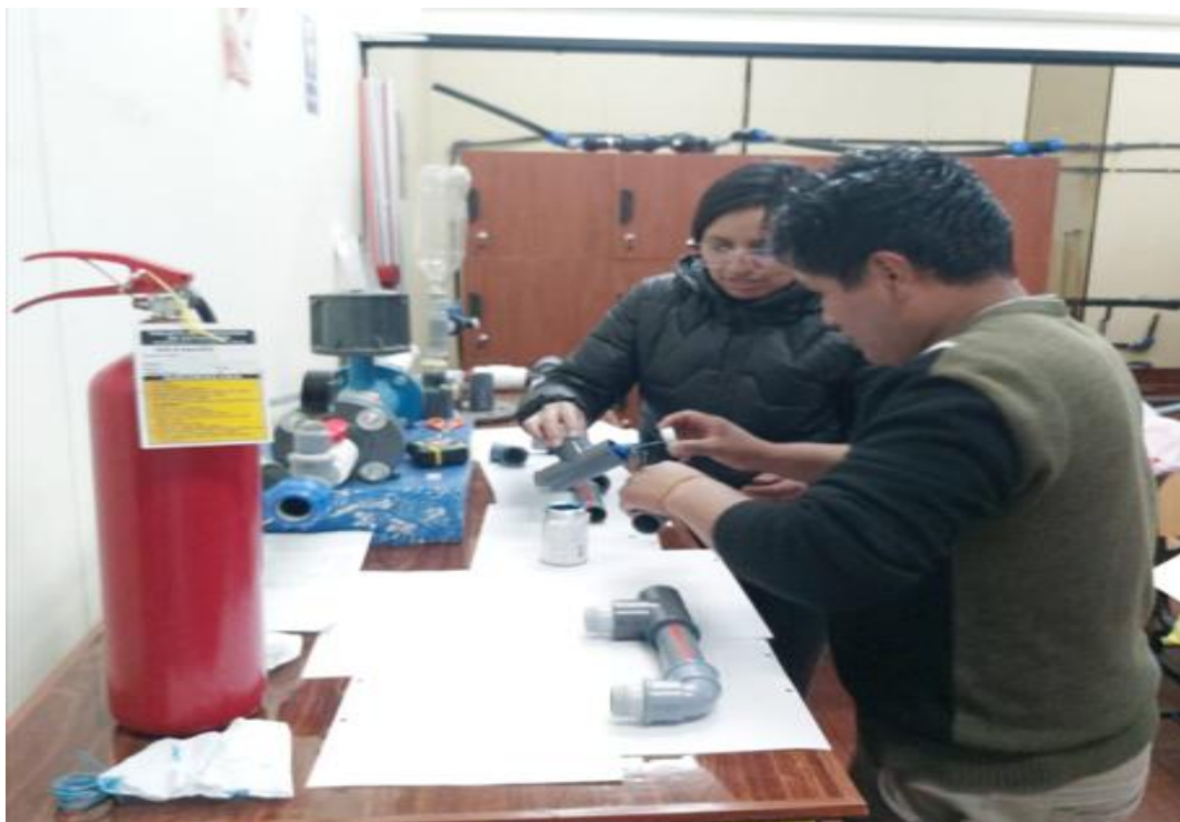
Armado de las conexiones de tuberías y accesorios del módulo tubular
