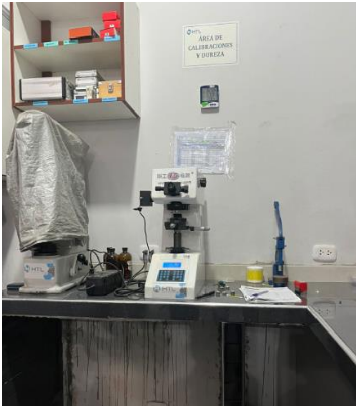
Equipo de medida de la dureza superficial
