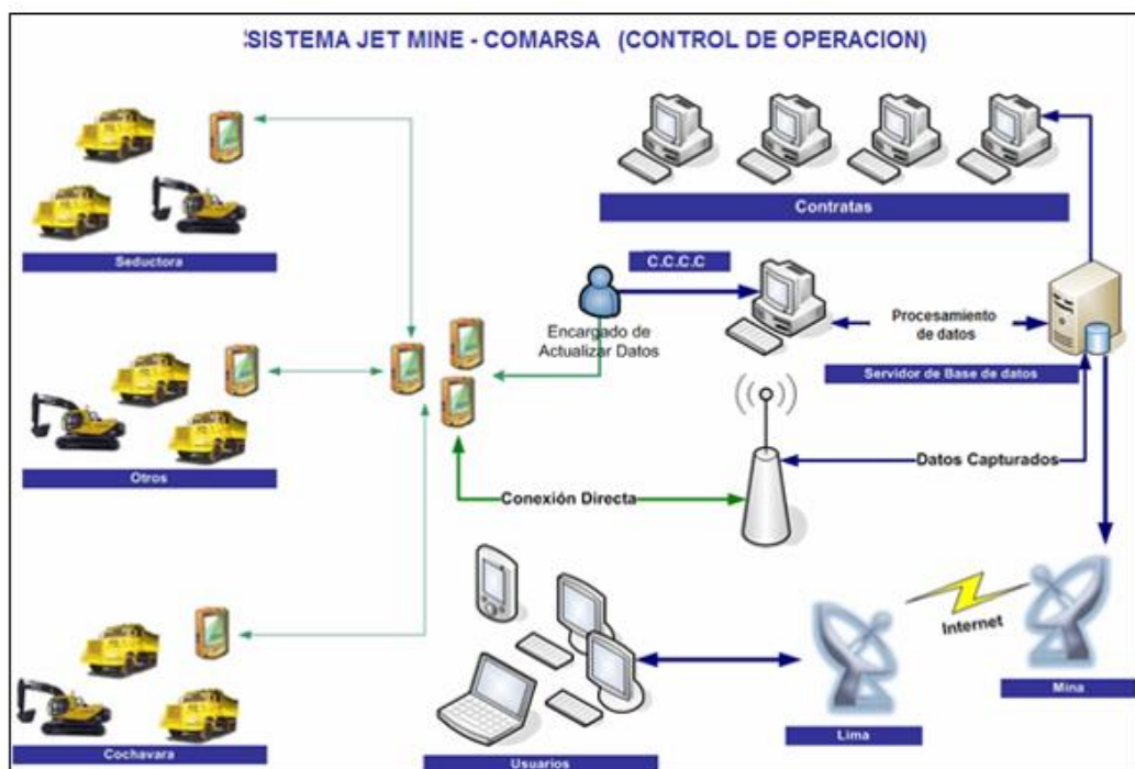
Figura 21. Sistema Jet Mine – COMARSA (Control de operaciones)
