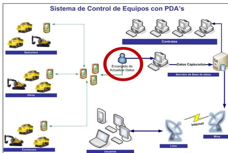
Figura 18. Sistema de control modo Batch
