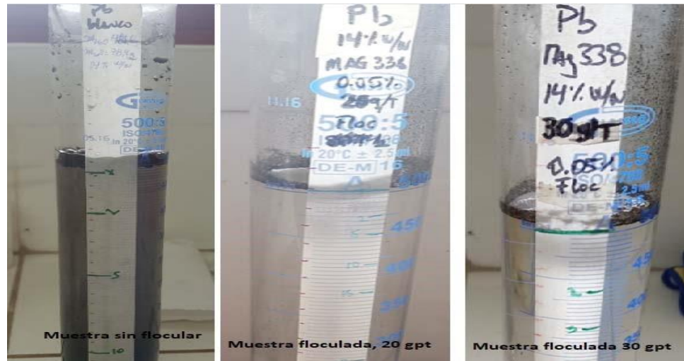
Gráfico 12 Muestra sin floculantes luego de 15 minutos de iniciada la prueba vs muestras con Floculante luego de 15 minutos de iniciada la prueba para el concentrado de Pb y diferentes consumos específicos.
