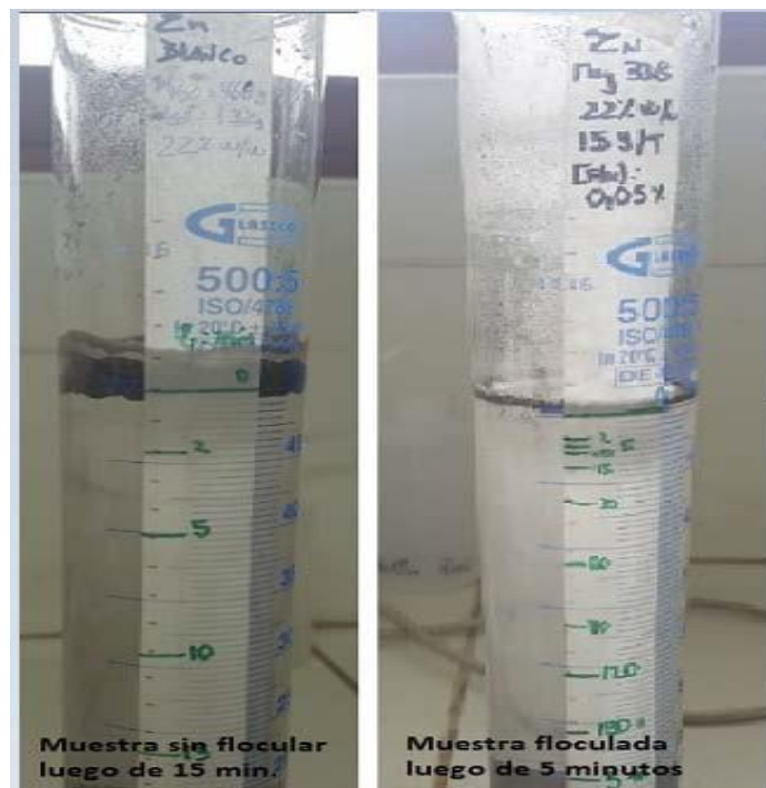
Gráfico 13 Muestra sin floculantes luego de 15 minutos de iniciada la prueba vs muestras con Floculante luego de 5 minutos de iniciada la prueba para el concentrado de Zn.
