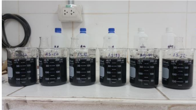
Gráfico 8 Pruebas de sedimentación en vasos de precipitado
