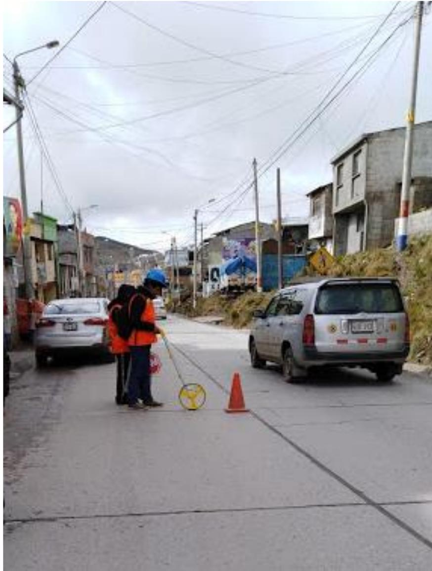
*Figura IV.6 Inspector tomando las medidas del contorno de la unidad de muestreo con ayuda de Odómetro.*
