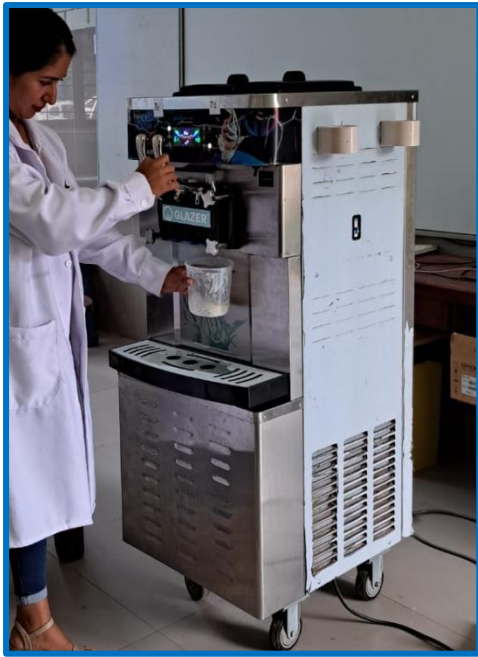
Imagen 20. Proceso de congelación rápida de helado en equipo soft.
