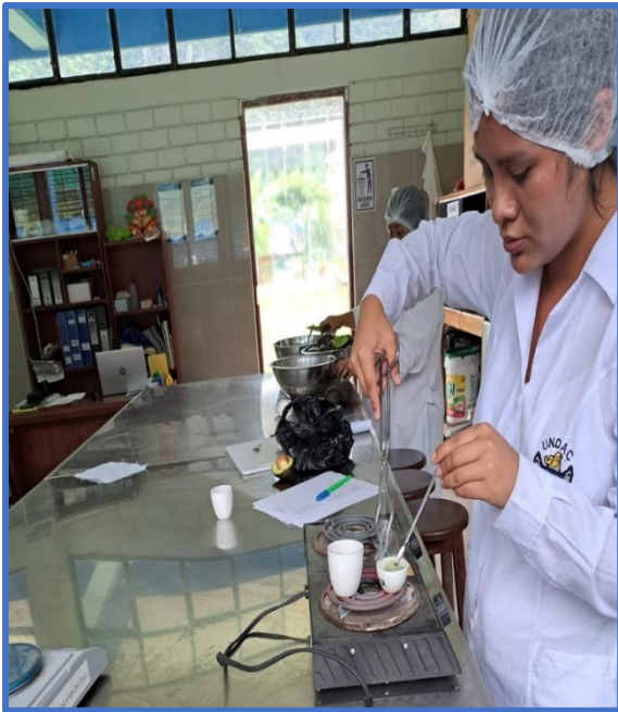
Imagen 16. Muestras de palta en hornilla eléctrica para análisis de cenizas.
