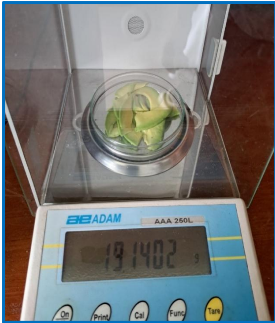
Imagen 9. Medición de peso de muestra de palta para análisis de humedad.
