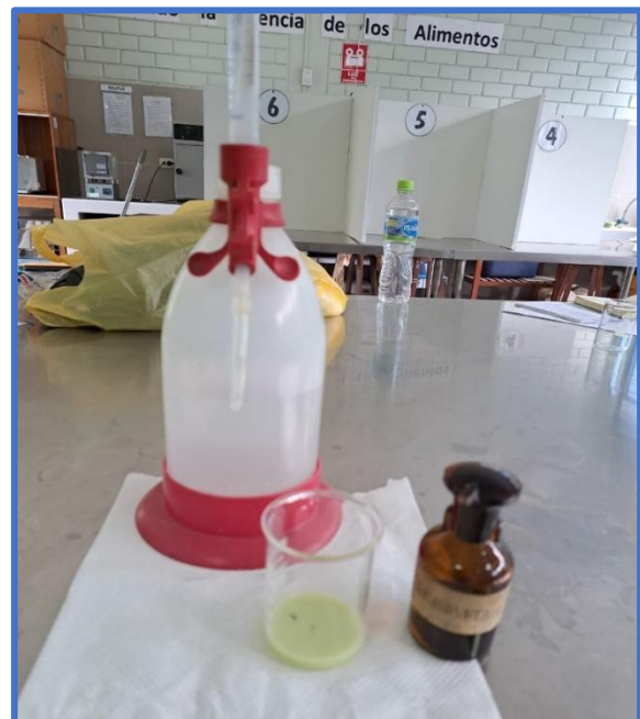
Imagen 19. Análisis de acidez en pulpa de palta mediante titulación.
