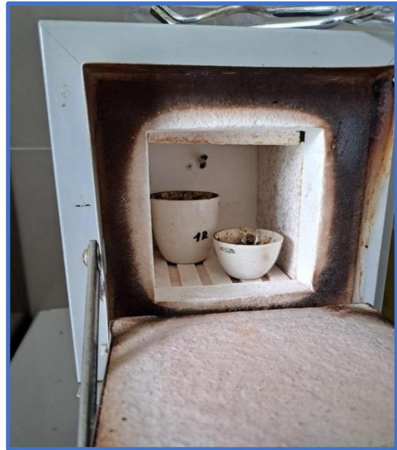
Imagen 17. Muestras de palta sometidas a tratamiento térmico en mufla.
