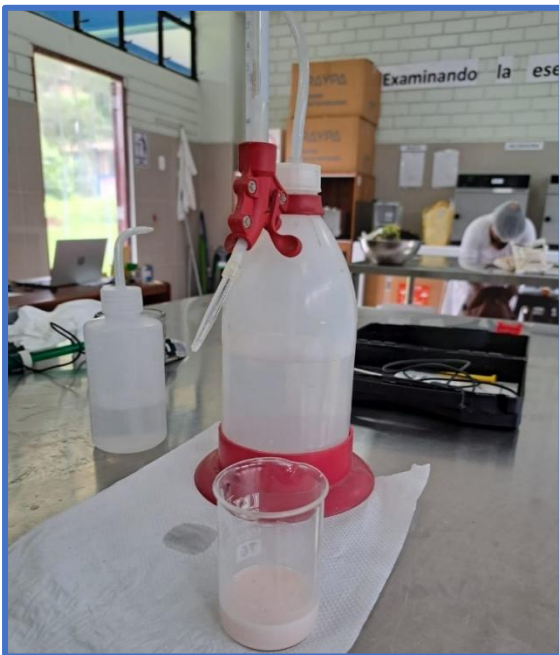
Imagen 18. Procedimiento de titulación para determinación de acidez en crema de leche.
