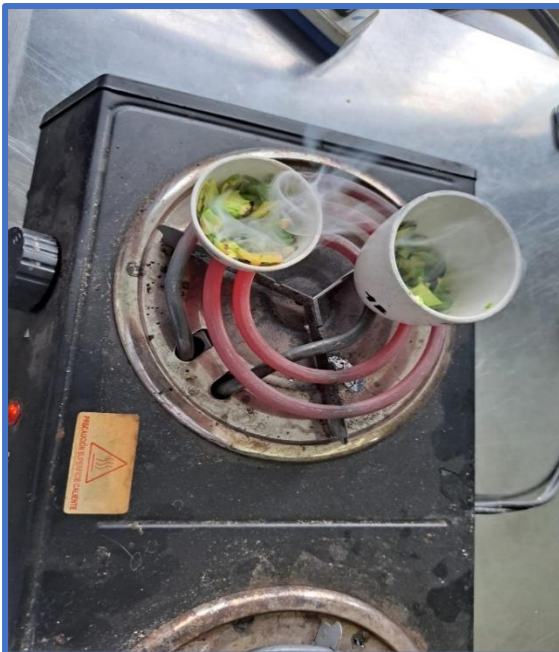
Imagen 15. Muestra de palta sometida a tratamiento térmico en hornilla para análisis de cenizas.
