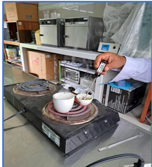
Imagen 15. Muestra de palta sometida a tratamiento térmico en hornilla para análisis de cenizas.
