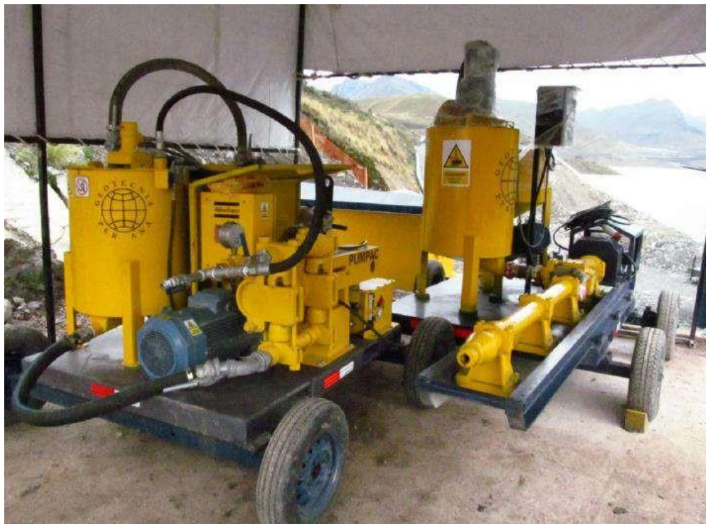
Figura 23. Plataforma de inyección propiedad de Geotecnia Peruana utilizada en la Central No. 1
