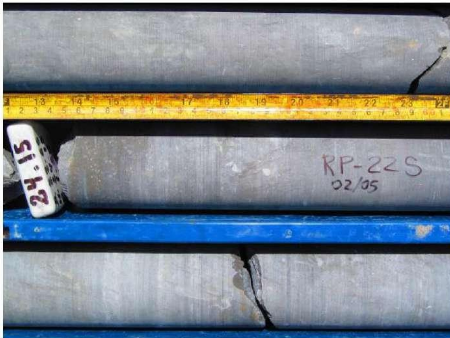
Figura 46. Testigo del taladro RP-S 22 que ilustra la condición de roca inalterada
