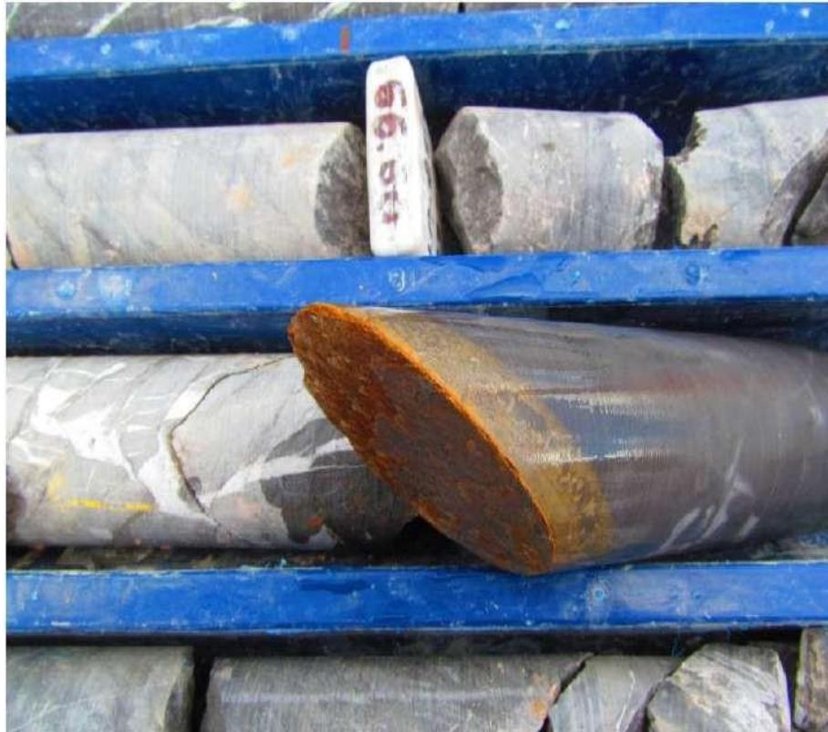
Figura 41. Fractura planar ubicada a 67.50 m que fue objeto de la inyección del tramo 65 a 75 m
