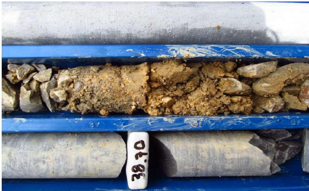
Figura 30. Detalle de la estructura kárstica con relleno limoso ubicada entre los 37.67 y 37.98
