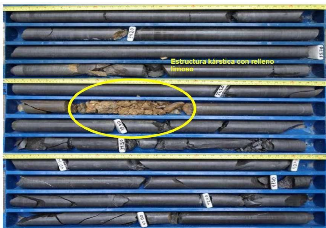
Figura 29. El testigo del tramo 33-43 m muestra una buena calidad física de la roca caliza
