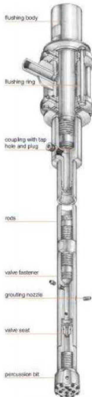
Figura 8. Esquema de varillaje con broca de percusión. Boart Longyear
