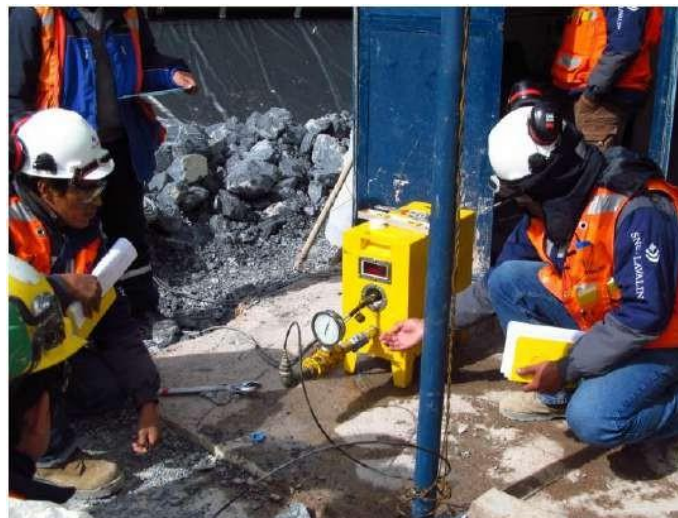
Figura 21. Equipo registrador en proceso de verificación de la calibración presión/caudal
