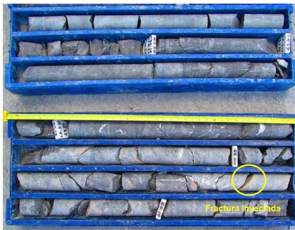
Figura 40. Testigo de roca afectado por fracturas inducidas por el torque de la máquina
