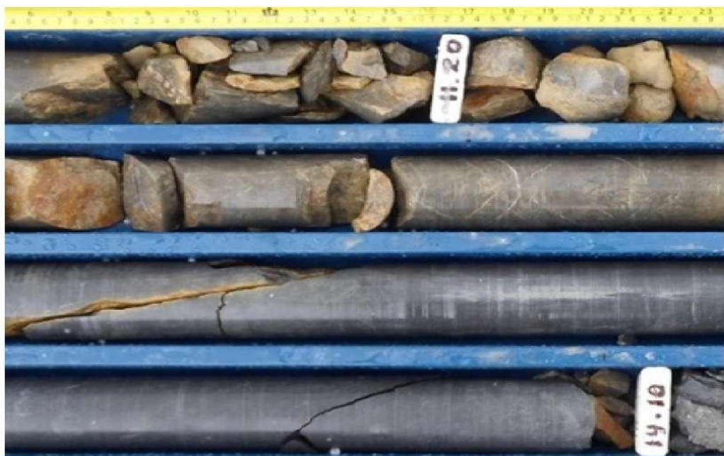
Figura 36. Fracturamiento con intemperismo fuerte típico de la zona superficial del taladro LP-P32
