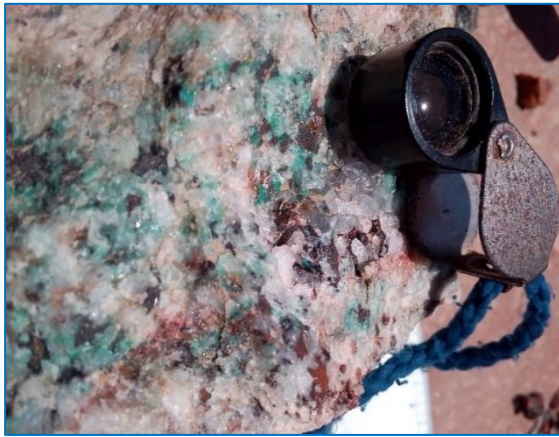
Figura 21 Textura Tipo Isla de Calcosina en Calcopirita (Remplazamiento Parcial)
