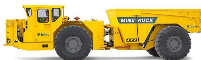
Figura 12 Equipo de acarreo Dámper capacidad 20 ton (Fuente: Atlas Copco)
