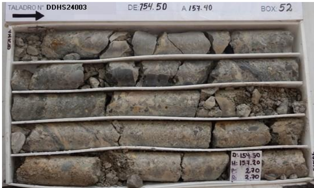
Fotografía 10 Testigos de 154.50m a 157.40m
