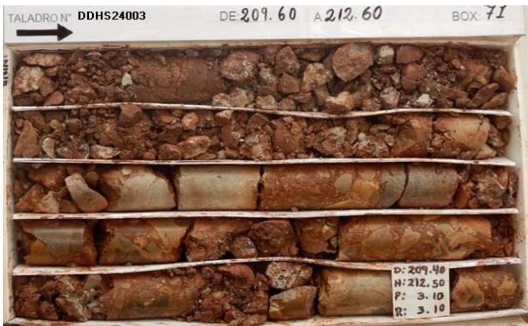
Fotografía 11 Testigos de 209.60m a 212.60m
