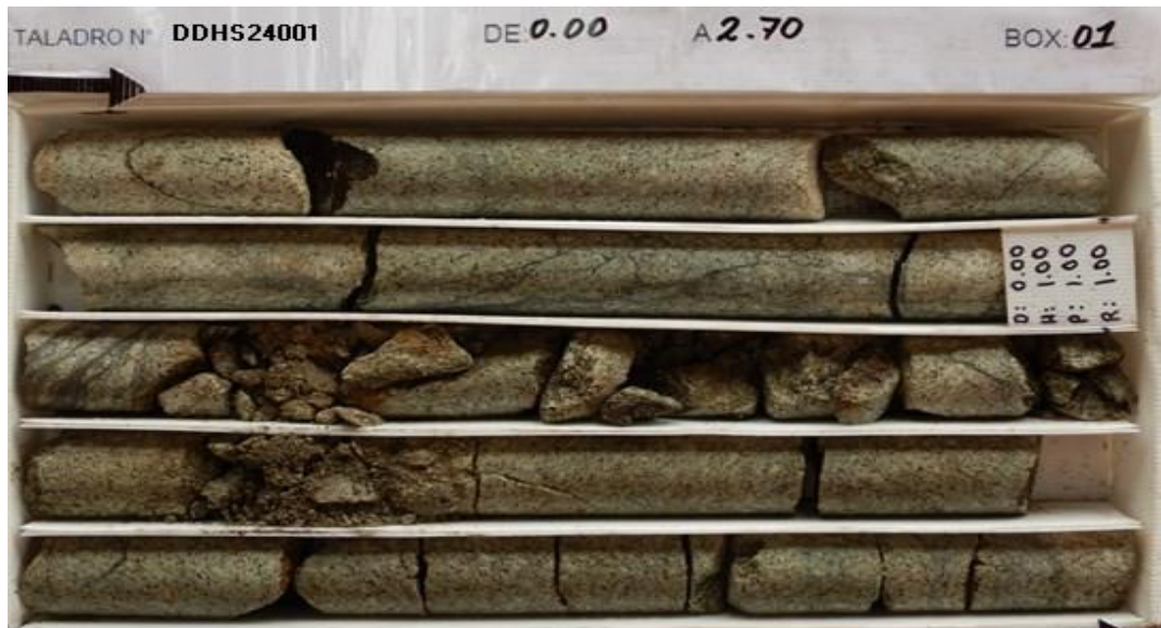
Fotografía 8 Testigos de 0.00m a 2.70m.
