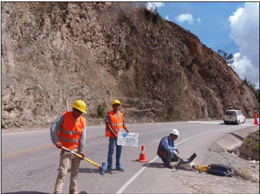
Foto 23. Realización de ensayo MASW-08. Puente Cachimayo.
