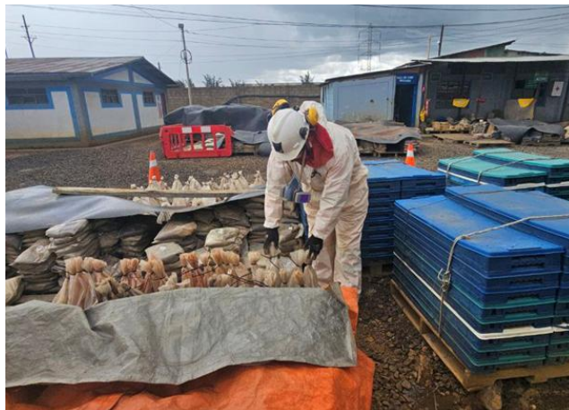
Figura 41 Muestras de los Blast Hole para su preparación
