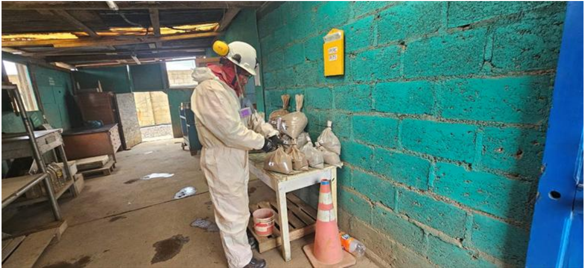
Figura 44 Se divide en 20 kg para metalúrgica y 5kg para analítica y se asegura con precinto
