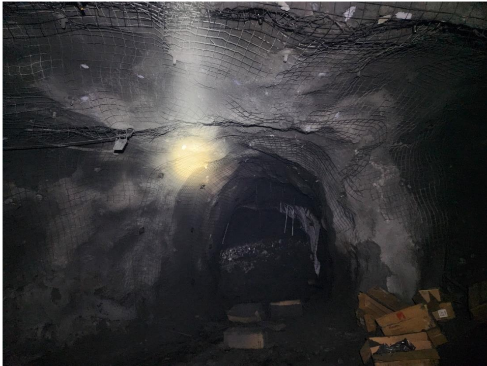
Ventana de explotación en proceso de minado por el método de Sub Level Caving (V_0); al piso se observa el mineral.
