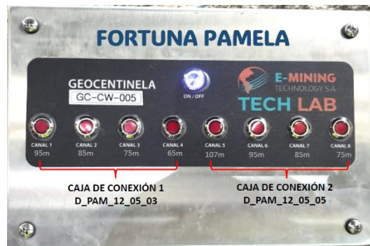
Figura 67. Diagrama del sistema de instrumentación con representación LED, del sistema geocentinela.
