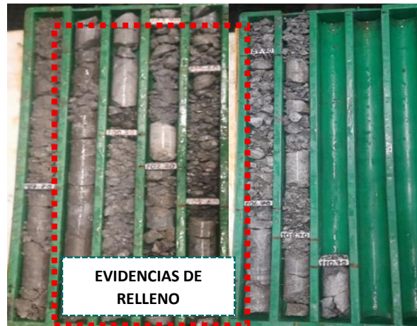
Figura 41. Cambio notorio en la coloración entre una roca fresca y con evidencia de relleno producto del caving.
