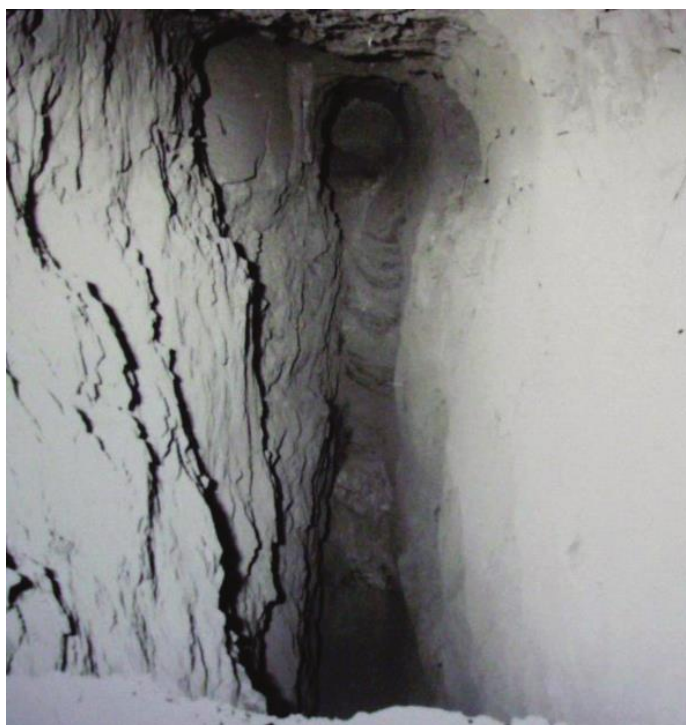
Figura 18. Representación gráfica del método de minado SLS, parte superior de la fotografía, subnivel superior; parte inferior de la fotografía (sub nivel inferior)
