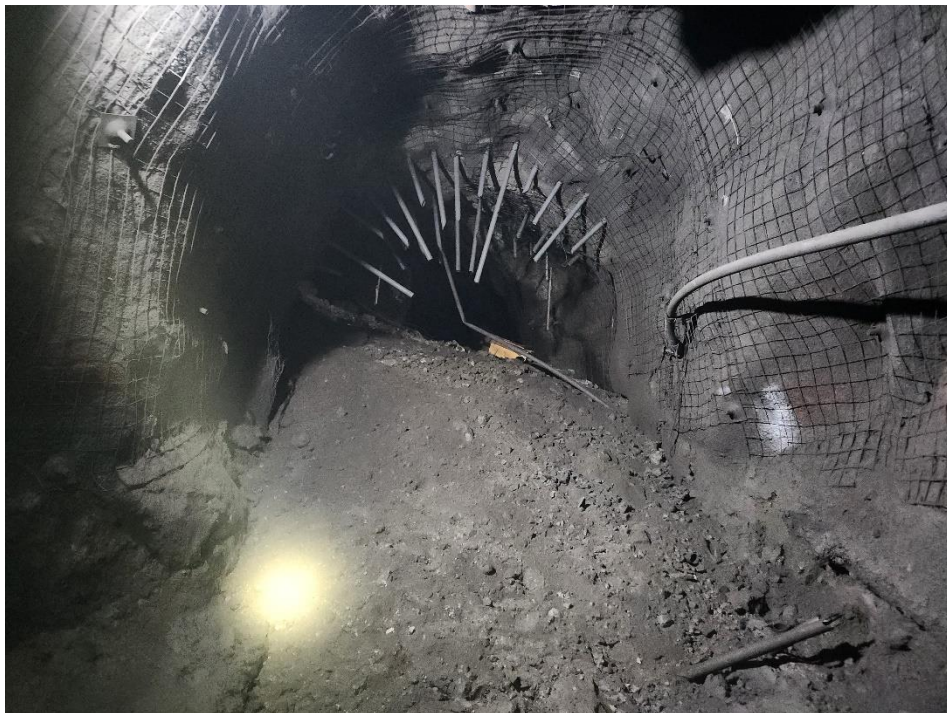
Ventana de explotación en proceso de minado por el método de Sub Level Caving (V_0); al piso se observa el mineral.
