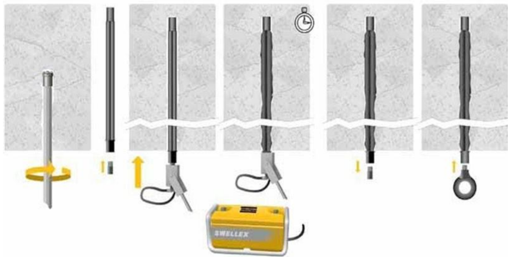
Figura 3 Esquema del anclaje Swellex.
