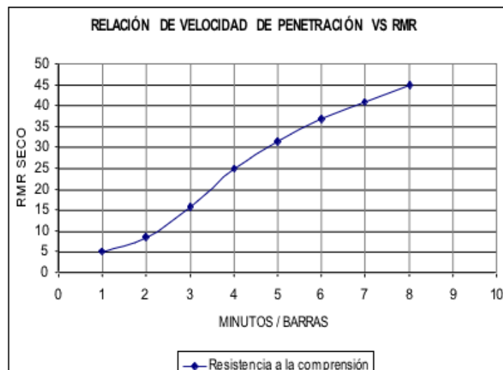
Figura 15. Relación de velocidad de penetración vs RMR
