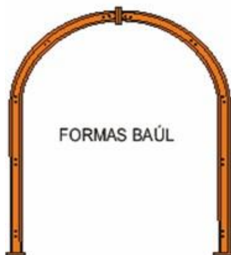
Figura 14. Cimbra 3.5m x 3.0m utilizada en las Ventanas
